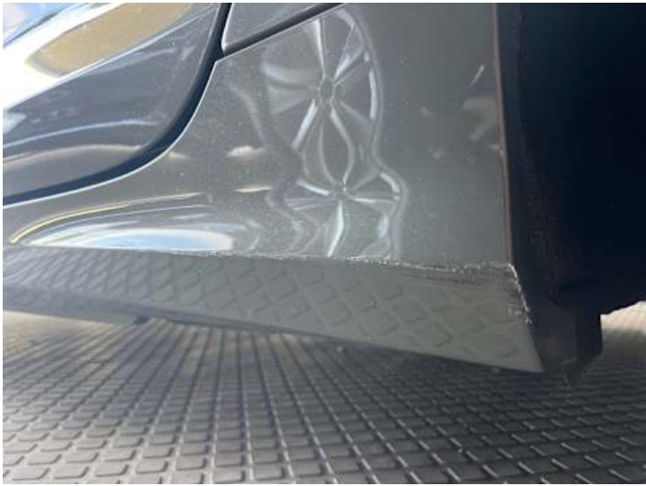
Schweller links (Lackschaden, Kratzer)
