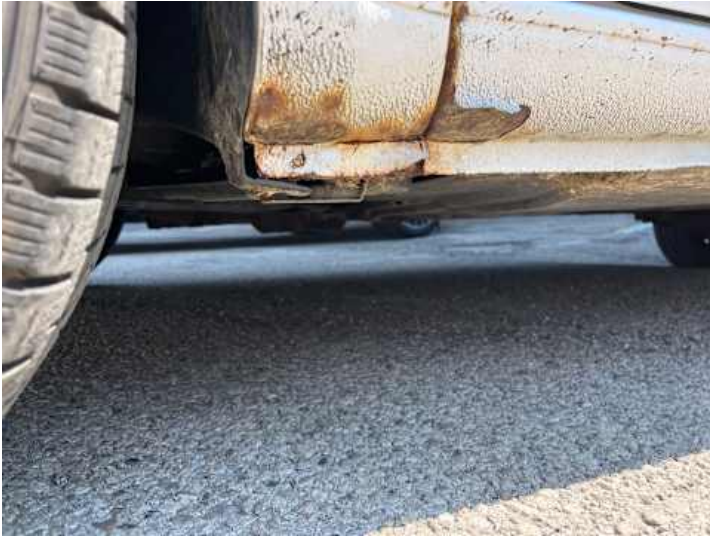
Kotflügel vorne links (Rost)
