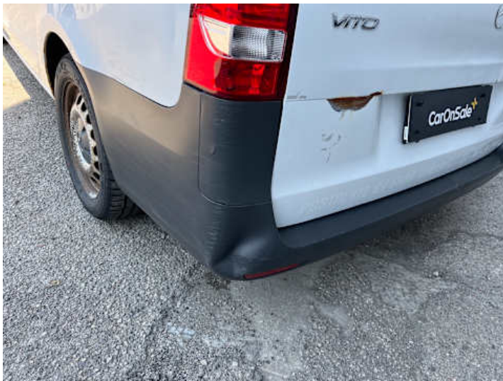
Stoßstange hinten (Kratzer, Delle, Spaltmaße ungenau)
