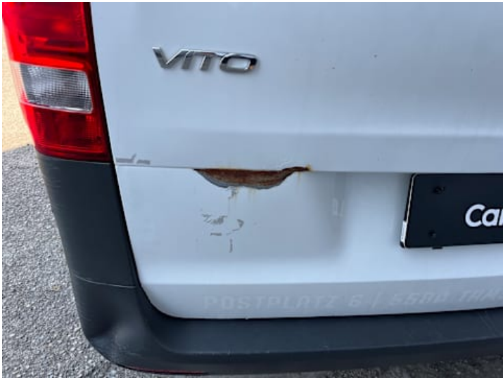
Heckklappe (Delle, Kratzer, Lackschaden)
