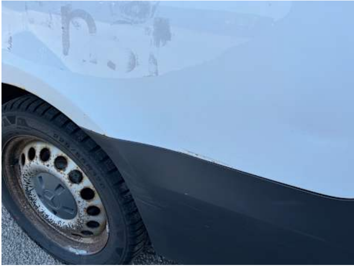
Seitenteil hinten links (Rost, Delle, Kratzer)
