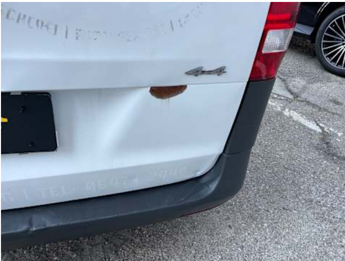
Heckklappe (Delle, Kratzer, Lackschaden)
