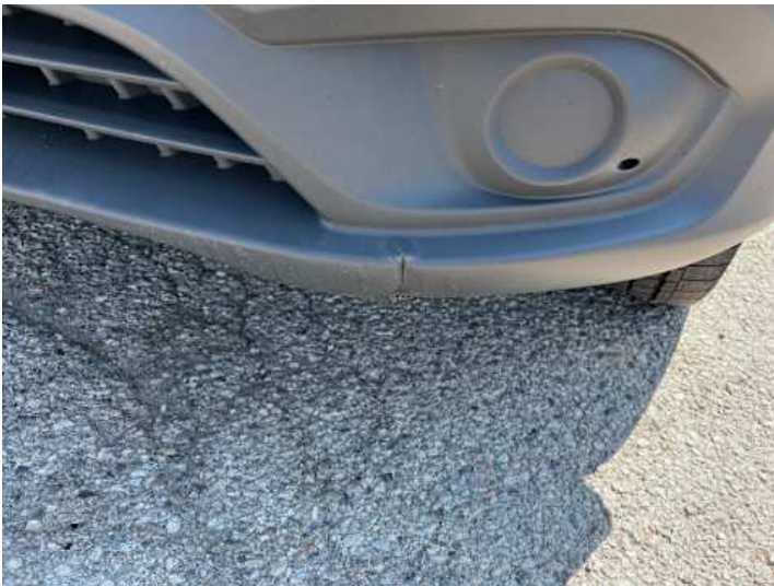
Stoßstange vorne (Riss/Bruch)
