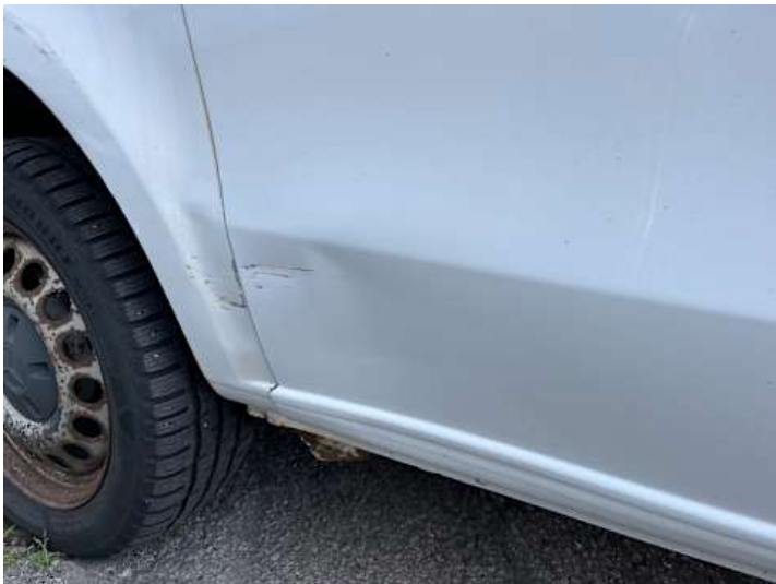
Türe hinten rechts (Kratzer, Delle, Rost)
