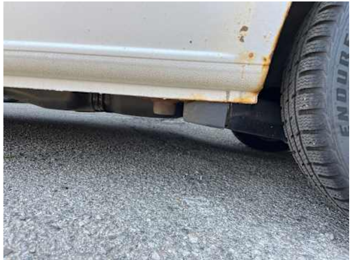
Schweller links (Rost, Kratzer)
