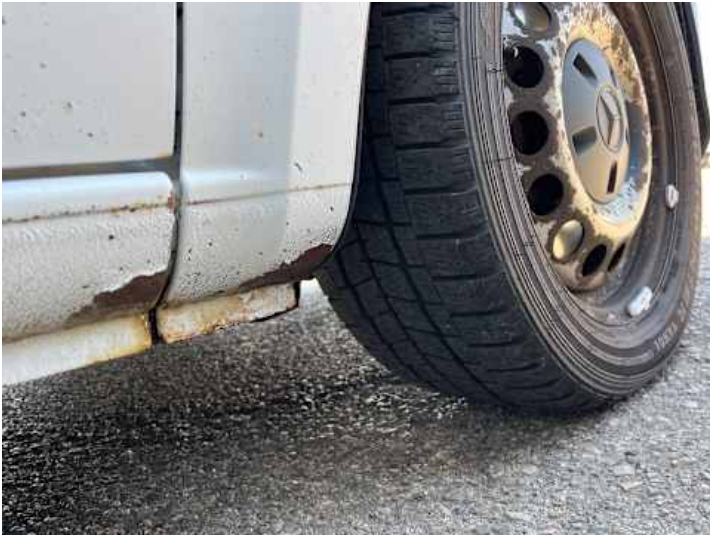
Kotflügel vorne rechts (Rost)
