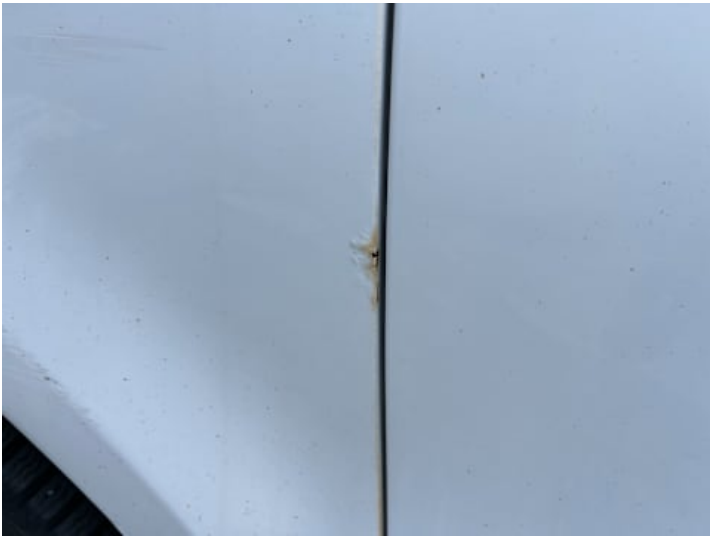
Seitenteil hinten rechts (Delle, Kratzer, Rost)
