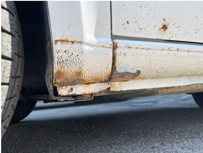
Schweller links (Rost, Kratzer)
