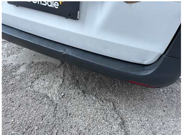
Stoßstange hinten (Kratzer, Delle, Spaltmaße ungenau)
