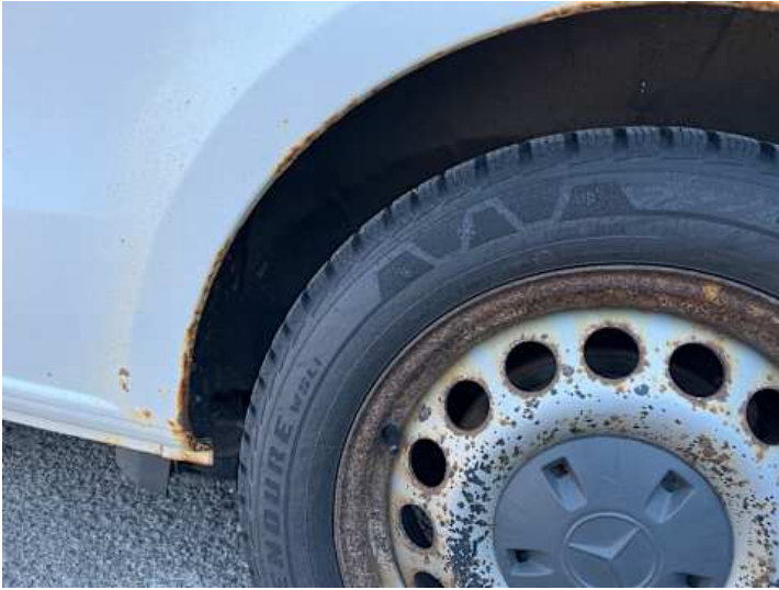
Seitenteil hinten links (Rost, Delle, Kratzer)
