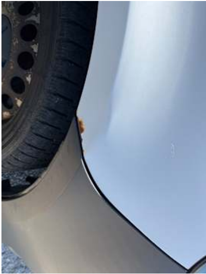
Kotflügel vorne rechts (Rost, Kratzer)
