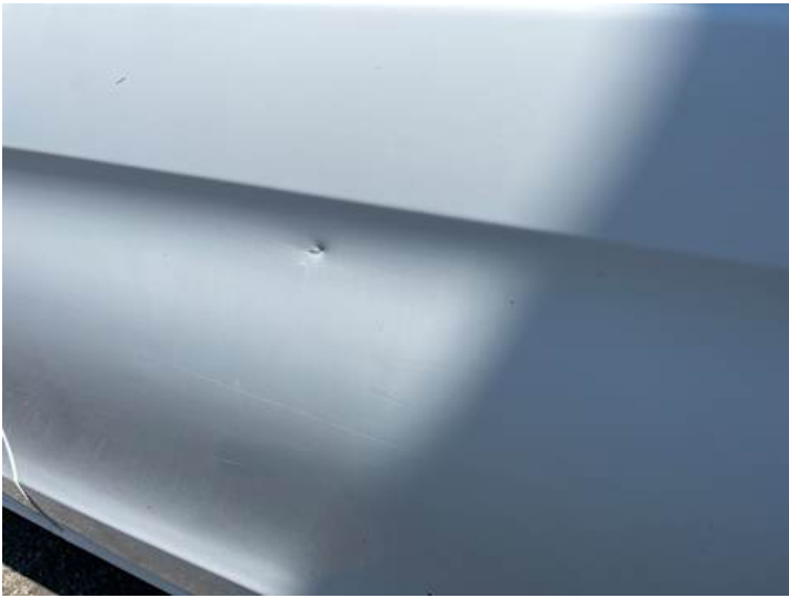
Seitenteil hinten links (Rost, Delle, Kratzer)
