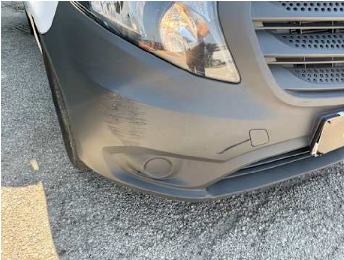
Stoßstange vorne (Riss/Bruch)
