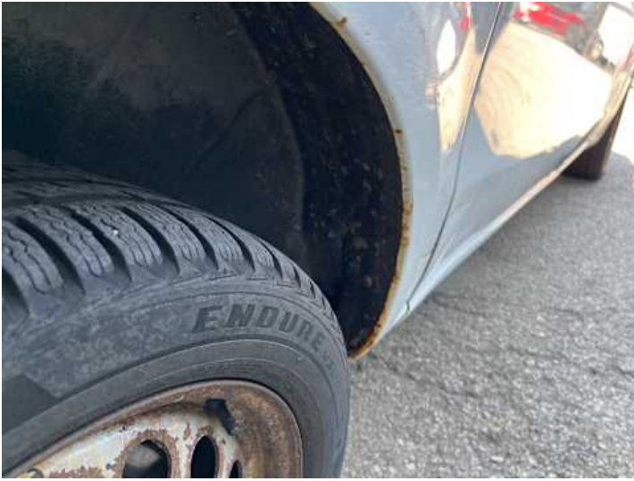
Seitenteil hinten rechts (Delle, Kratzer, Rost)
