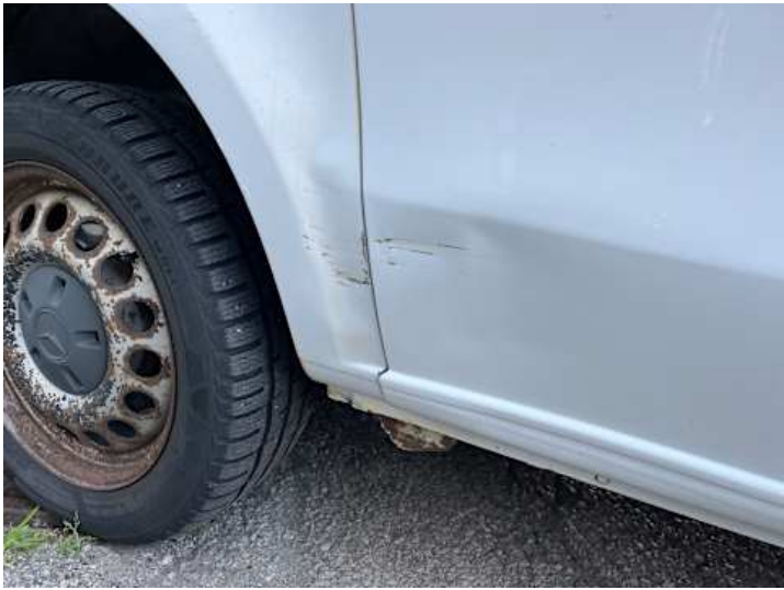
Seitenteil hinten rechts (Delle, Kratzer, Rost)
