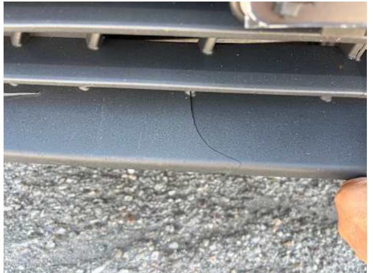
Stoßstange vorne (Riss/Bruch)
