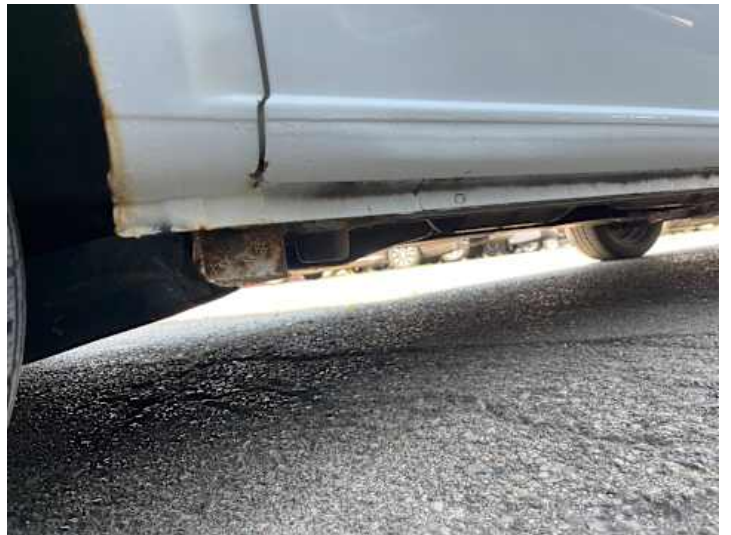
Schweller rechts (Rost)
