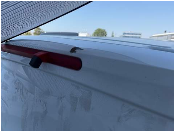
Heckklappe (Delle, Kratzer, Lackschaden)
