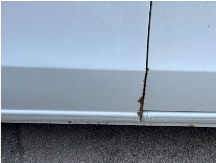
Türe hinten rechts (Kratzer, Delle, Rost)
