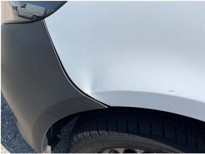
Kotflügel vorne links (Rost, Delle)
