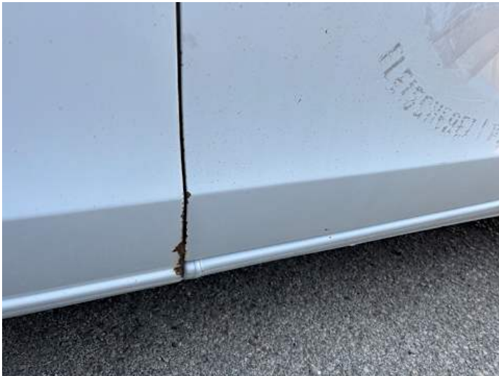
Beifahrertür (Kratzer, Rost)
