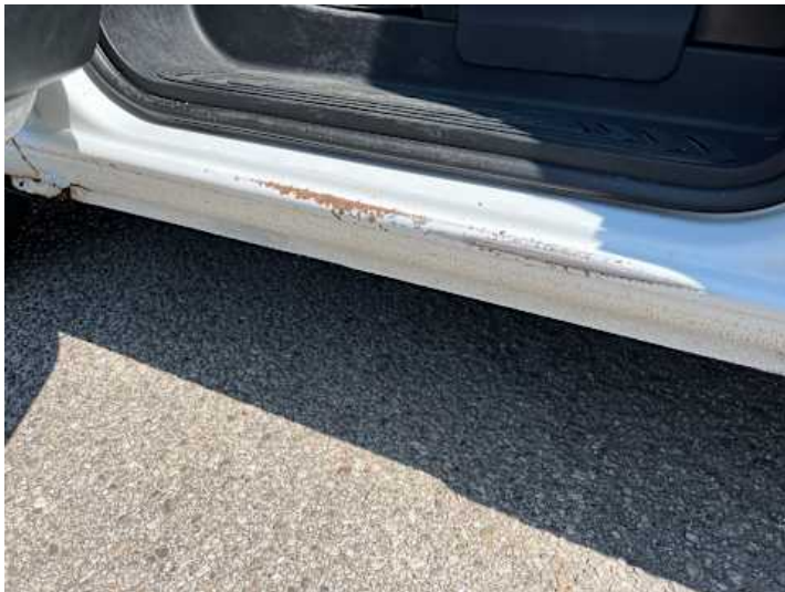
Schweller links (Rost, Kratzer)
