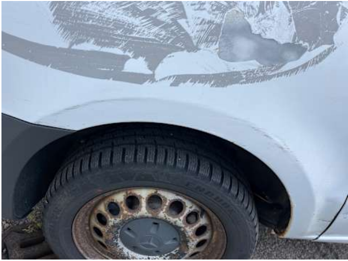
Seitenteil hinten rechts (Delle, Kratzer, Rost)
