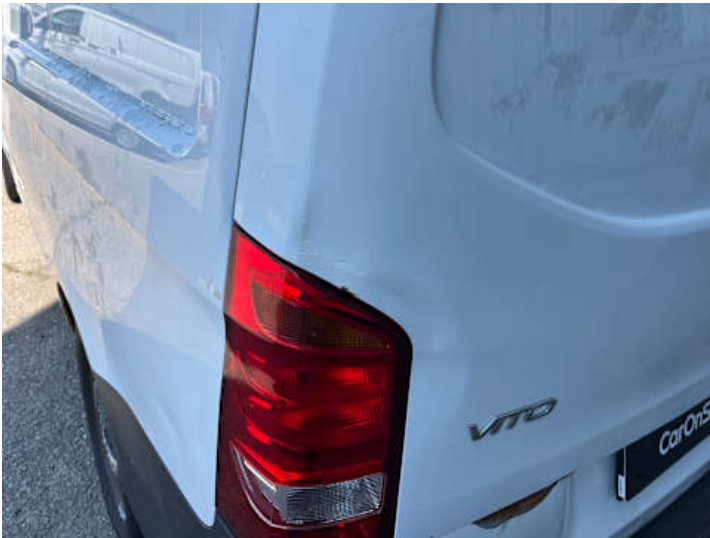
Heckklappe (Delle, Kratzer, Lackschaden)
