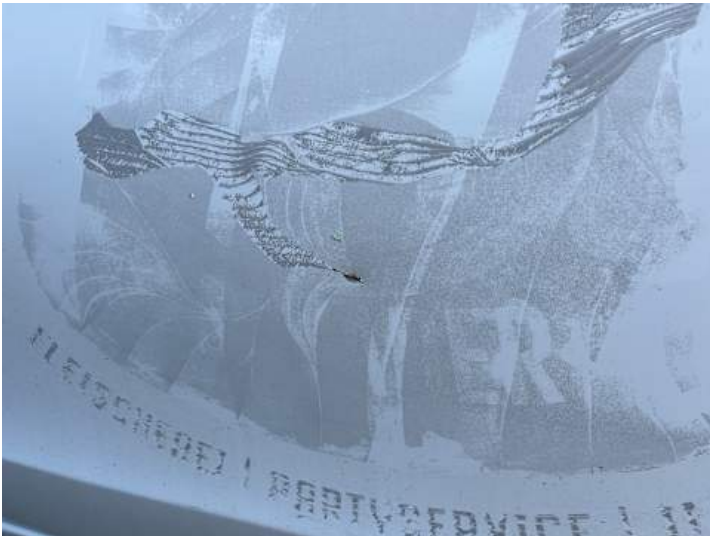
Beifahrertür (Kratzer, Rost)
