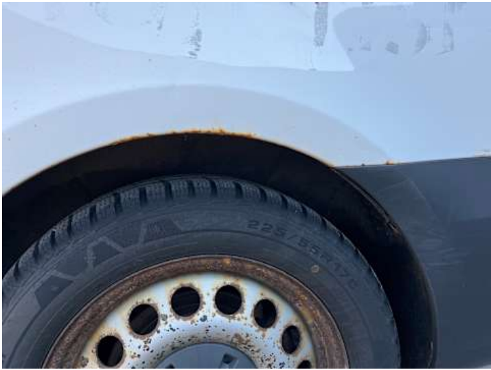
Seitenteil hinten links (Rost, Delle, Kratzer)
