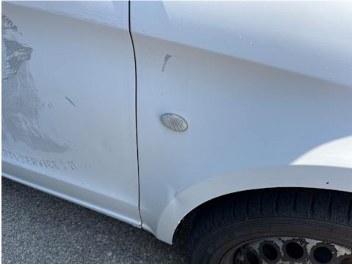
Kotflügel vorne rechts (Delle, Kratzer)
