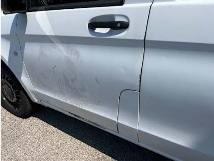
Fahrtür (Kratzer, Lackschaden)
