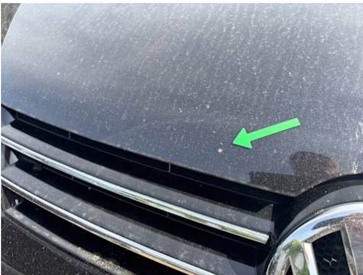
Motorhaube (Rost, Steinschlag)
