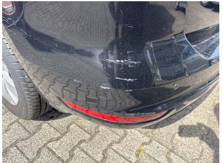
Stoßstange hinten (Lackschaden)
