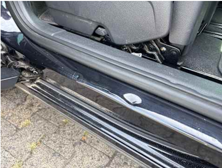
Schweller rechts (Delle)
