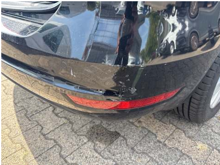
Stoßstange hinten (Lackschaden, Verformung)
