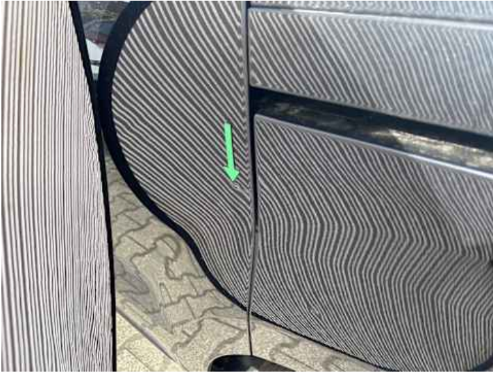
Türe hinten links (Delle, Kratzer)
