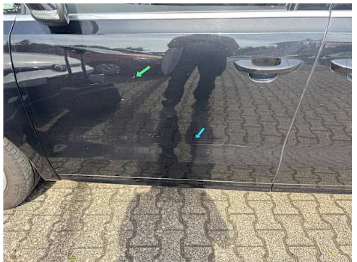
Fahrtür (Delle, Kratzer)
