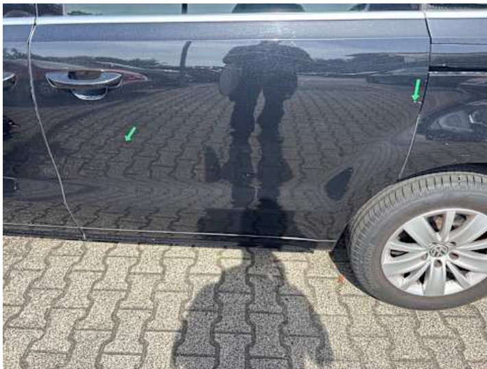
Türe hinten links (Delle, Kratzer)
