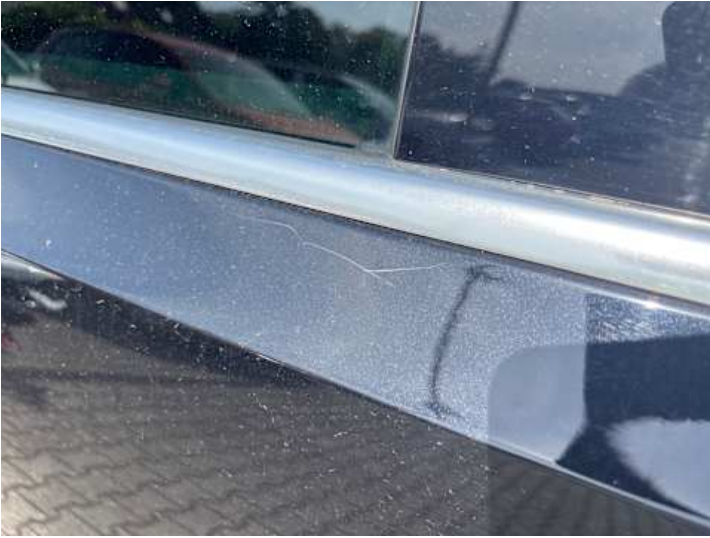
Türe hinten links (Delle, Kratzer)
