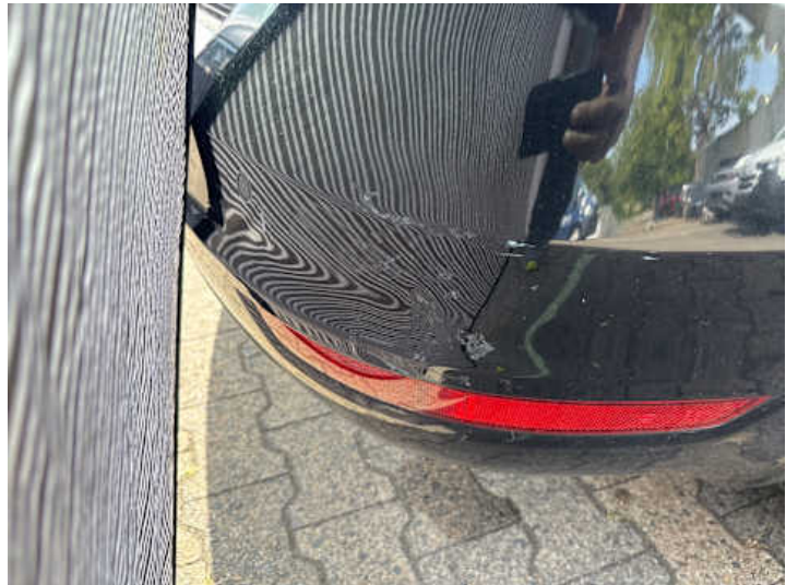
Stoßstange hinten (Lackschaden, Verformung)
