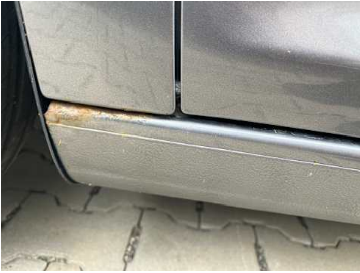
Schweller links (Rost)
