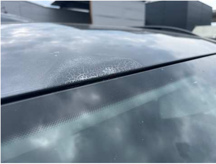
Dach (Lackschaden, Rost)
