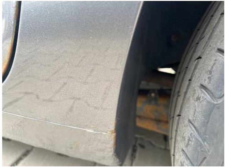
Seitenteil hinten links (Rost, Lackschaden)
