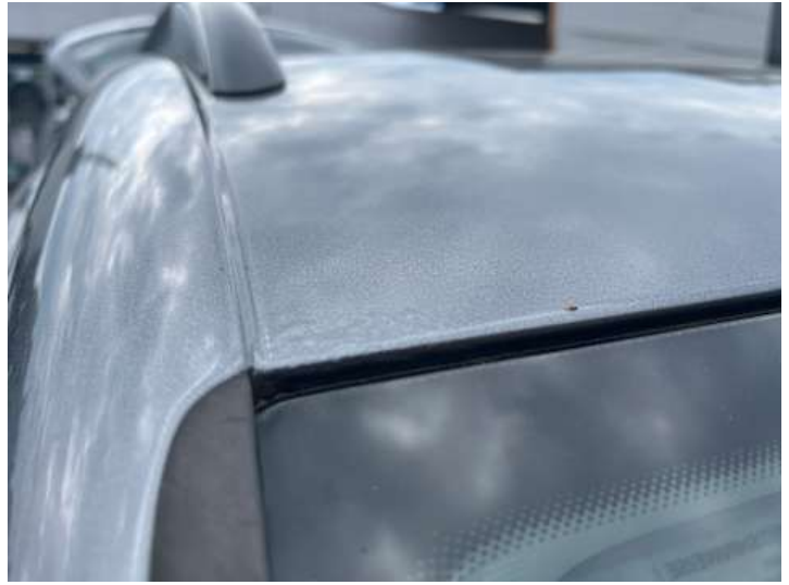
Dach (Lackschaden, Rost)
