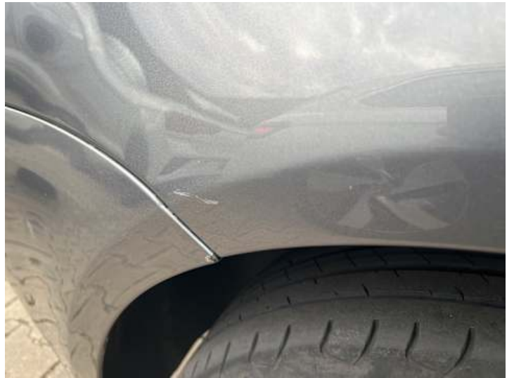
Seitenteil hinten rechts (Rost, Lackschaden)
