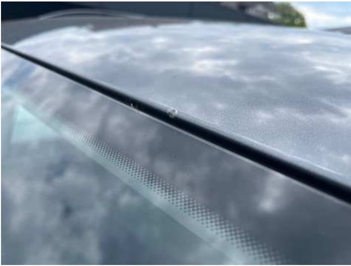
Dach (Lackschaden, Rost)
