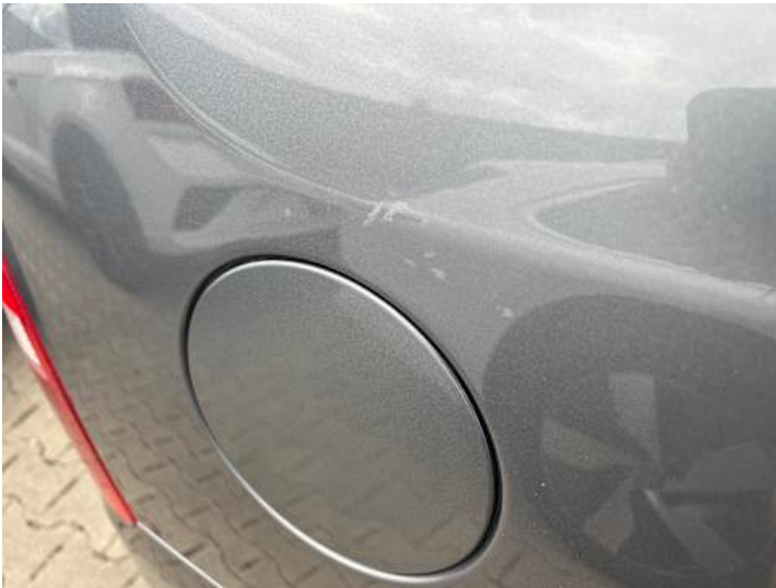
Seitenteil hinten rechts (Rost, Lackschaden)
