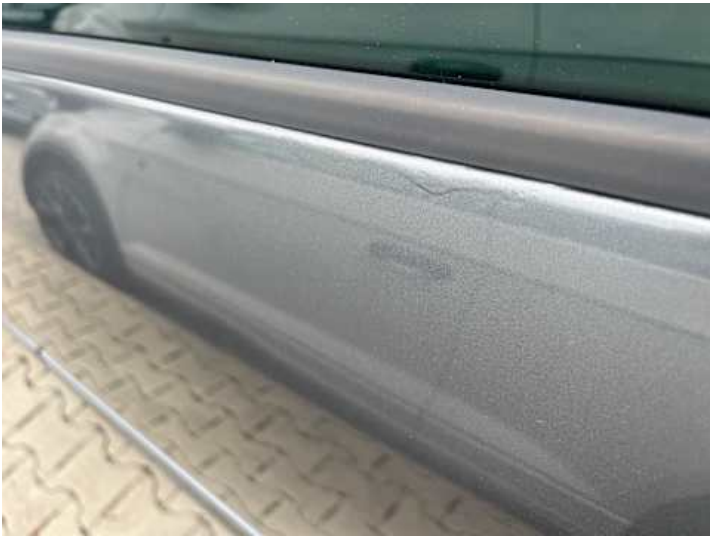
Türe hinten links (Rost, Lackschaden)
