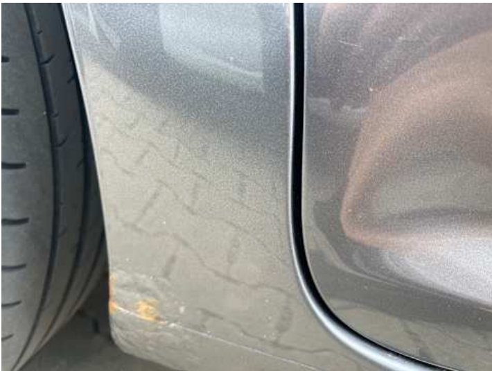
Seitenteil hinten rechts (Rost, Lackschaden)
