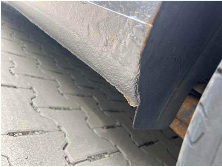
Schweller links (Rost)
