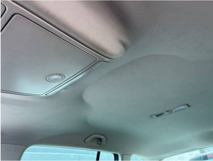
Innenraum (Verschmutzung, Verschleiß, Diverse Schäden, Anderer Schaden): Dachhimmel hängt
