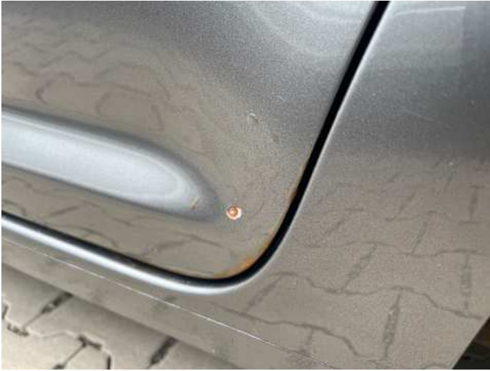
Türe hinten links (Rost, Lackschaden)
