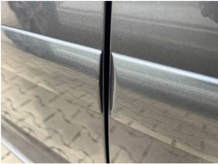
Fahrtür (Lackschaden, Rost)
