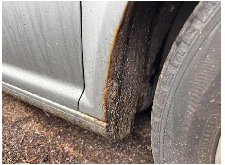
Kotflügel vorne rechts (Rost)
