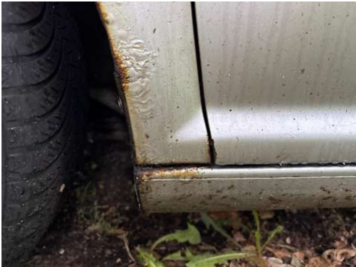
Schweller links (Rost)
