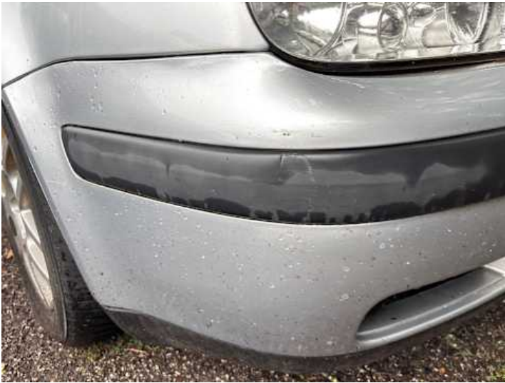
Stoßstange vorne (Kratzer, Lackschaden)
