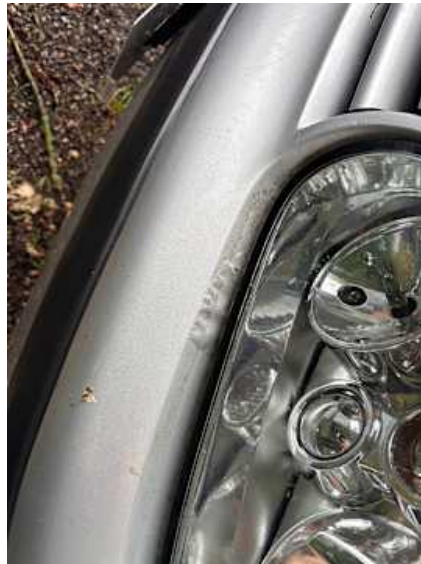
Stoßstange vorne (Kratzer, Lackschaden)
