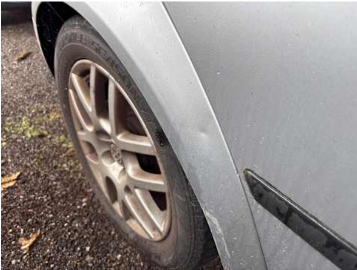
Seitenteil hinten rechts (Delle, Kratzer)
