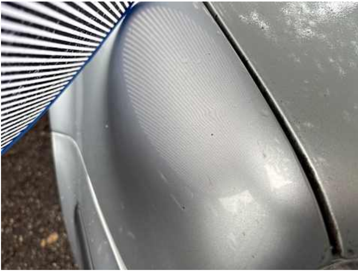
Kotflügel vorne rechts (Delle, Kratzer)
