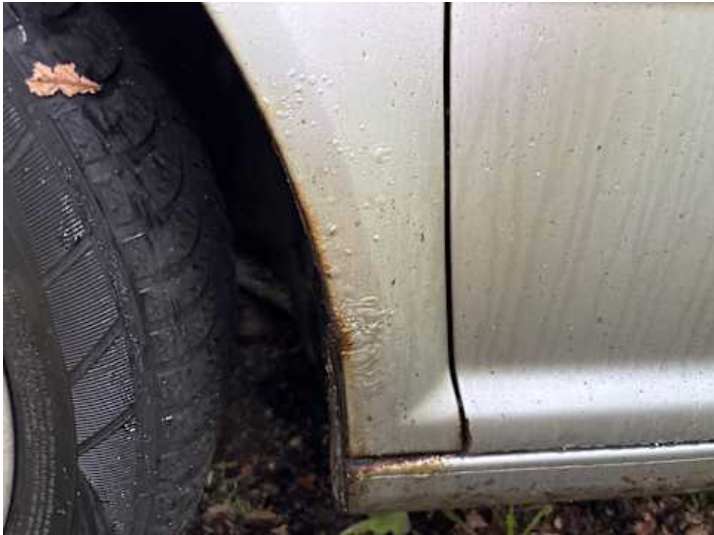
Kotflügel vorne links (Rost)
