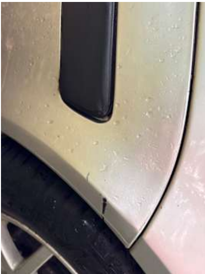
Stoßstange vorne (Kratzer, Lackschaden)
