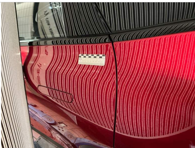
Türe hinten links Delle.
