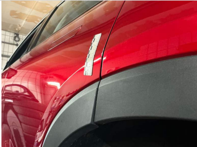
Türkante hinten links Lackbeschädigung und Blende verformt.
