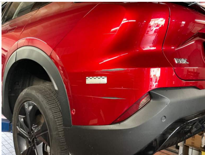
Stoßfängeroberteil hinten Lackbeschädigungen mit Materialabtrag.
