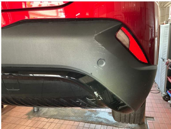
Stoßfängerunterteil und Stoßfängerschürze hinten beschädigt.
