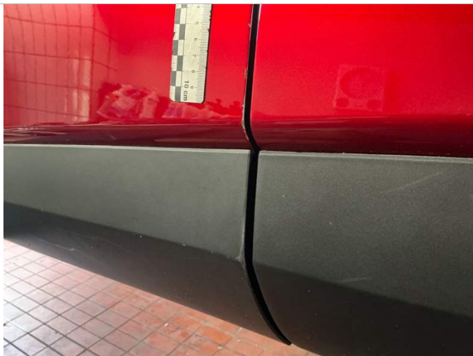
Fahrtürkante Lackbeschädigung und Blende Kratzer.
