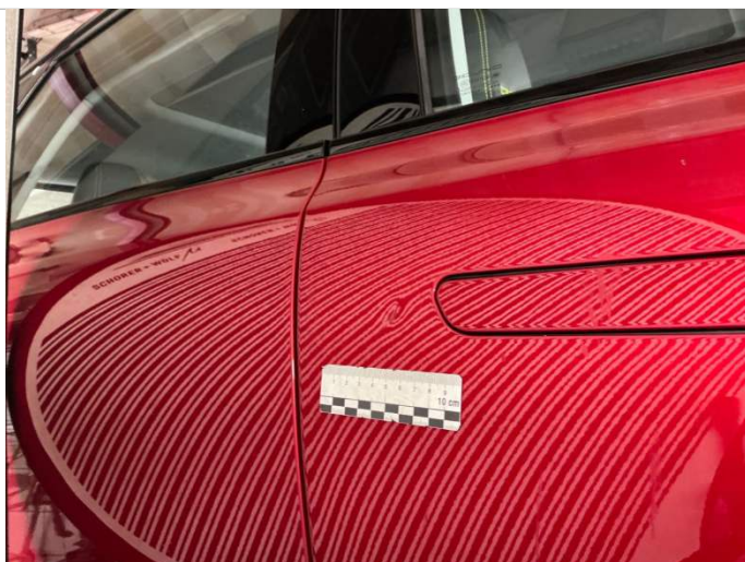
Türe vorn rechts oberhalb Delle.
