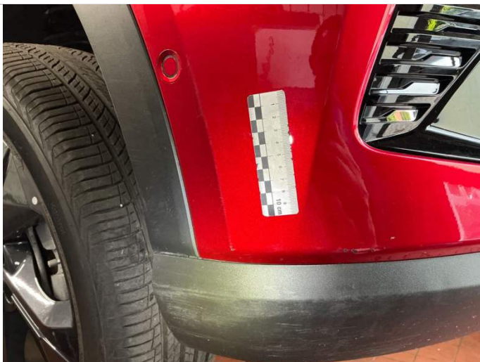
Stoßfänger vorn rechts Kratzer und Lackschäden.
