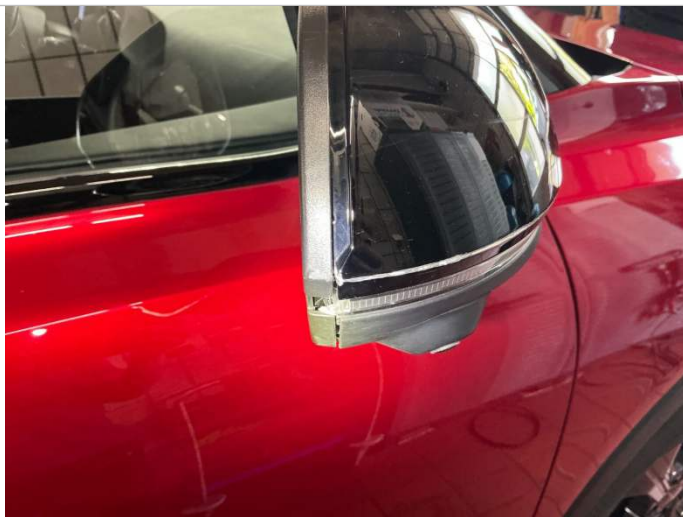
Außenspiegelschale rechts Kratzer und Spiegelblinker beschädigt.
