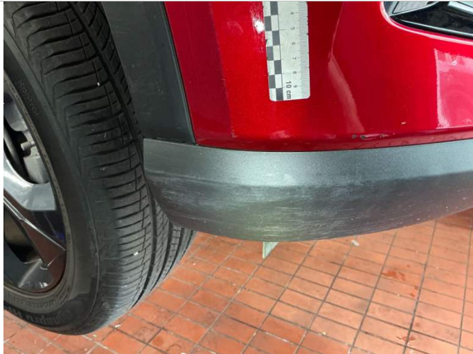
Stoßfängerschürze vorn Kratzer.
