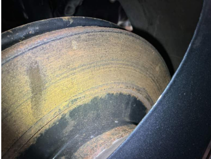
Bremsscheiben hinten Tragbild mangelhaft.
