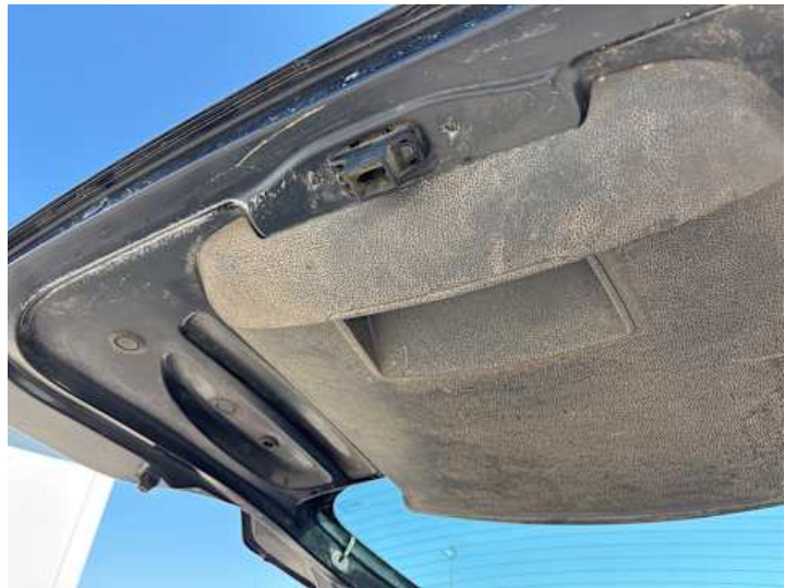
Innenraum (Kratzer, Verschleiß, Verschmutzung)
