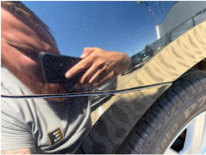
Seitenteil hinten rechts (Rost, Lackschaden)
