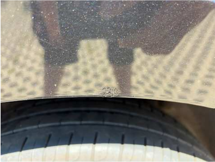
Seitenteil hinten links (Rost, Lackschaden)
