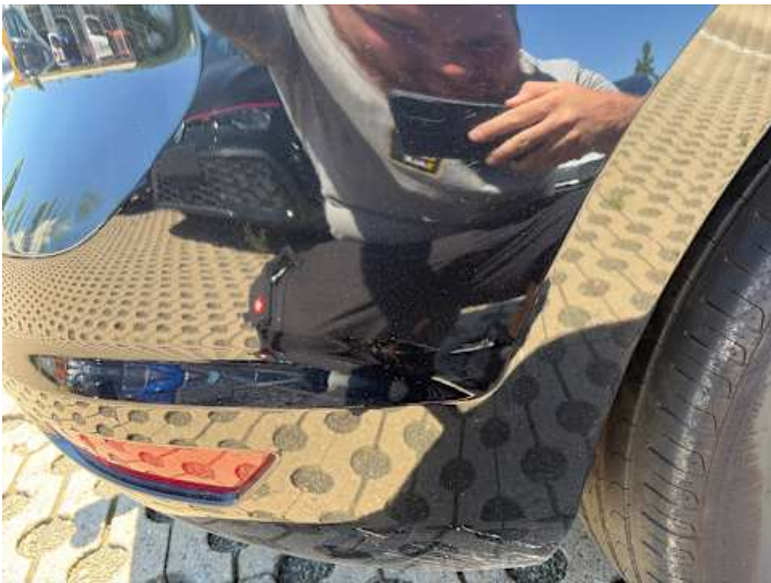
Stoßstange hinten (Kratzer, Lackschaden)
