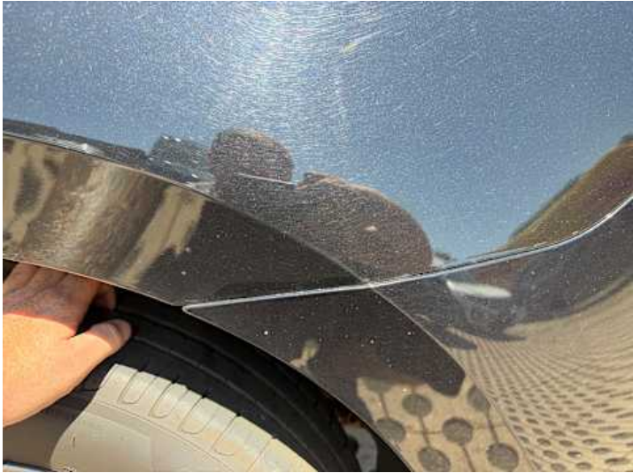
Seitenteil hinten links (Rost, Lackschaden)
