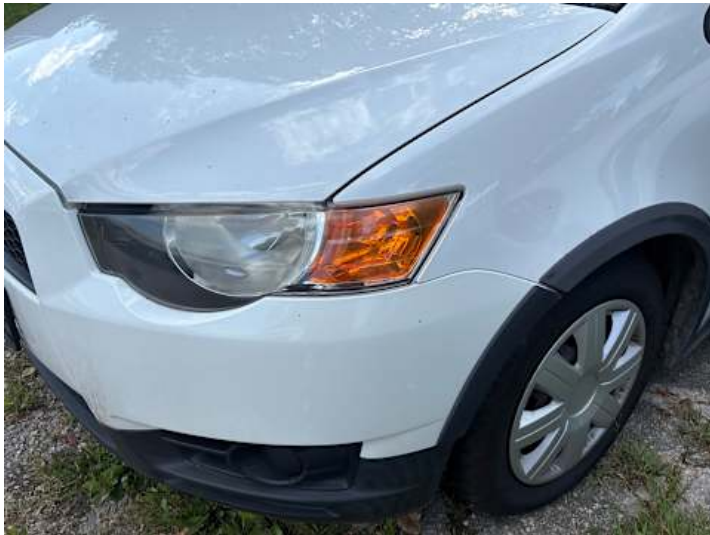
Stoßstange vorne (Unsachgemäß instand gesetzt, Lackschaden)
