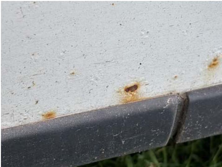
Seitenteil hinten rechts (Lackschaden, Rost)
