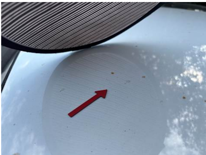
Dach (Delle, Verformung)
