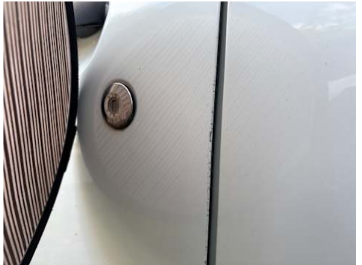
Fahrertür (Delle, Verformung)
