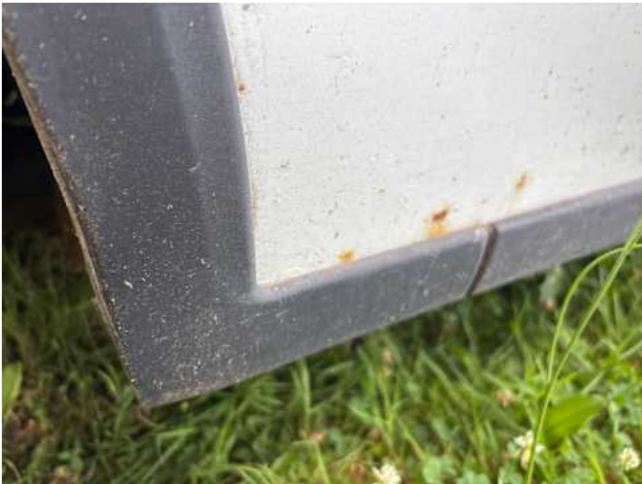
Seitenteil hinten rechts (Lackschaden, Rost)
