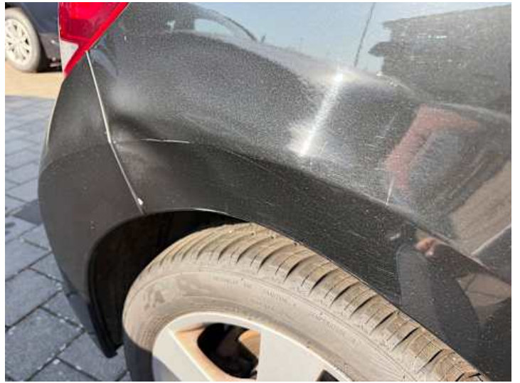
Seitenteil hinten rechts (Kratzer, Verformung)
