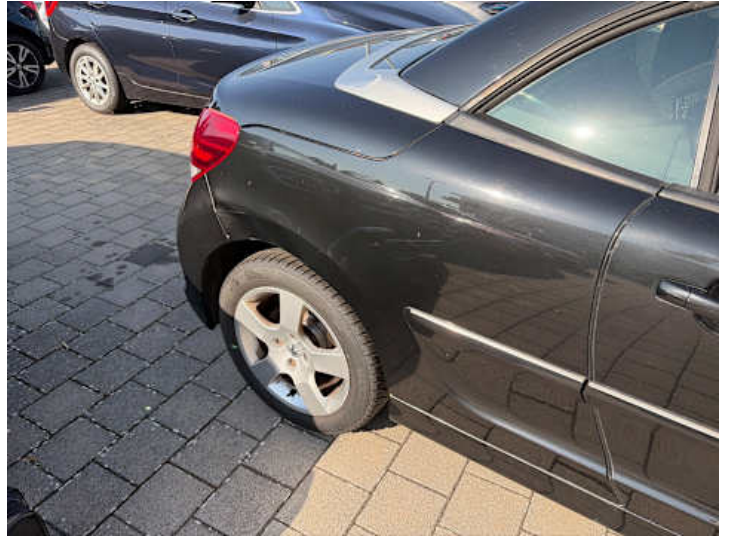
Seitenteil hinten rechts (Kratzer, Verformung)
