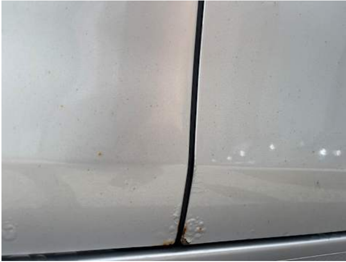
Türe hinten rechts (Lackschaden, Rost)
