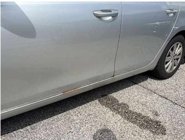
Fahrtür (Lackschaden, Rost)
