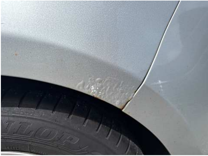
Seitenteil hinten links (Lackschaden, Rost)
