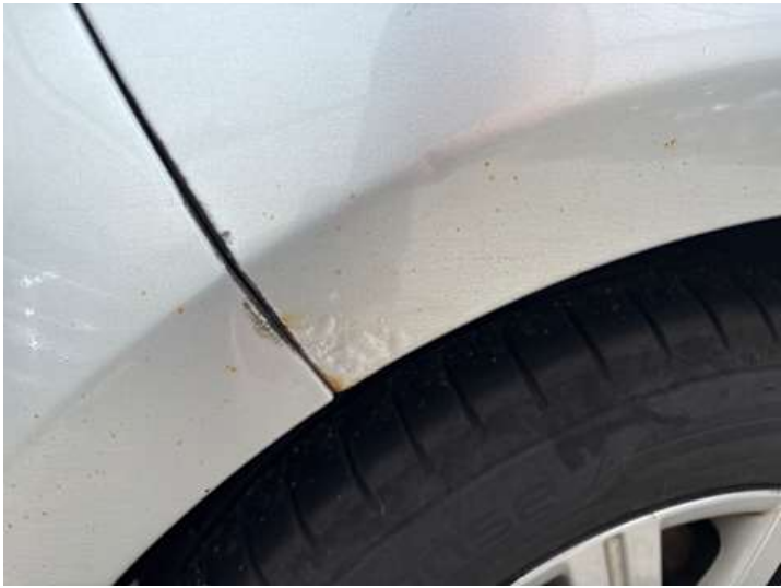
Seitenteil hinten rechts (Lackschaden, Rost)
