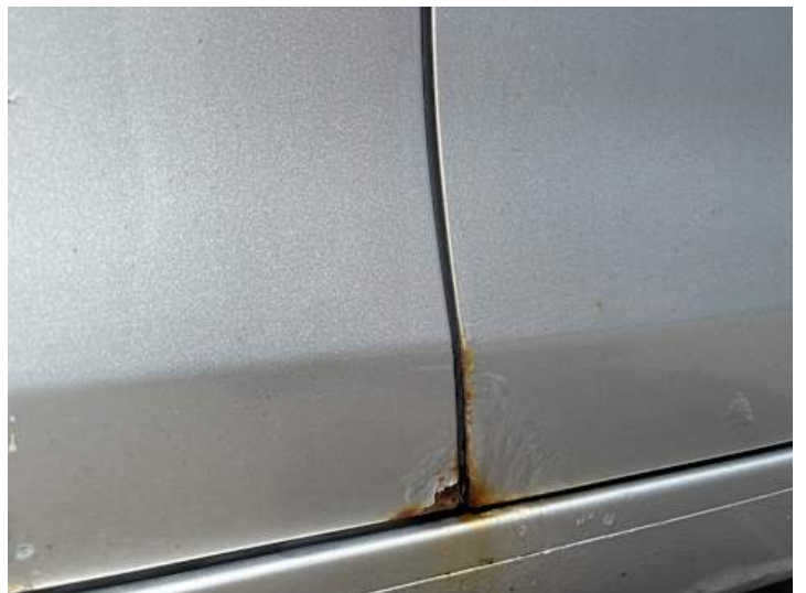
Fahrtür (Lackschaden, Rost)
