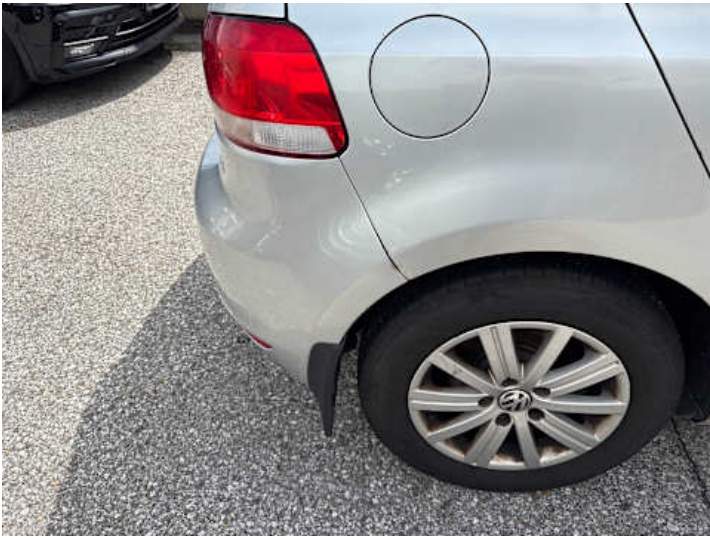
Seitenteil hinten rechts (Lackschaden, Rost)
