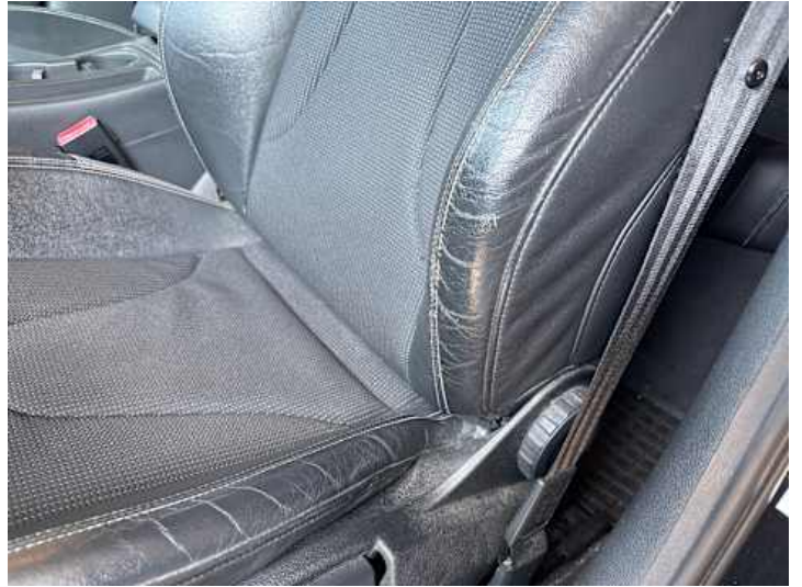
Innenraum (Riss/Bruch, Verschleiß)
