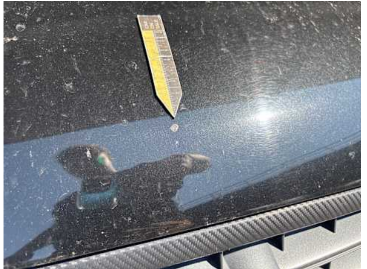
Motorhaube (Lackschaden, Unsachgemäß instand gesetzt, Steinschlag)
