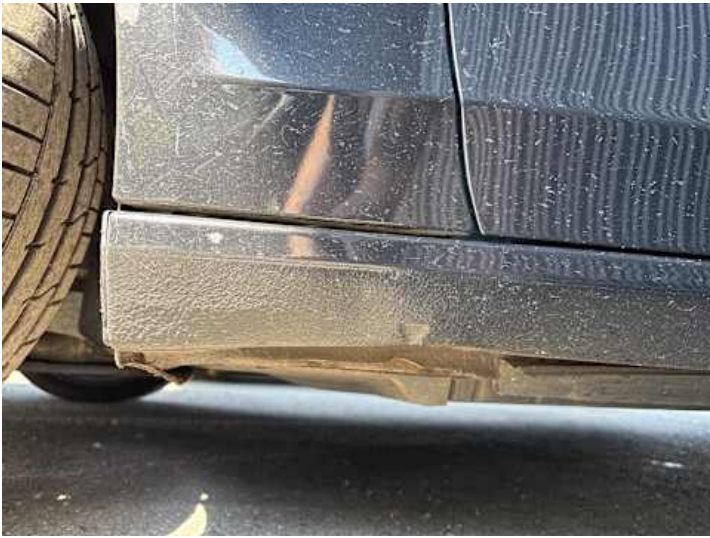
Schweller links (Verformung, Rost)
