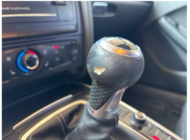
Innenraum (Riss/Bruch, Verschleiß)
