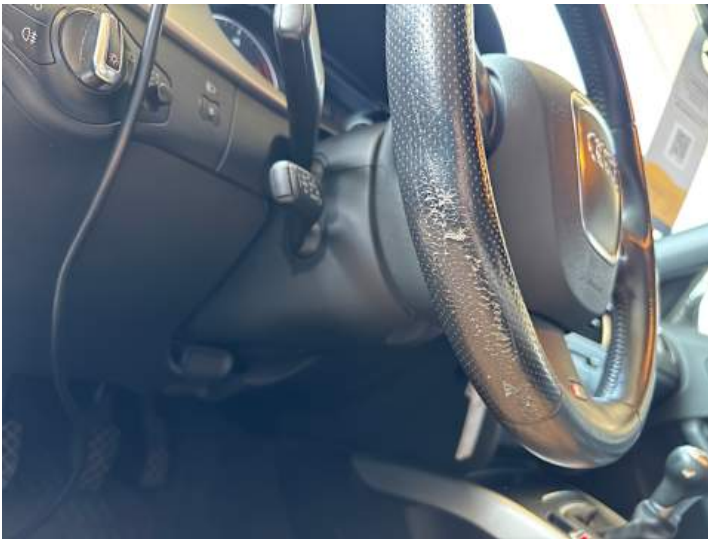
Innenraum (Riss/Bruch, Verschleiß)
