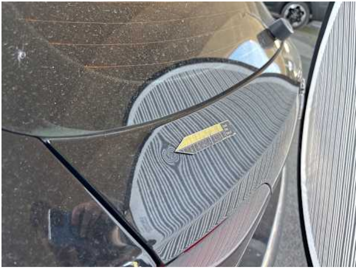
Heckklappe (Delle, Lackschaden, Rost)
