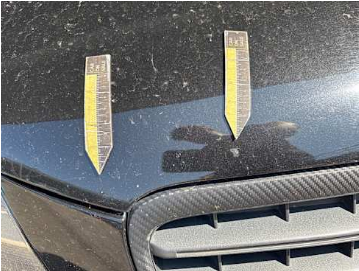
Motorhaube (Lackschaden, Unsachgemäß instand gesetzt, Steinschlag)
