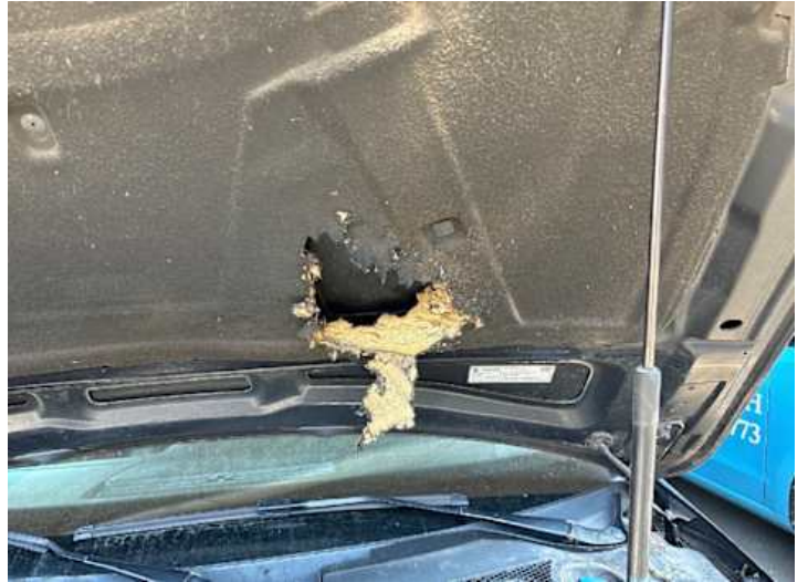
Motorhaube (Anderer Schaden): Marderschaden: Dämmmatte zerbissen
