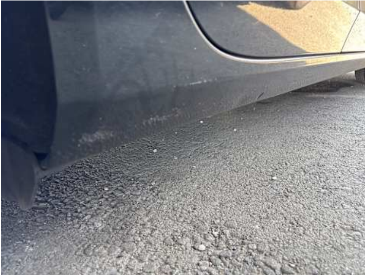
Schweller rechts (Lackschaden)
