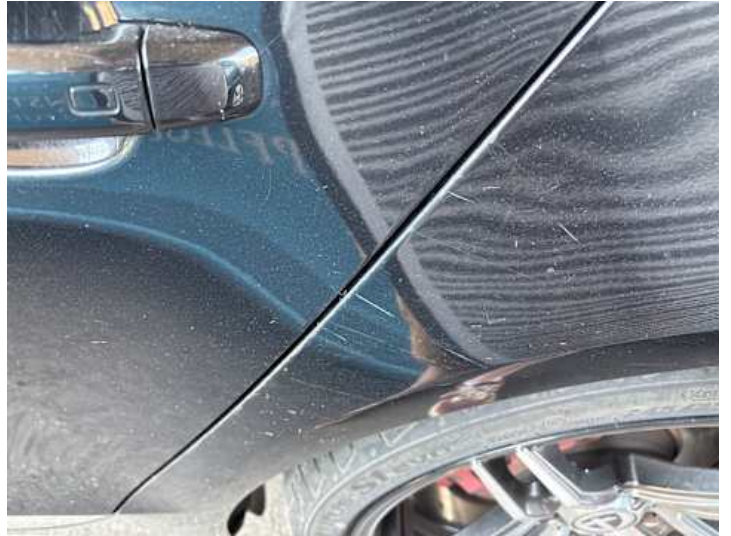
Seitenteil hinten links (Kratzer)
