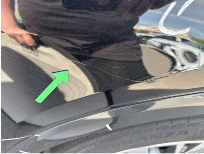
Kotflügel vorne rechts (Kratzer)
