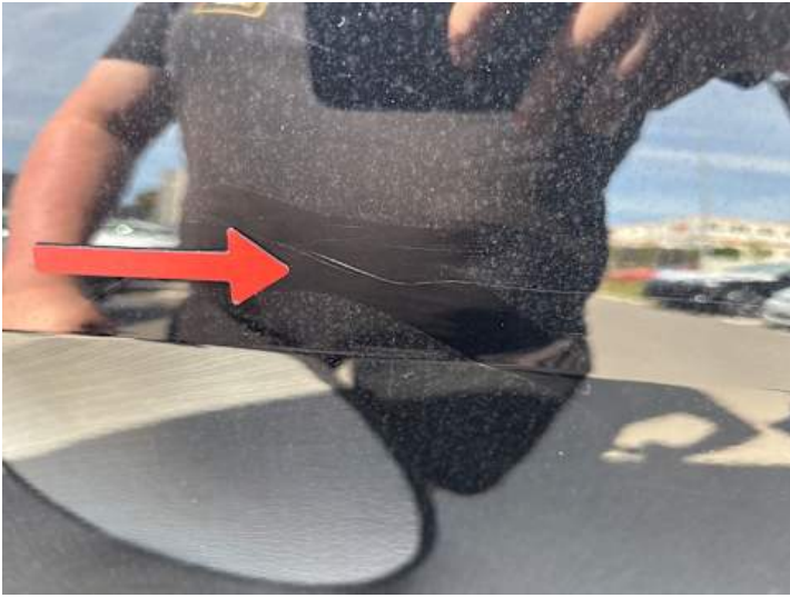
Türe hinten rechts (Kratzer)
