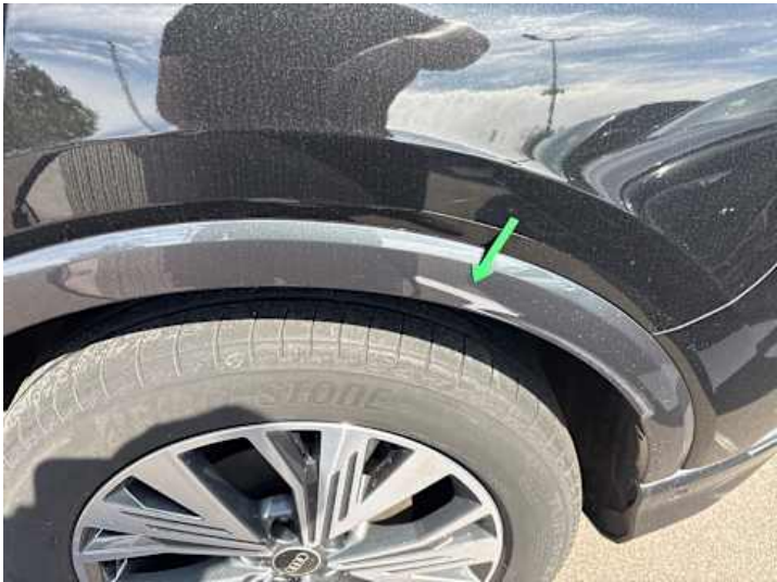
Seitenteil hinten links (Kratzer)
