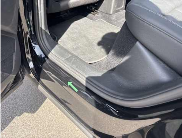
Schweller links (Kratzer)
