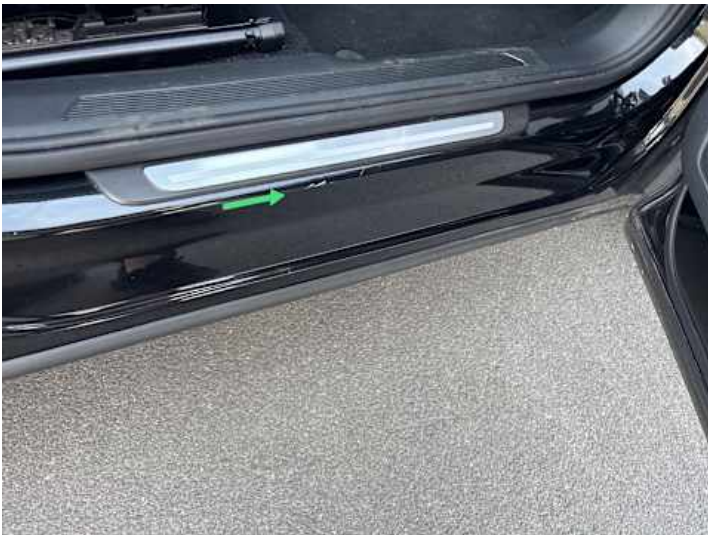
Schweller rechts (Kratzer)
