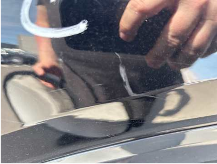
Kotflügel vorne rechts (Kratzer)
