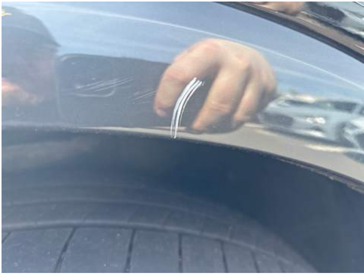
Kotflügel vorne rechts (Kratzer)
