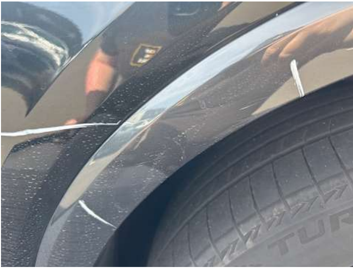
Kotflügel vorne rechts (Kratzer)
