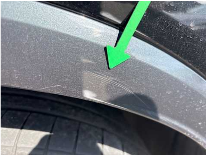
Seitenteil hinten links (Kratzer)
