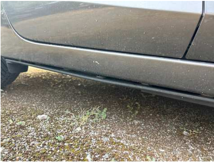
Schweller rechts (Verformung)
