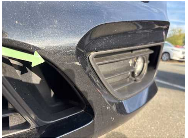
Stoßstange vorne (Kratzer, Lackschaden)
