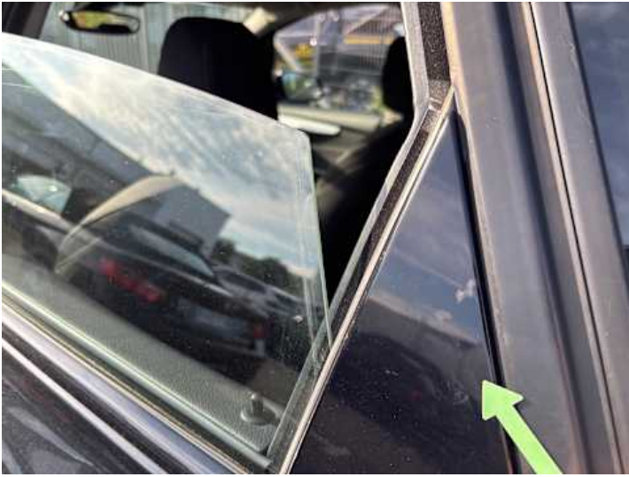
Türe hinten links (Anderer Schaden): Verfärbung
