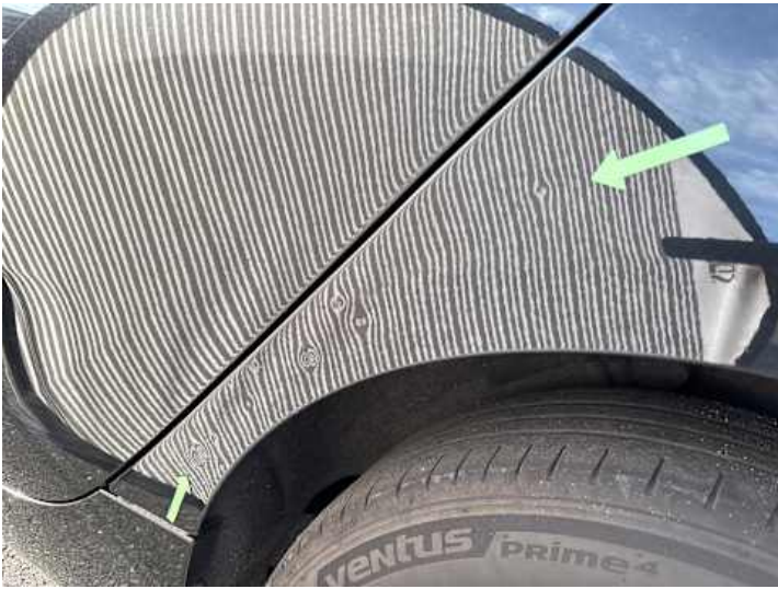
Seitenteil hinten links (Delle, Lackschaden, Kratzer)
