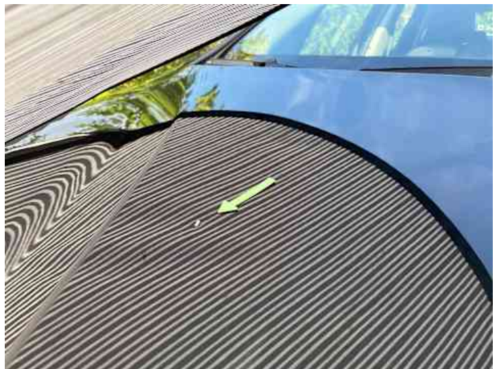
Motorhaube (Delle, Lackschaden)
