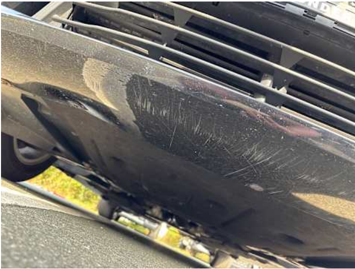
Stoßstange vorne (Kratzer, Lackschaden)
