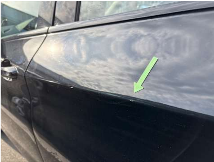
Türe hinten links (Lackschaden)
