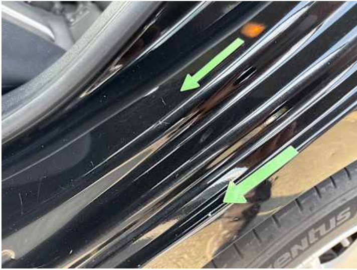
Türe hinten links (Rost, Lackschaden)
