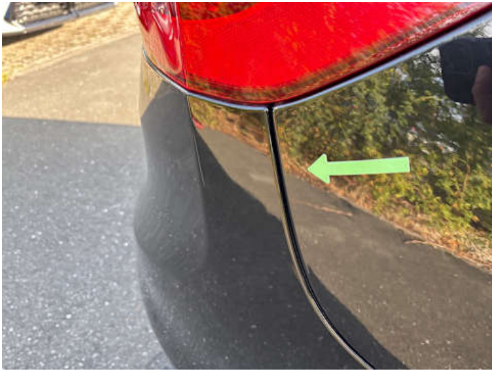
Seitenteil hinten rechts (Spaltmaße ungenau)
