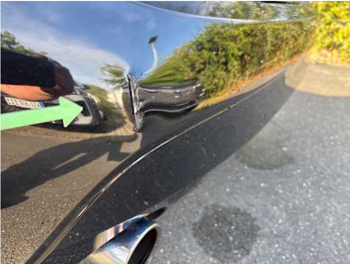
Stoßstange hinten (Riss/Bruch, Lackschaden, Verformung)
