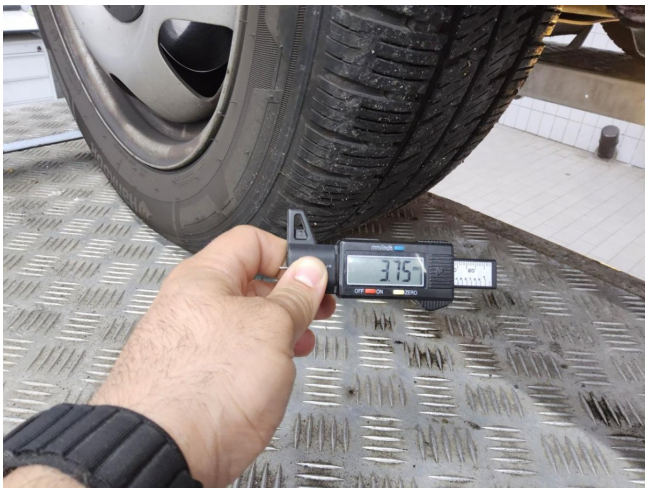
Reifen (Ganzjahres-Radsatz) - Vorderachse links - Ganzjahresreifen unter 4 mm, erneuern
