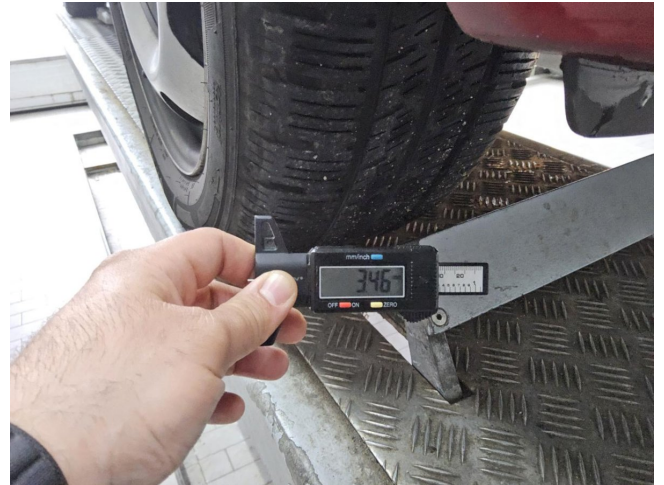
Reifen (Ganzjahres-Radsatz) - Vorderachse rechts - Ganzjahresreifen unter 4 mm, erneuern
