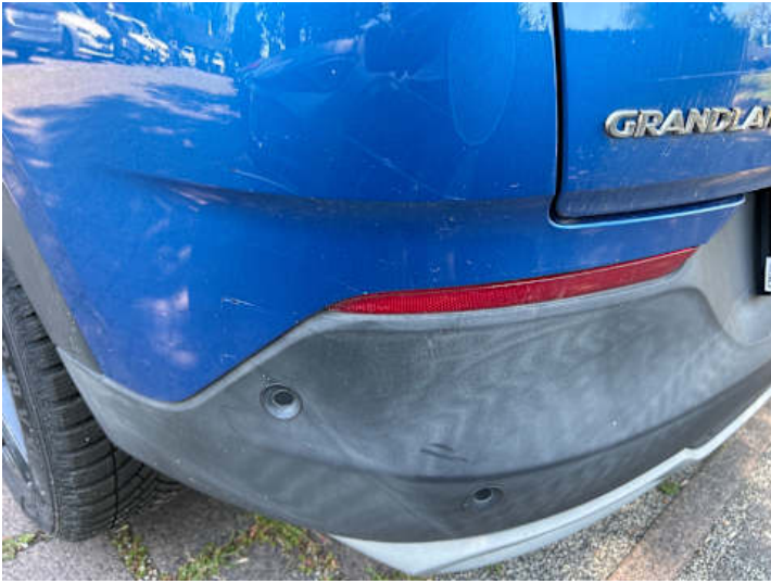
Stoßstange hinten (Kratzer)
