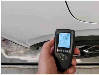
Lackstärke Seitenwand hinten rechts
