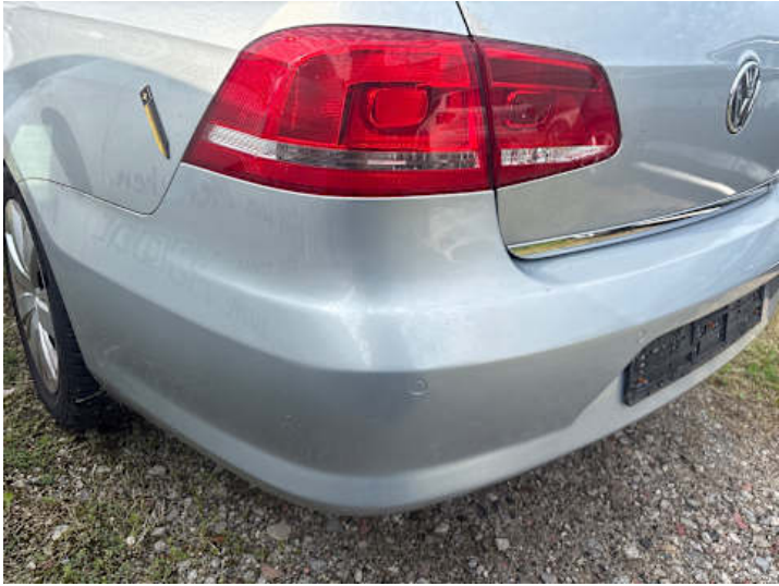
Stoßstange hinten (Lackschaden)
