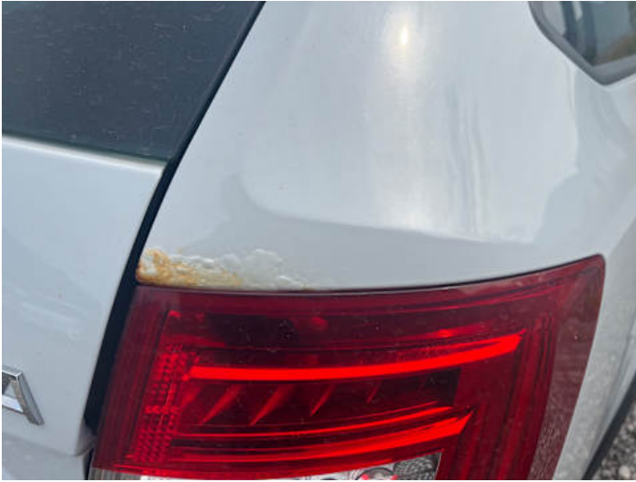
Seitenteil hinten rechts (Lackschaden, Rost)
