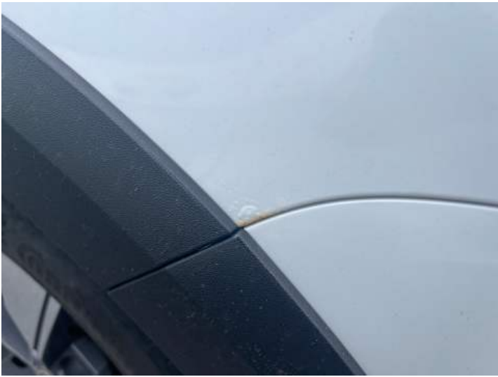
Seitenteil hinten links (Rost, Lackschaden)
