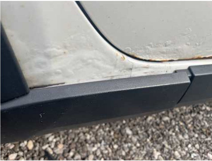
Schweller rechts (Rost, Lackschaden)
