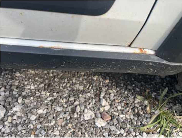
Schweller rechts (Rost, Lackschaden)
