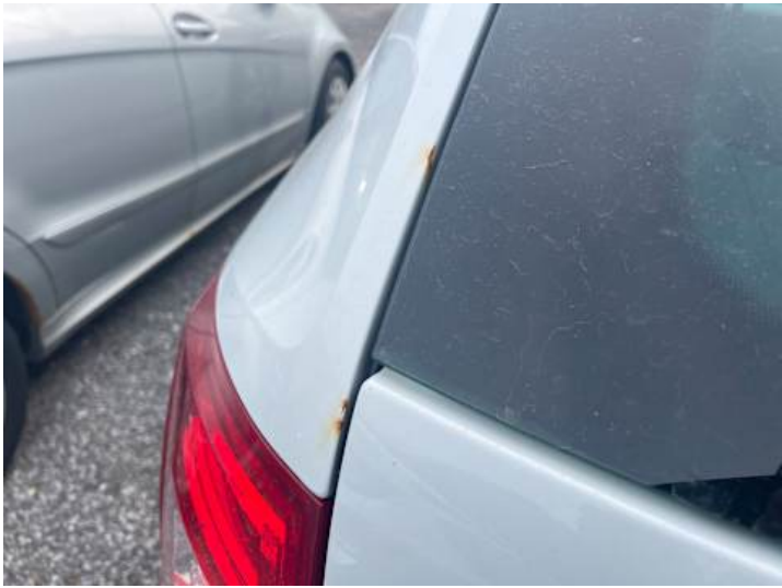
Seitenteil hinten links (Rost, Lackschaden)
