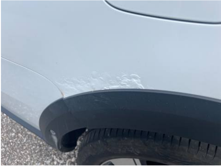
Seitenteil hinten rechts (Lackschaden, Rost)
