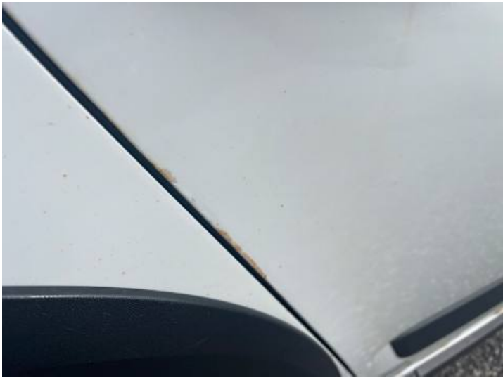
Türe hinten rechts (Rost, Lackschaden)
