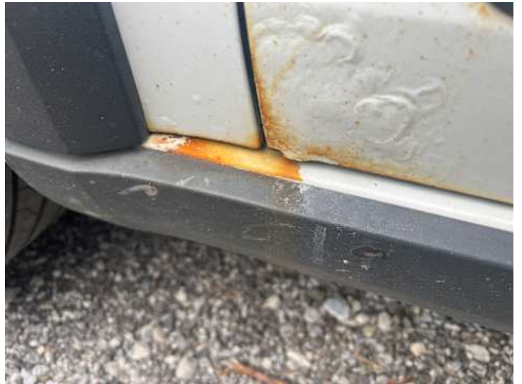
Schweller links (Rost, Lackschaden)
