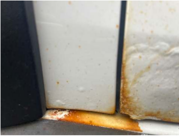
Kotflügel vorne links (Rost, Lackschaden)
