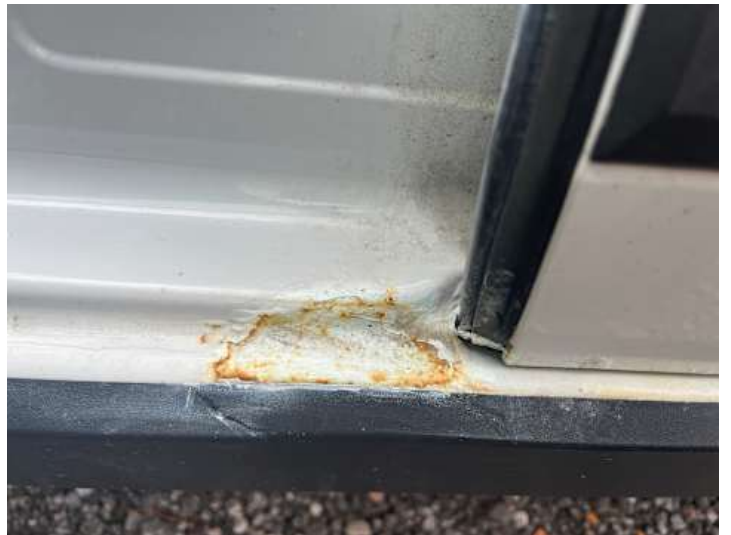
Schweller links (Rost, Lackschaden)
