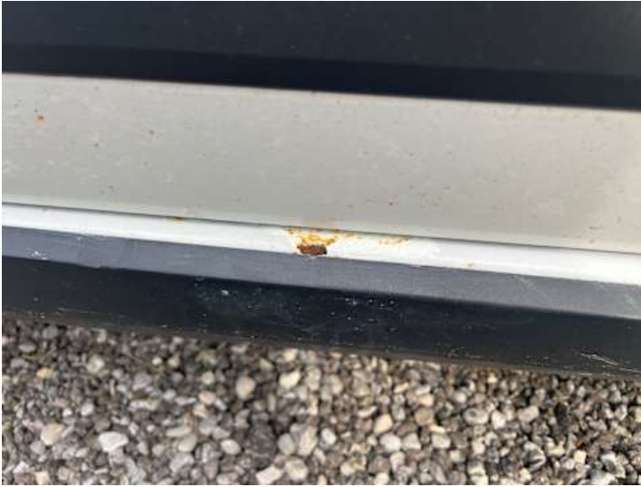
Schweller rechts (Rost, Lackschaden)
