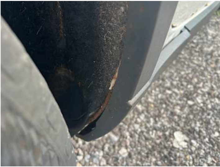
Schweller rechts (Rost, Lackschaden)
