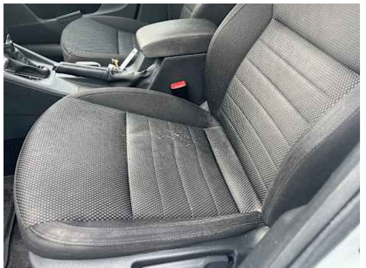
Innenraum (Verschmutzung, Verschleiß)
