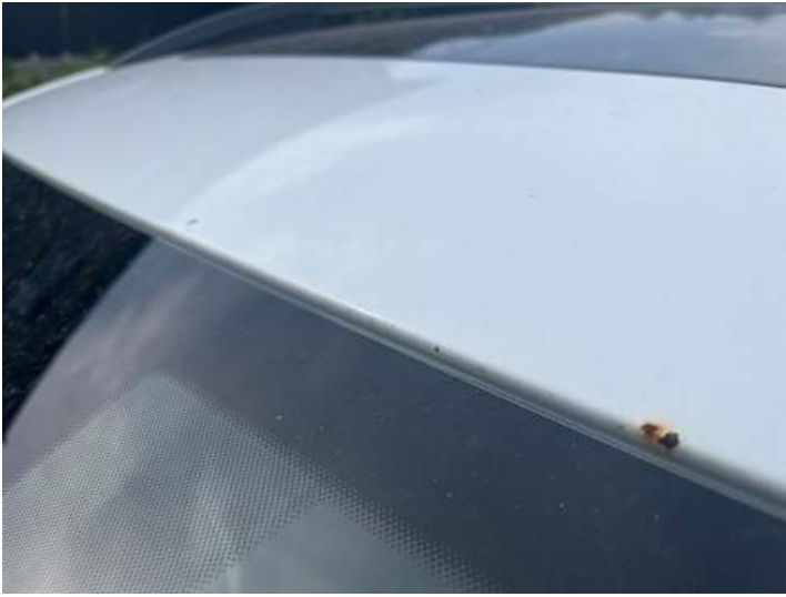
Dach (Rost, Lackschaden)
