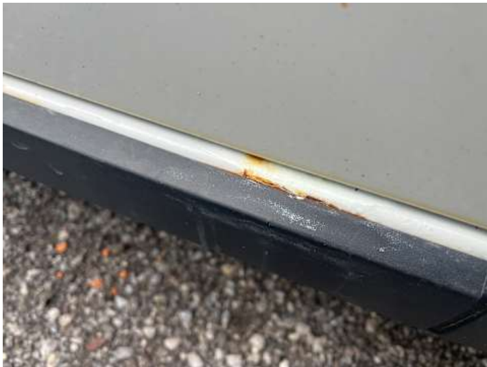
Schweller links (Rost, Lackschaden)
