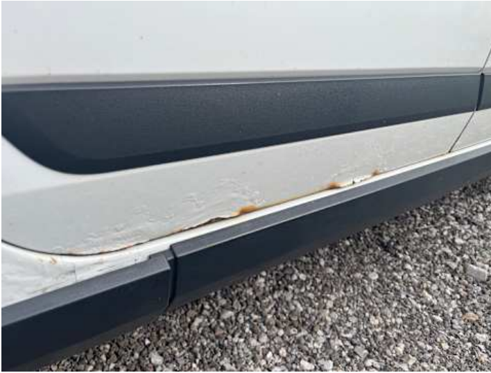
Türe hinten rechts (Rost, Lackschaden)
