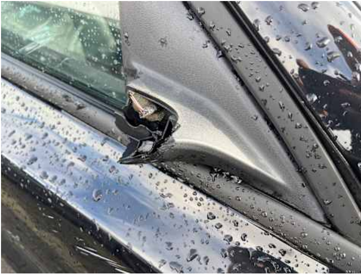
Beifahrertür (Verformung, Lackschaden, Riss/Bruch)
