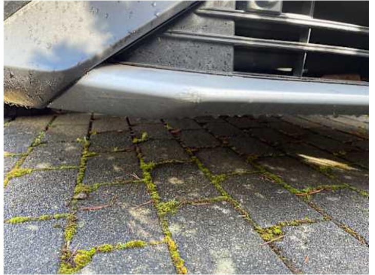
Stoßstange vorne (Riss/Bruch, Verformung, Lackschaden)
