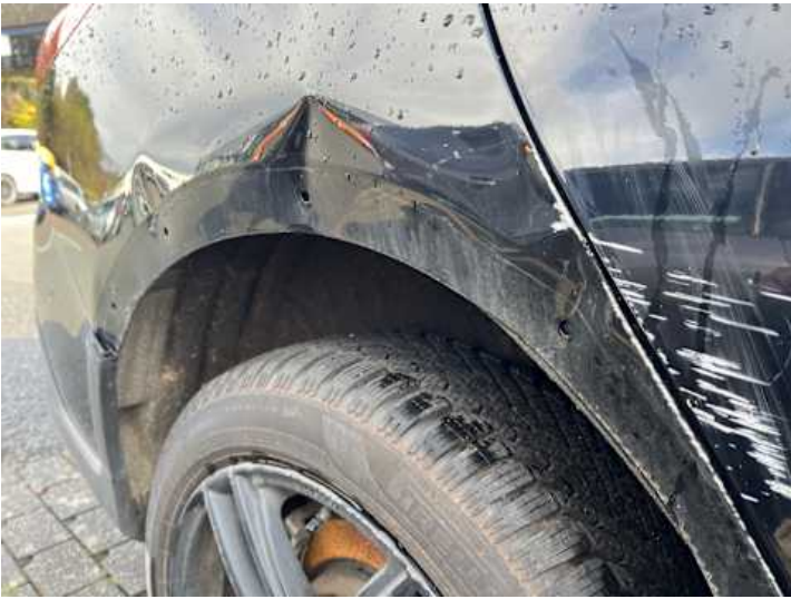
Seitenteil hinten rechts (Verformung, Lackschaden, Kratzer, Delle)
