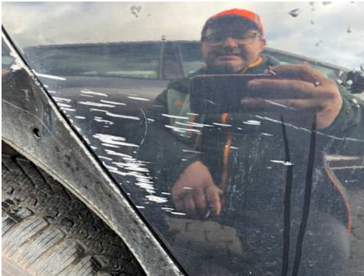
Türe hinten rechts (Lackschaden, Kratzer)
