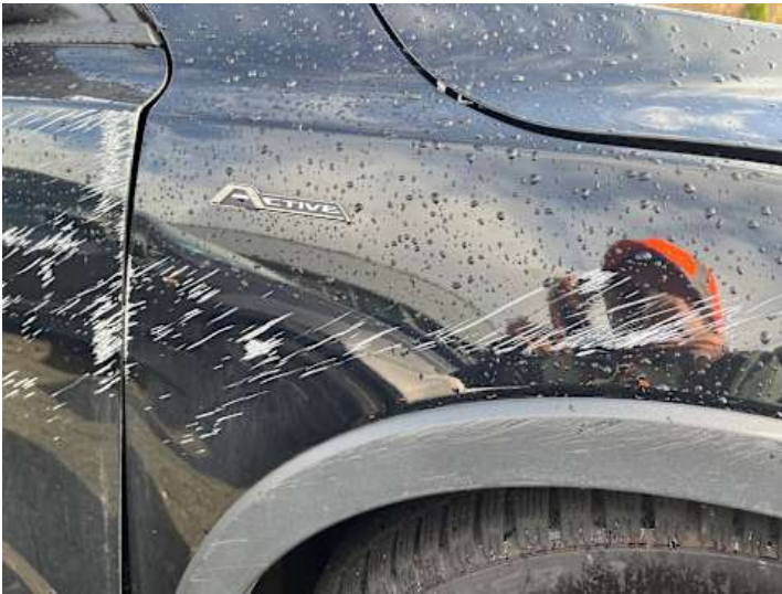
Kotflügel vorne rechts (Verformung, Lackschaden)
