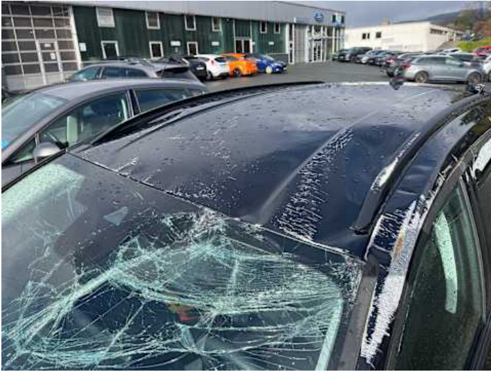
Dach (Verformung, Lackschaden)
