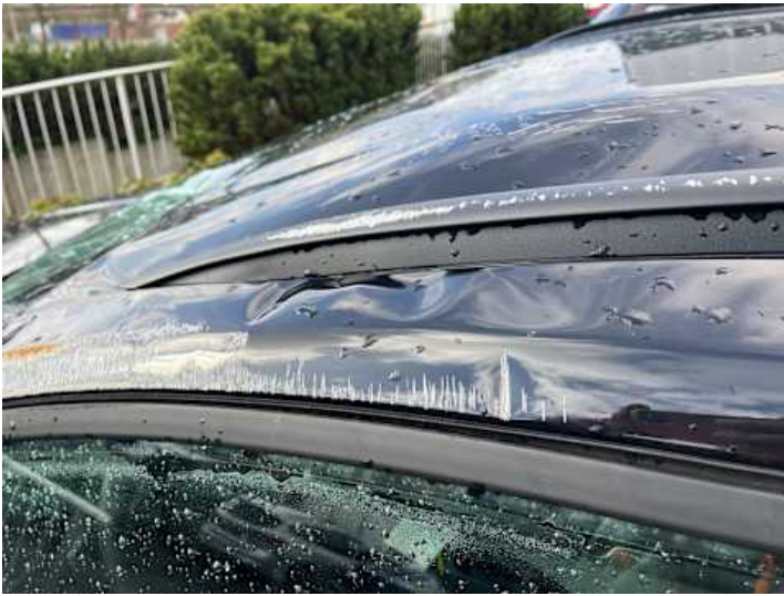
Seitenteil hinten links (Verformung, Delle, Lackschaden, Kratzer)
