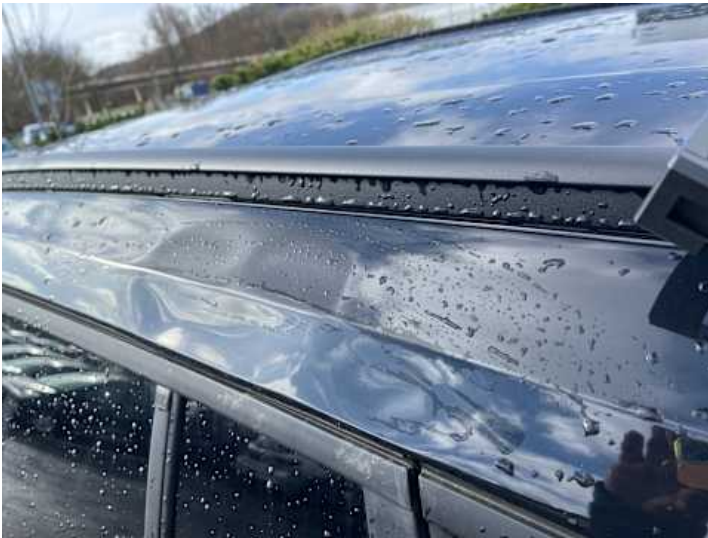
Seitenteil hinten links (Verformung, Delle, Lackschaden, Kratzer)
