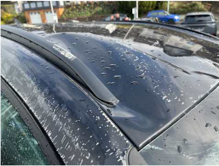
Dach (Verformung, Lackschaden)
