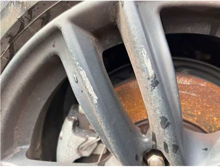
Rad (Kerben, Verformung)
