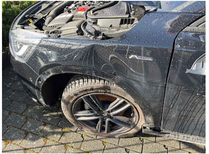
Kotflügel vorne links (Verformung, Riss/Bruch)
