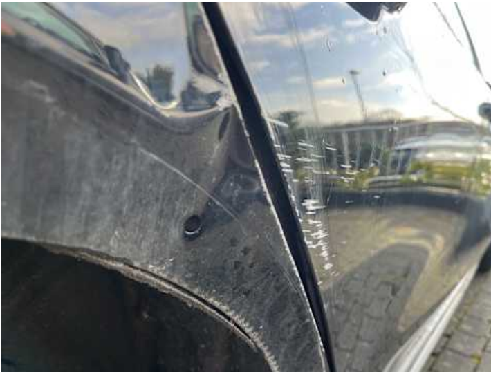
Türe hinten rechts (Lackschaden, Kratzer)
