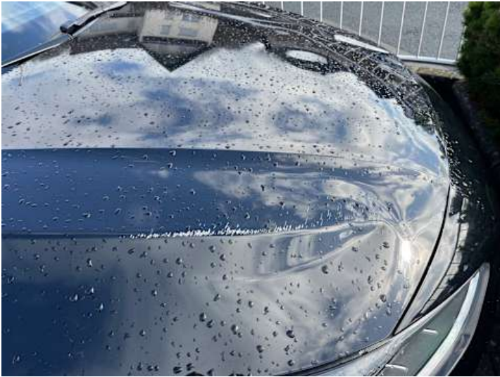
Motorhaube (Verformung, Kratzer, Delle)
