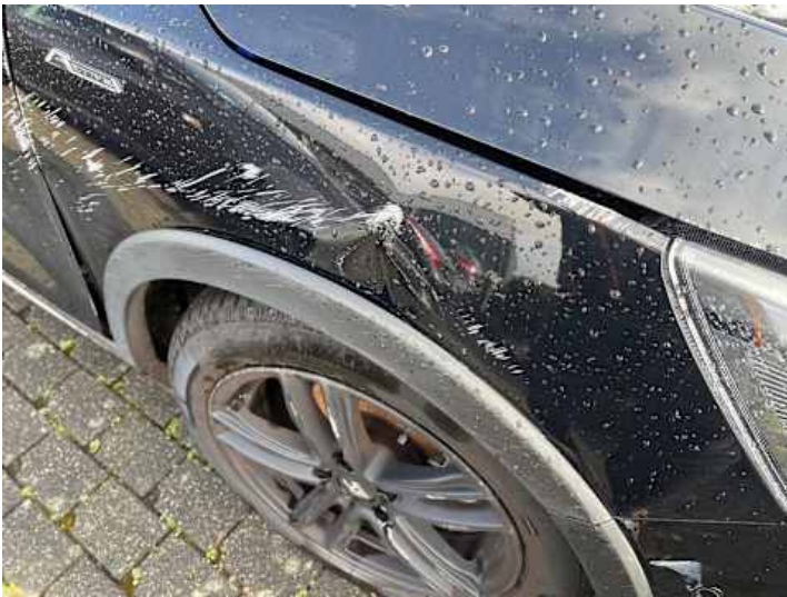
Kotflügel vorne rechts (Verformung, Lackschaden)
