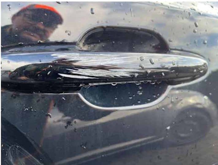
Türe hinten rechts (Lackschaden, Kratzer)
