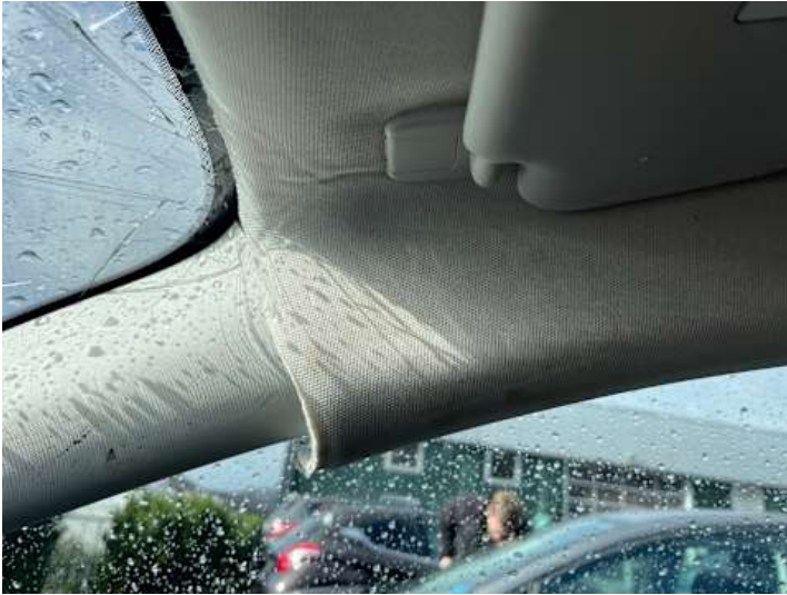
Innenraum (Wassereintritt, Verschleiß, Verschmutzung)
