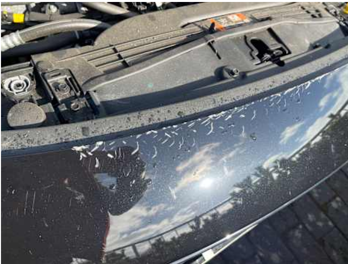
Stoßstange vorne (Riss/Bruch, Verformung, Lackschaden)
