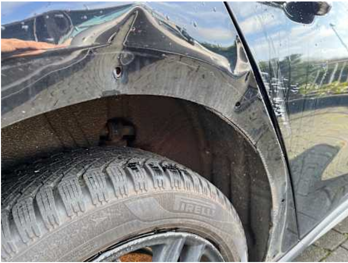
Seitenteil hinten rechts (Verformung, Lackschaden, Kratzer, Delle)
