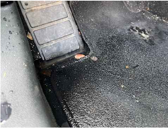
Innenraum (Wassereintritt, Verschleiß, Verschmutzung)
