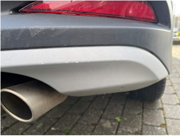
Stoßstange hinten (Lackschaden, Kratzer)
