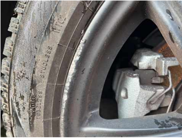
Rad (Kerben, Verformung)
