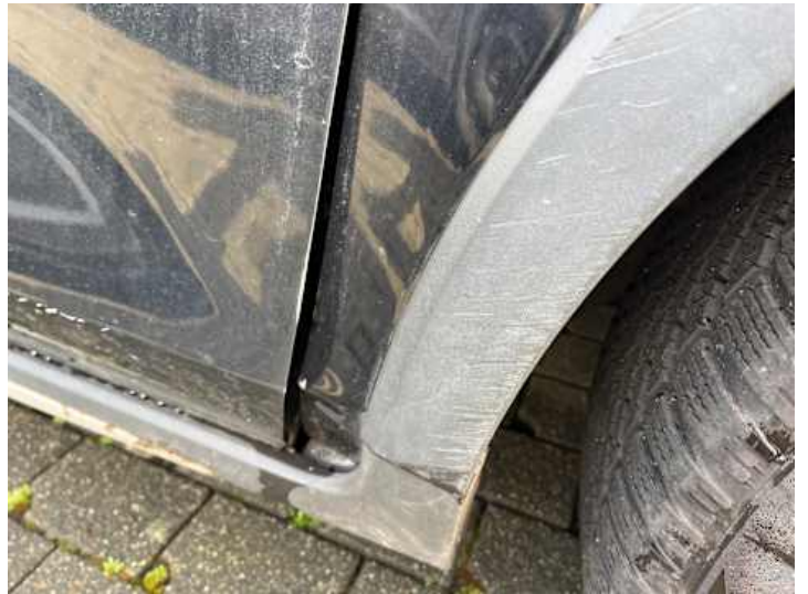
Kotflügel vorne rechts (Verformung, Lackschaden)
