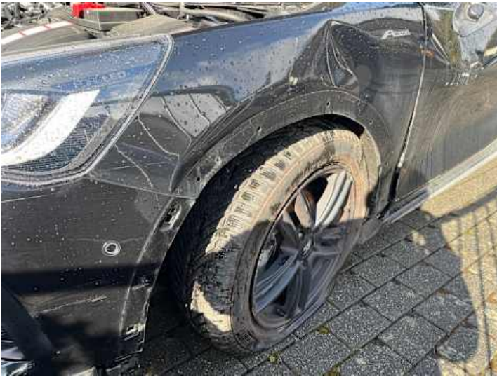
Kotflügel vorne links (Verformung, Riss/Bruch)
