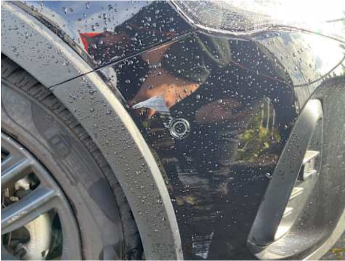
Stoßstange vorne (Riss/Bruch, Verformung, Lackschaden)
