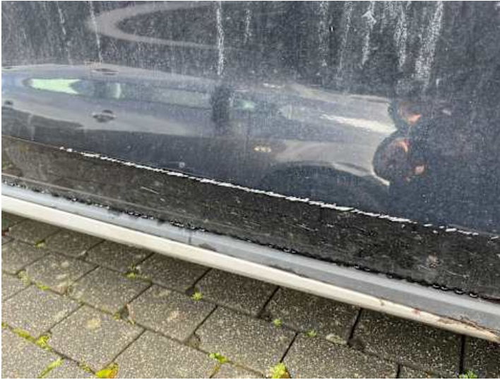
Beifahrertür (Verformung, Lackschaden, Riss/Bruch)
