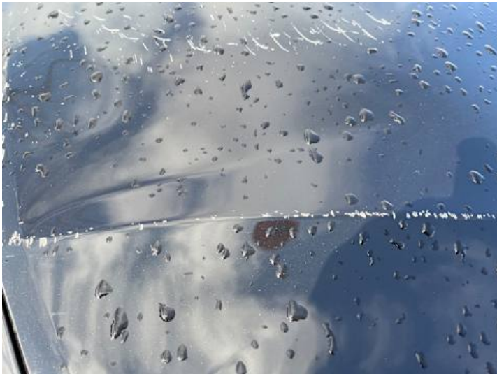
Motorhaube (Verformung, Kratzer, Delle)
