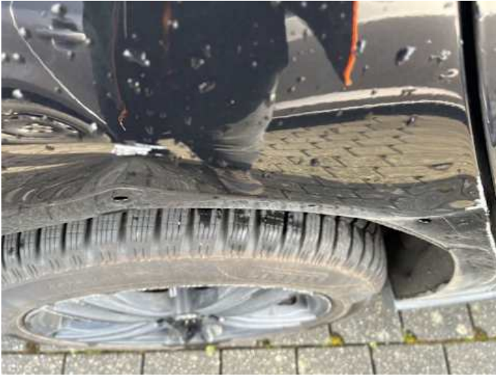
Seitenteil hinten rechts (Verformung, Lackschaden, Kratzer, Delle)
