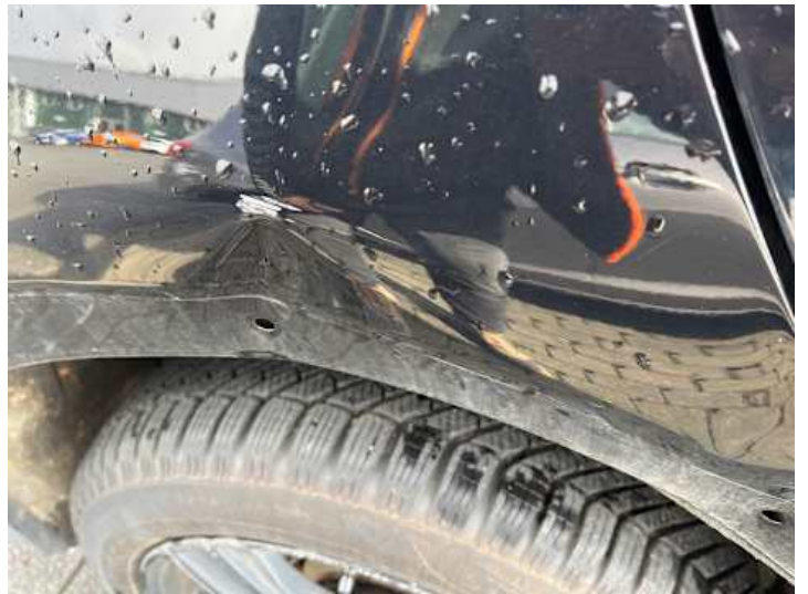
Seitenteil hinten rechts (Verformung, Lackschaden, Kratzer, Delle)
