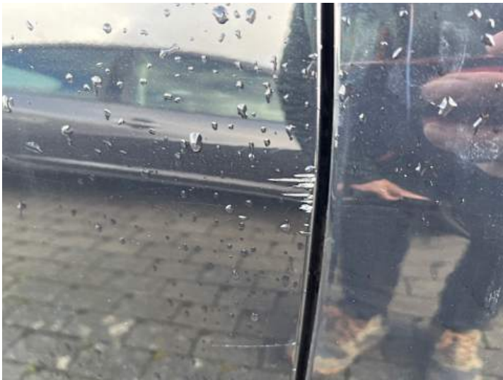
Türe hinten rechts (Lackschaden, Kratzer)
