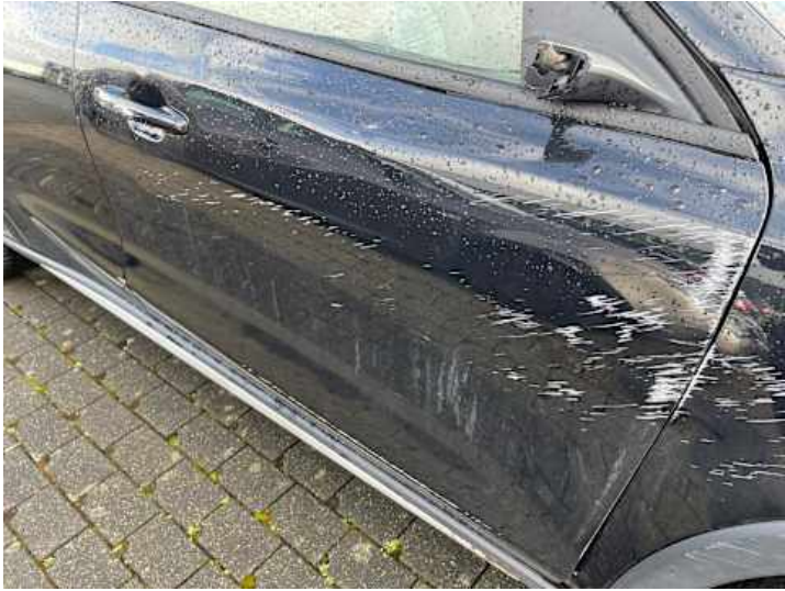
Beifahrertür (Verformung, Lackschaden, Riss/Bruch)
