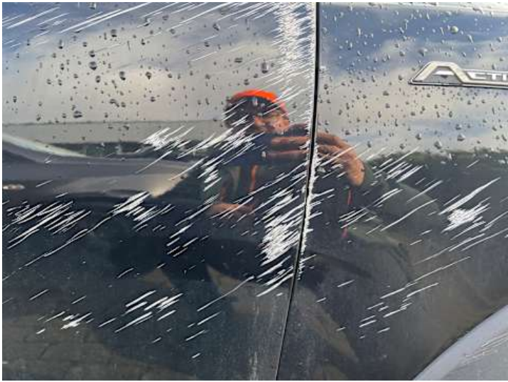
Beifahrertür (Verformung, Lackschaden, Riss/Bruch)
