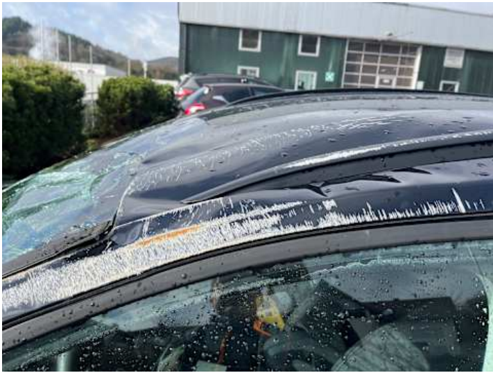
Dach (Verformung, Lackschaden)
