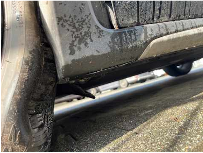
Schweller links (Verformung)
