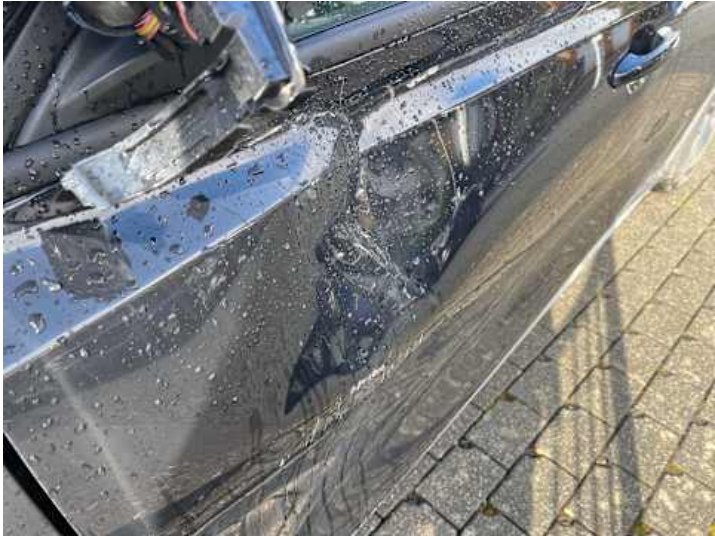
Fahrtür (Riss/Bruch, Verformung)
