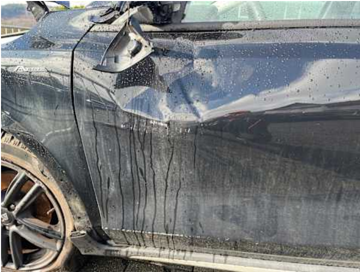
Fahrtür (Riss/Bruch, Verformung)
