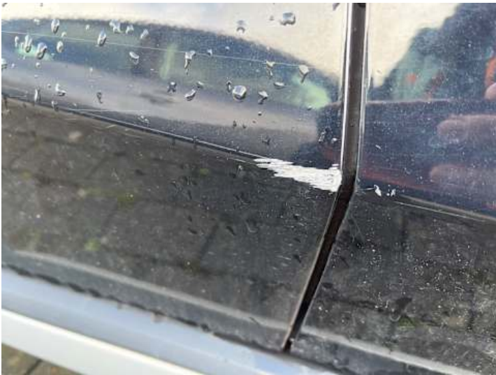
Türe hinten rechts (Lackschaden, Kratzer)
