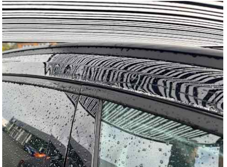
Seitenteil hinten rechts (Verformung, Lackschaden, Kratzer, Delle)
