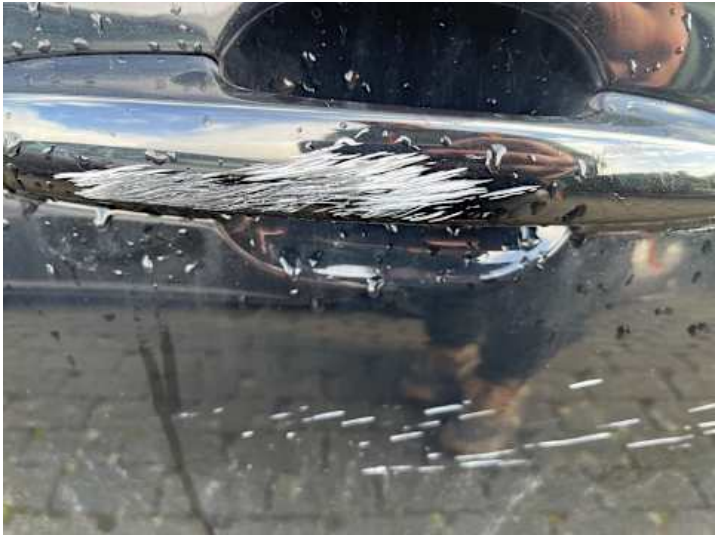
Beifahrtür (Verformung, Lackschaden, Riss/Bruch)
