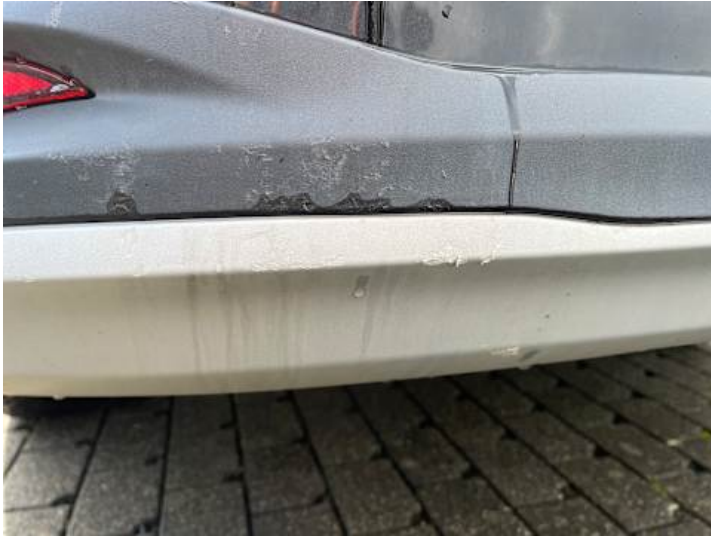
Stoßstange hinten (Lackschaden, Kratzer)
