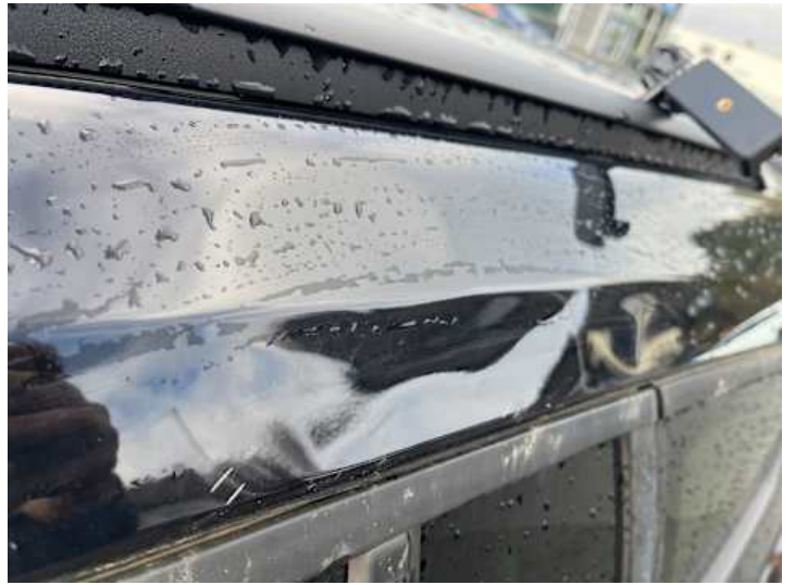
Seitenteil hinten links (Verformung, Delle, Lackschaden, Kratzer)
