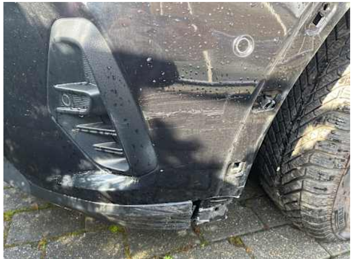
Stoßstange vorne (Riss/Bruch, Verformung, Lackschaden)
