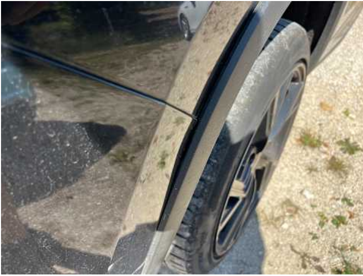
Stoßstange hinten (Unsachgemäß instand gesetzt)
