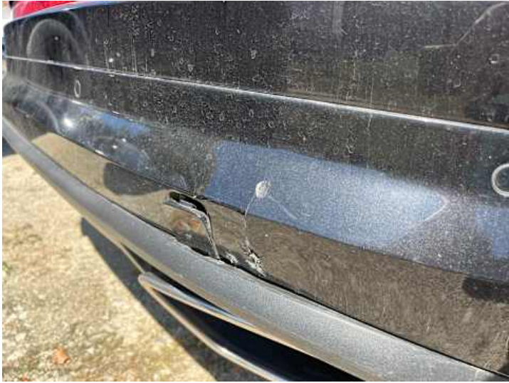
Stoßstange hinten (Riss/Bruch)
