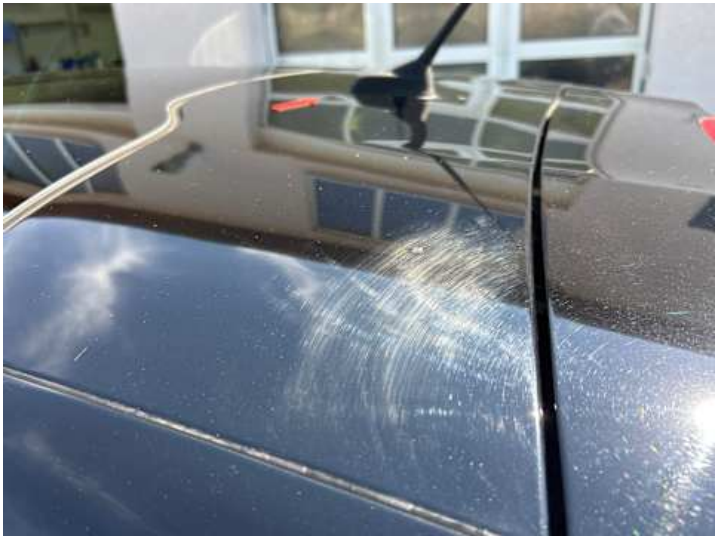
Dach (Delle, Kratzer)
