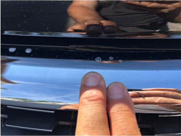
Stoßstange vorne (Steinschlag, Riss/Bruch)
