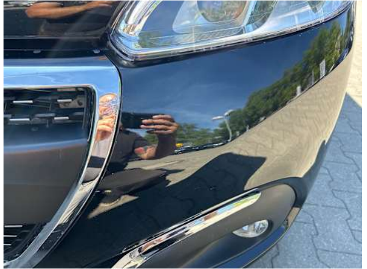
Stoßstange vorne (Steinschlag, Riss/Bruch)
