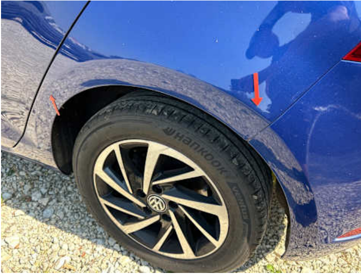
Seitenteil hinten links (Unsachgemäß instand gesetzt, Rost)
