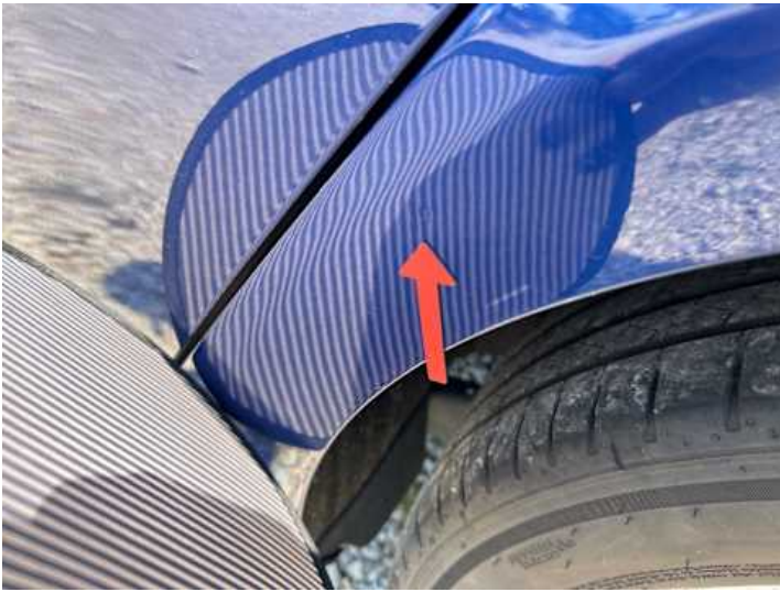
Seitenteil hinten links (Unsachgemäß instand gesetzt, Rost)
