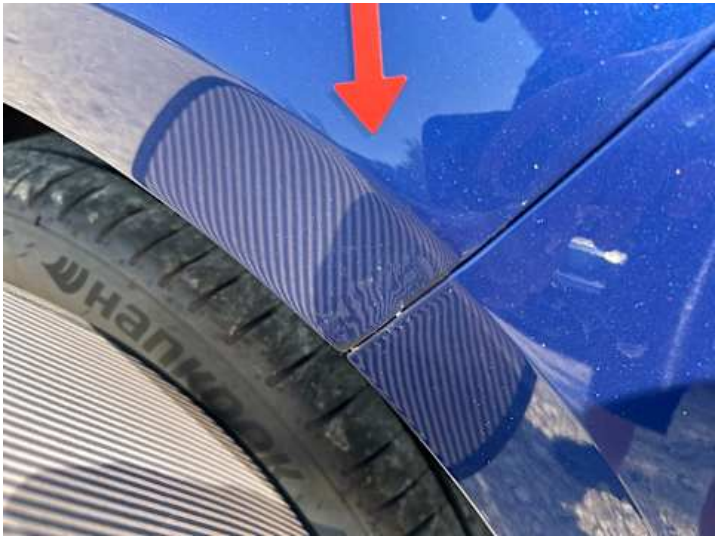
Seitenteil hinten links (Unsachgemäß instand gesetzt, Rost)
