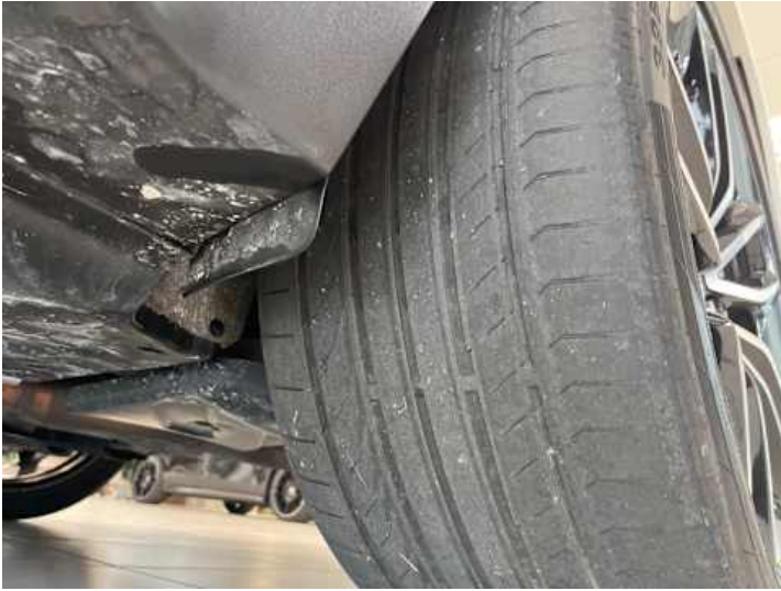
Rad (Ungleichmäßig abgefahren)
