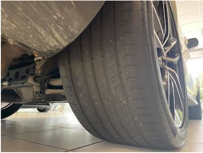
Rad (Ungleichmäßig abgefahren)
