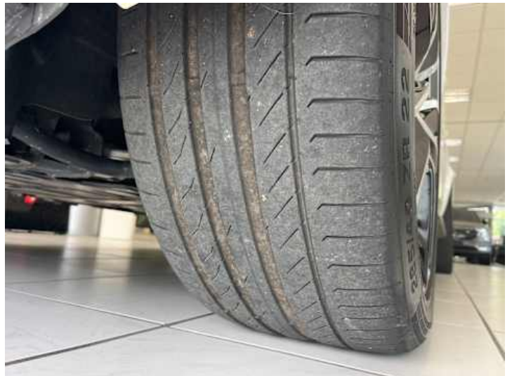
Rad (Ungleichmäßig abgefahren)
