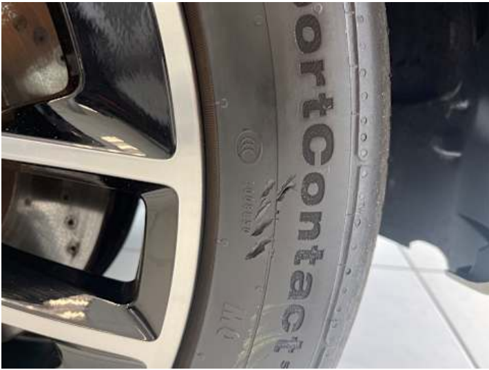
Rad (Riss/Bruch, Ungleichmäßig abgefahren)
