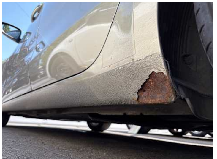
Schweller links (Rost, Verformung)
