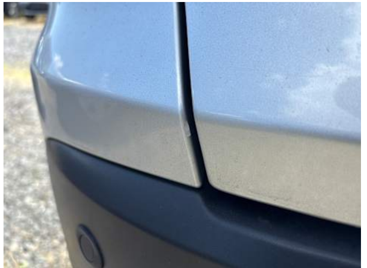
Stoßstange hinten (Lackschaden)
