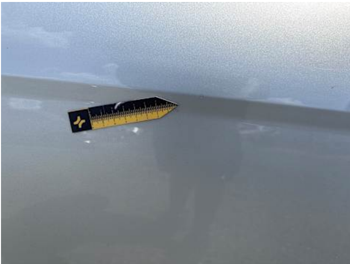
Beifahrertür (Unsachgemäß instand gesetzt)
