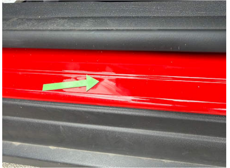
Schweller links (Kratzer)
