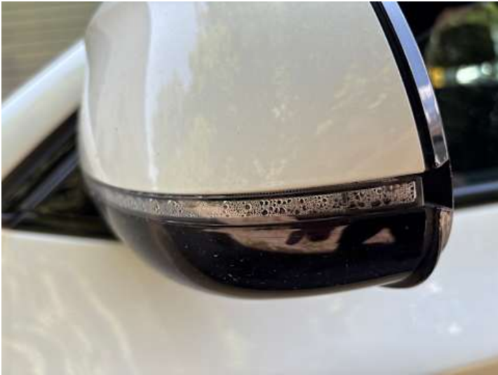
Fahrtür (Anderer Schaden): Wassereintritt
