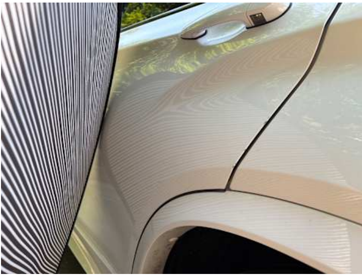
Türe hinten links (Delle)
