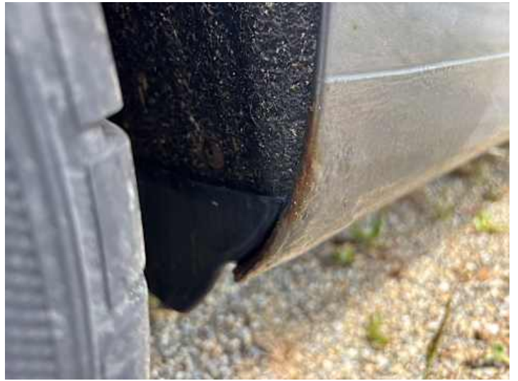
Schweller rechts (Rost)
