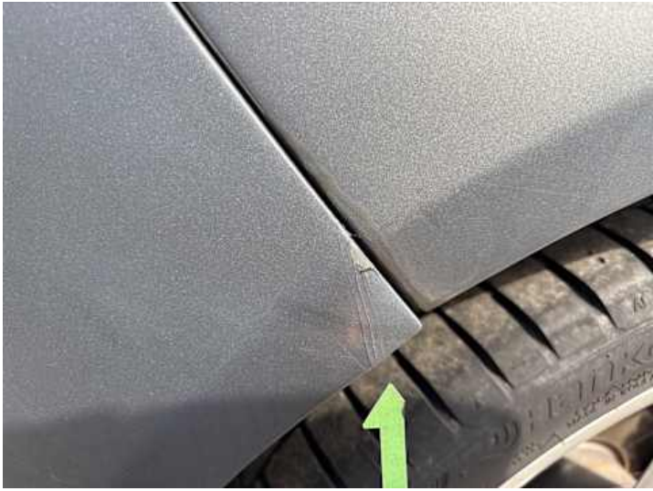
Stoßstange hinten (Lackschaden, Kratzer)
