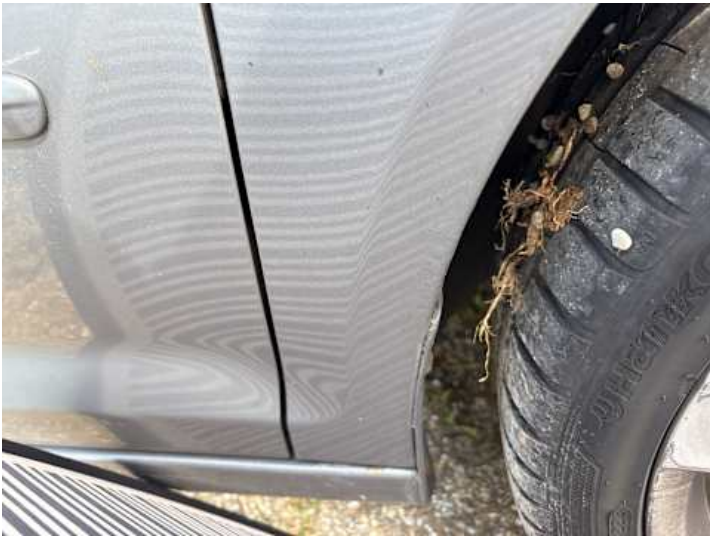
Kotflügel vorne rechts (Rost)
