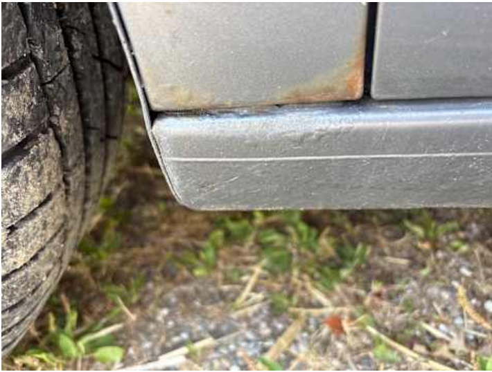
Schweller links (Rost)
