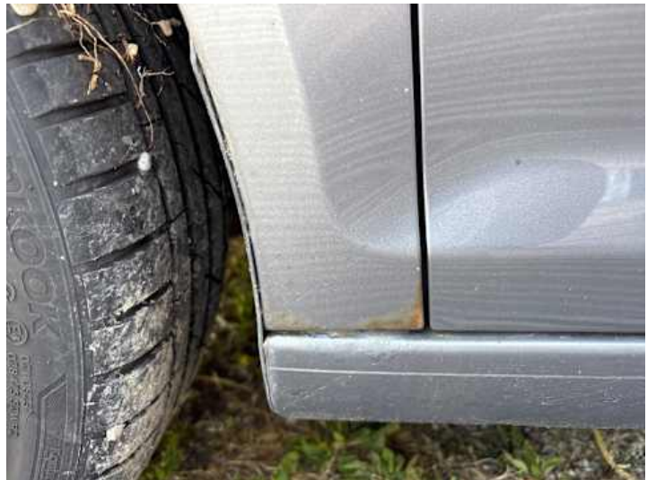
Kotflügel vorne links (Rost, Delle)
