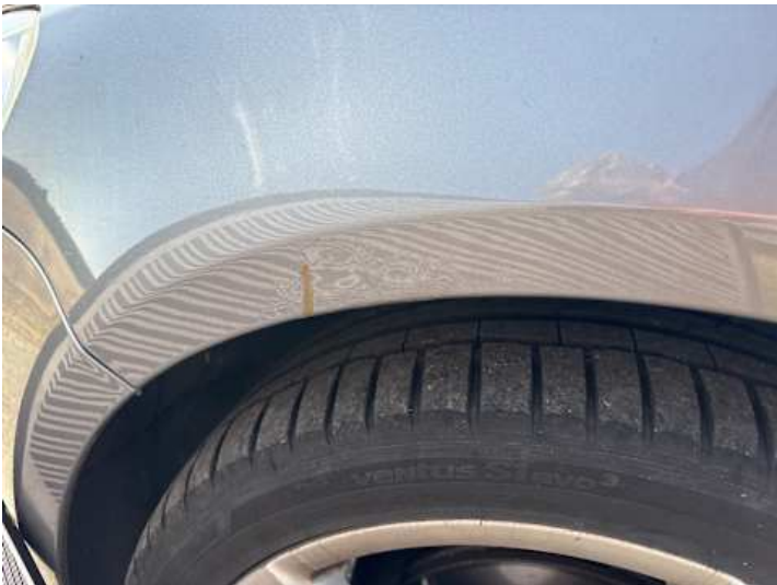
Kotflügel vorne links (Rost, Delle)
