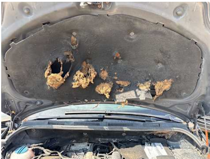
Motorhaube (Anderer Schaden): Dämmmatte beschädigt
