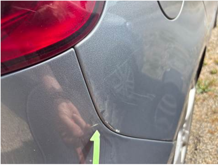
Stoßstange hinten (Lackschaden, Kratzer)
