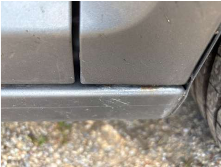
Schweller rechts (Rost)
