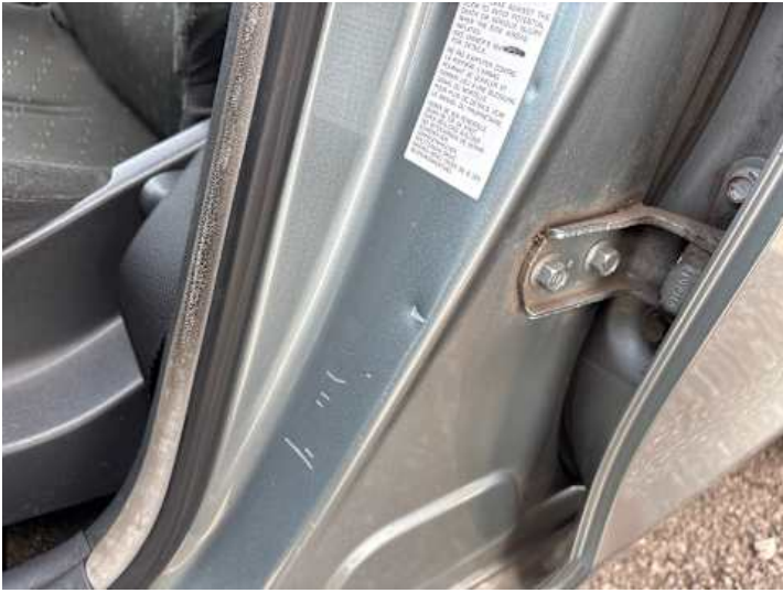
Schweller links (Lackschaden)
