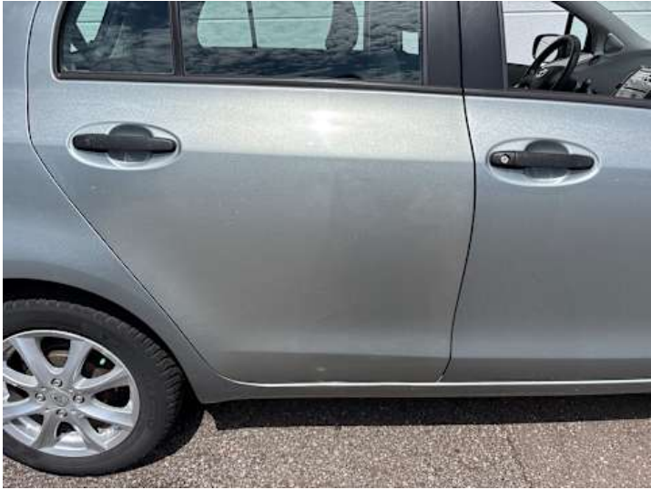
Türe hinten rechts (Anderer Schaden): Farbtonunterschied
