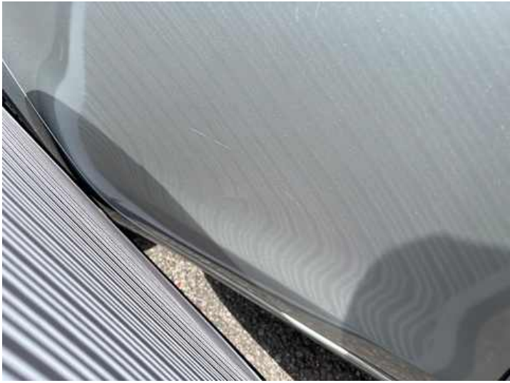
Türe hinten rechts (Verformung)
