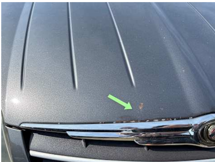
Motorhaube (Steinschlag, Lackschaden, Rost)
