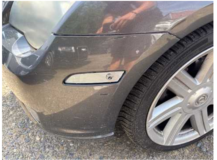
Stoßstange vorne (Kratzer, Lackschaden, Riss/Bruch)
