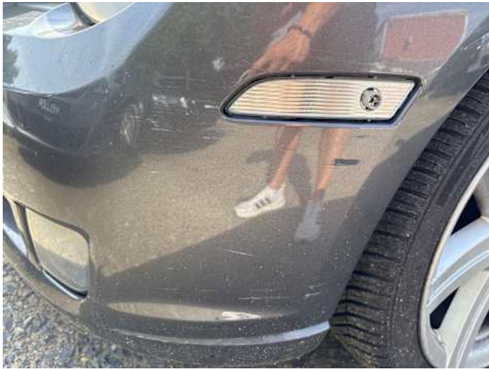
Stoßstange vorne (Kratzer, Lackschaden, Riss/Bruch)
