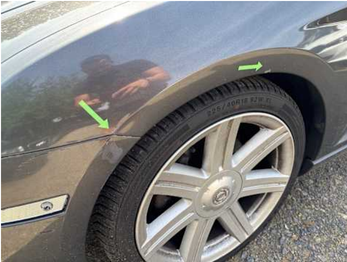
Kotflügel vorne links (Rost, Lackschaden, Delle)
