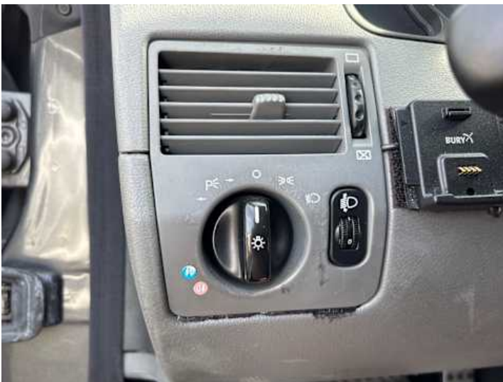
Innenraum (Anderer Schaden): Lichtschalter Geklebt
