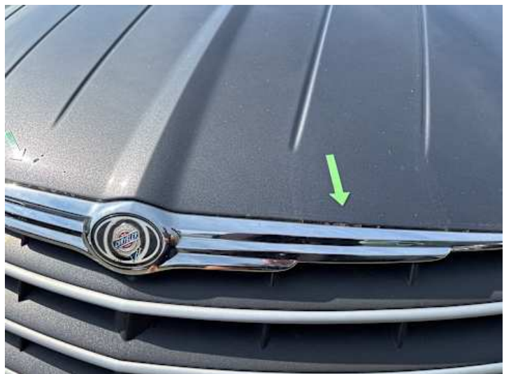
Motorhaube (Steinschlag, Lackschaden, Rost)
