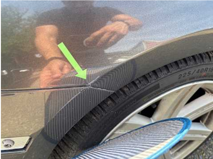
Kotflügel vorne links (Rost, Lackschaden, Delle)
