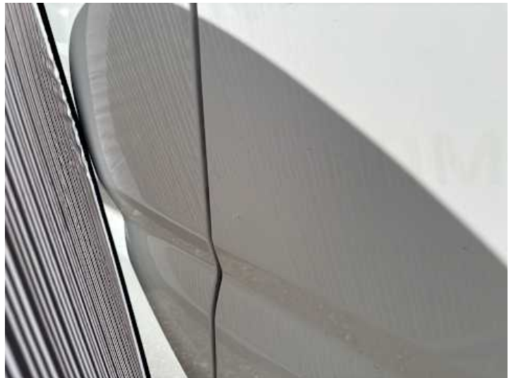
Türe hinten rechts (Delle)
