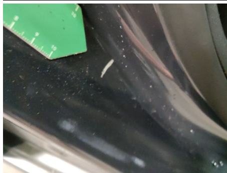
Türeinstieg / Vorne Rechts / Kratzer
