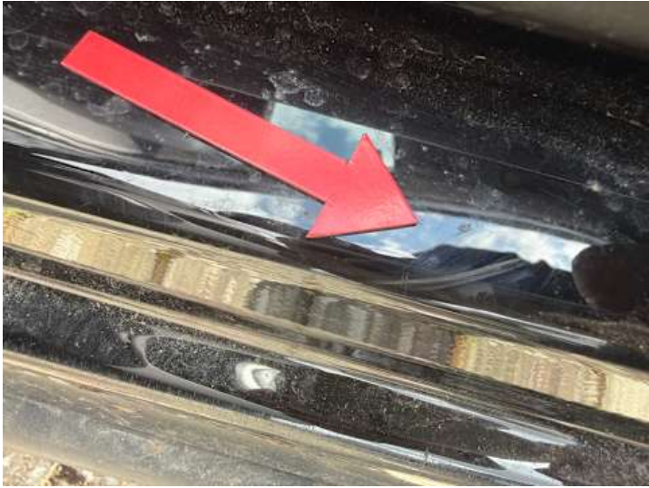
Schweller links (Kratzer, Delle)
