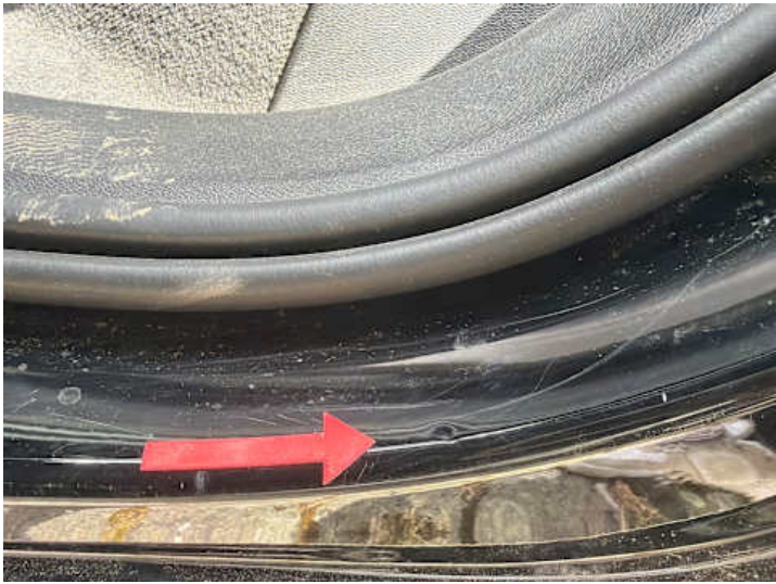
Schweller links (Kratzer, Delle)
