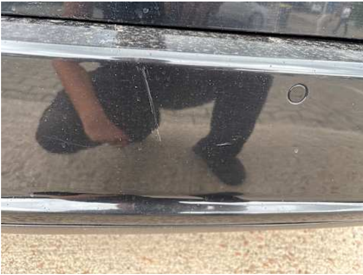
Stoßstange hinten (Lackschaden, Kratzer, Spaltmaße ungenau)
