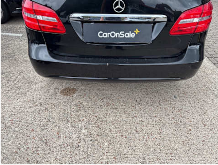
Stoßstange hinten (Lackschaden, Kratzer, Spaltmaße ungenau)
