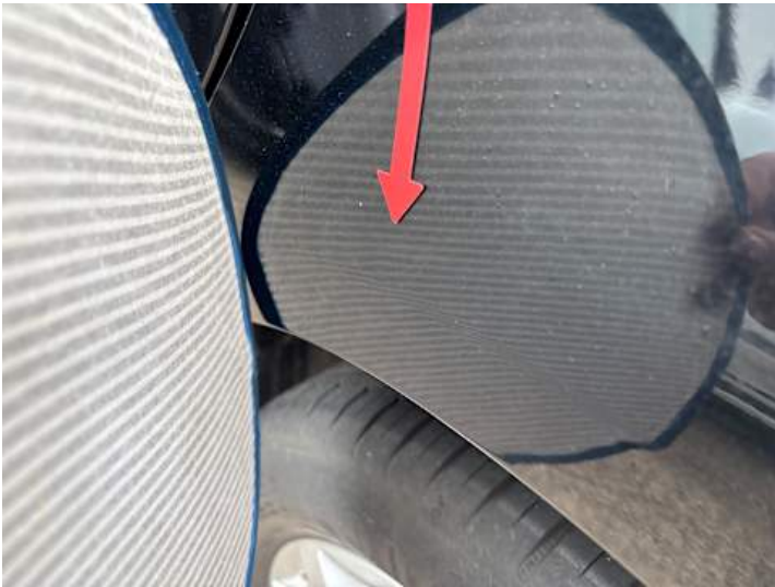
Seitenteil hinten links (Kratzer, Delle)
