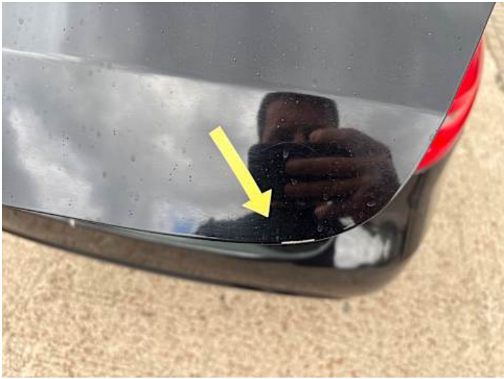
Heckklappe (Lackschaden, Delle)
