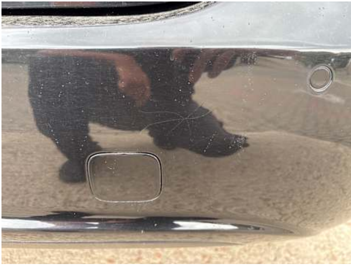
Stoßstange hinten (Lackschaden, Kratzer, Spaltmaße ungenau)
