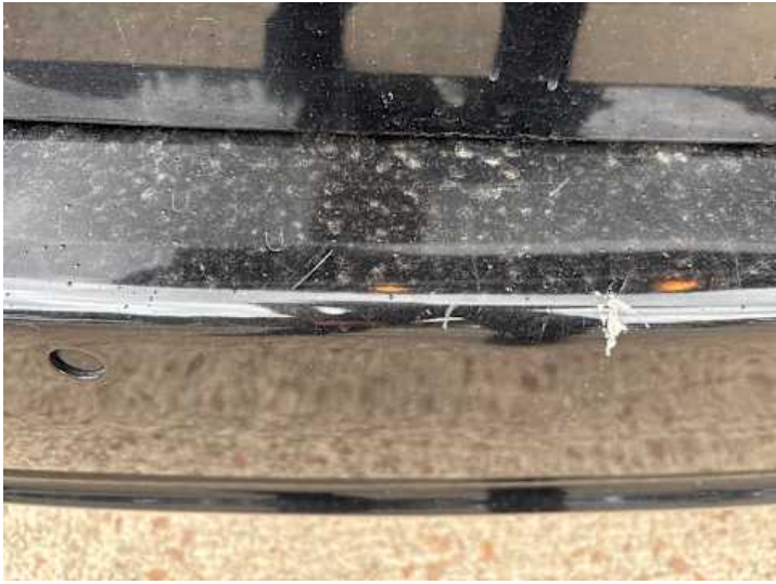
Stoßstange hinten (Lackschaden, Kratzer, Spaltmaße ungenau)
