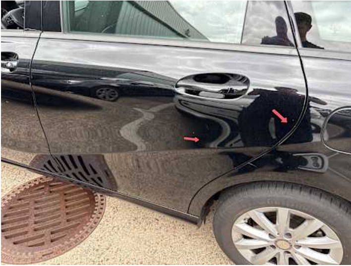
Türe hinten links (Kratzer, Lackschaden)
