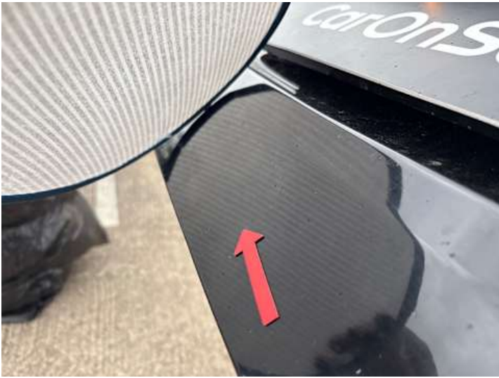
Heckklappe (Lackschaden, Delle)
