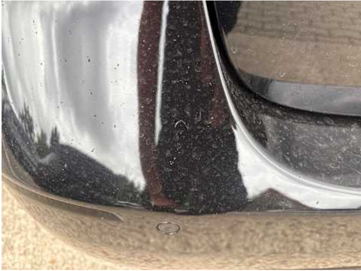
Stoßstange hinten (Lackschaden, Kratzer, Spaltmaße ungenau)
