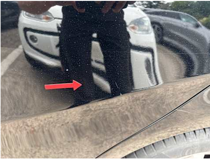
Türe hinten links (Kratzer, Lackschaden)
