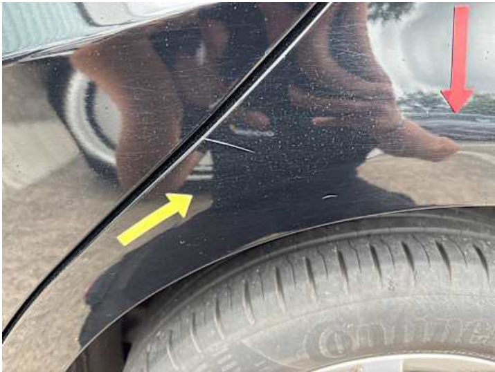
Seitenteil hinten links (Kratzer, Delle)
