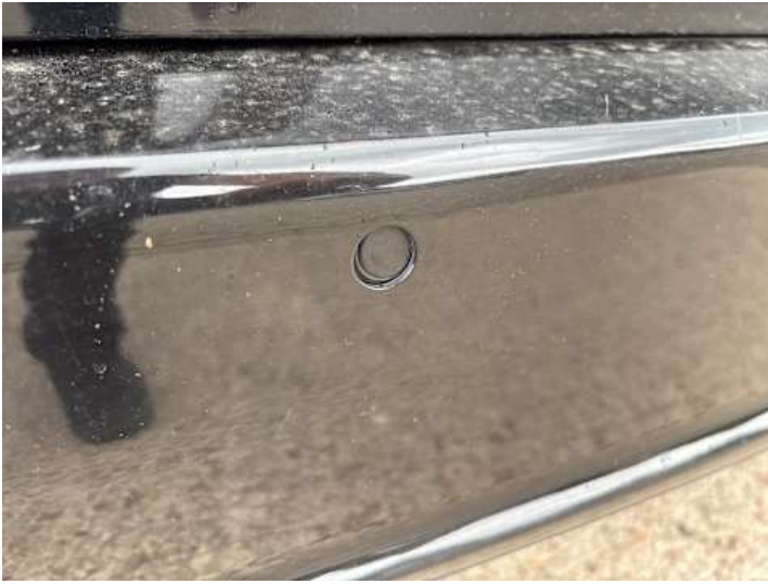
Stoßstange hinten (Lackschaden, Kratzer, Spaltmaße ungenau)
