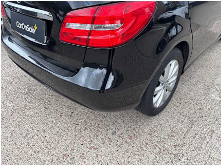
Stoßstange hinten (Lackschaden, Kratzer)
