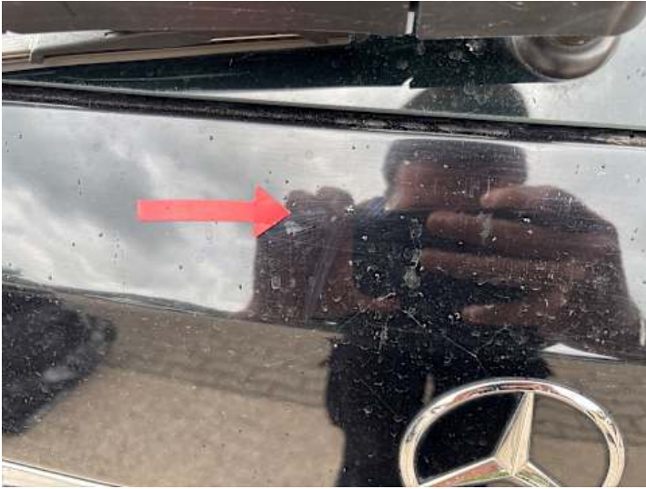
Heckklappe (Lackschaden, Delle)
