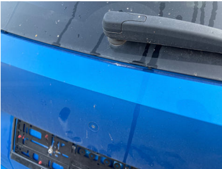
Heckklappe (Anderer Schaden): Emblem fehlt.
