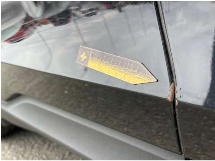
Türe hinten rechts (Rost)
