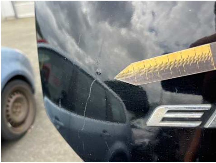
Heckklappe (Rost, Kratzer)
