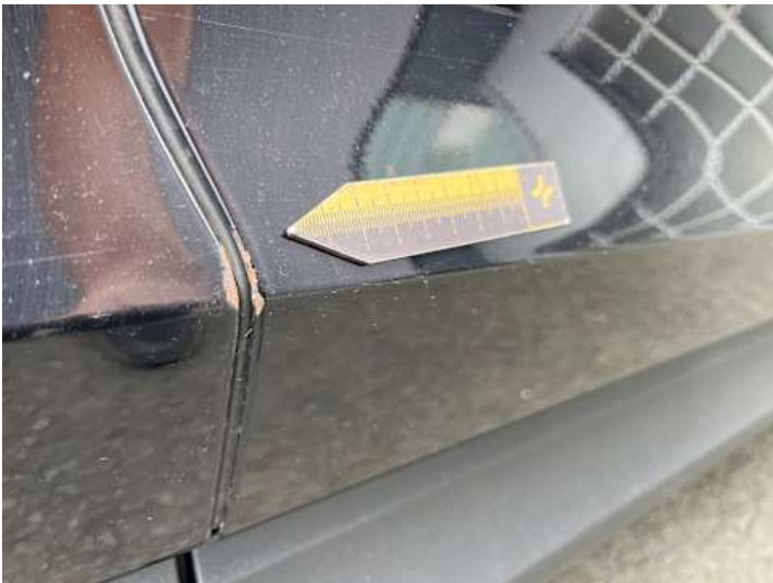
Beifahrtür (Kratzer, Rost)
