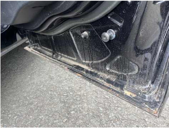
Türe hinten rechts (Rost)
