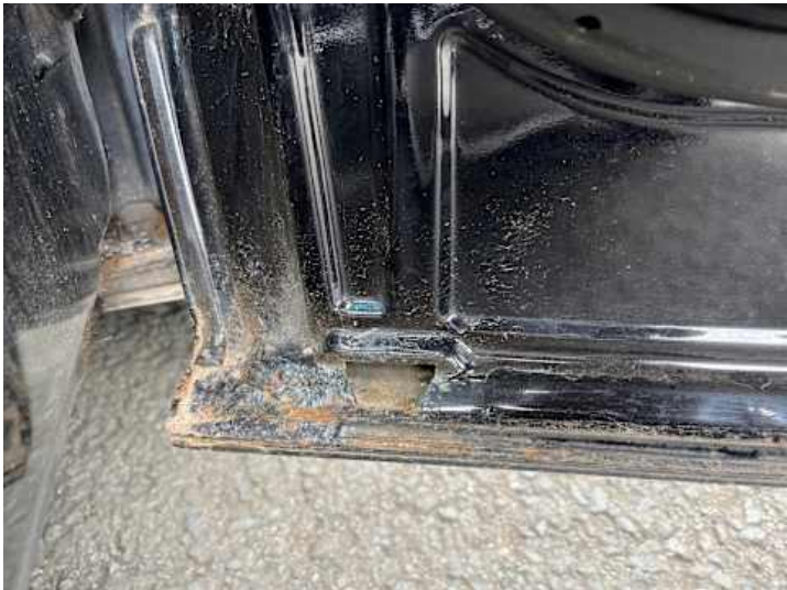
Beifahrtür (Kratzer, Rost)
