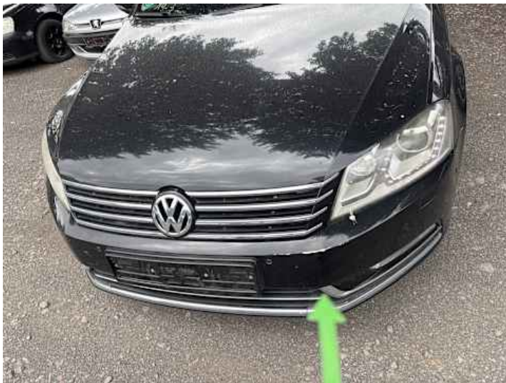
Stoßstange vorne (Lackschaden, Riss/Bruch)
