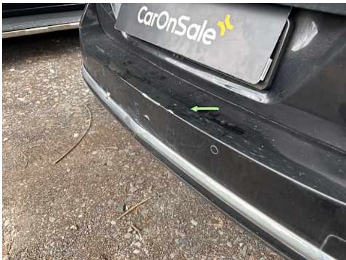
Stoßstange hinten (Verformung, Riss/Bruch, Lackschaden, Spaltmaße ungenau)
