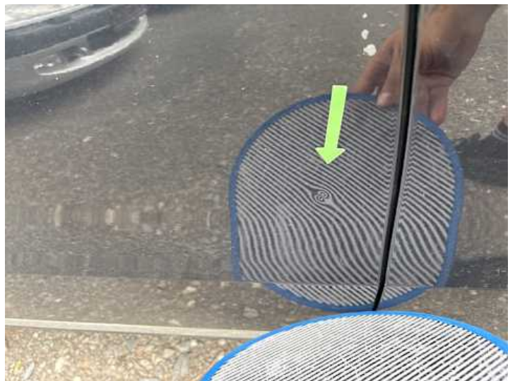
Türe hinten rechts (Delle)
