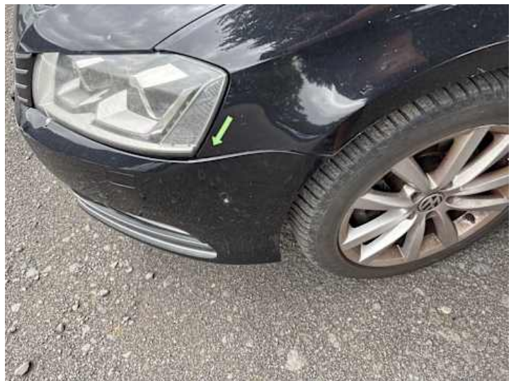
Stoßstange vorne (Spaltmaße ungenau)
