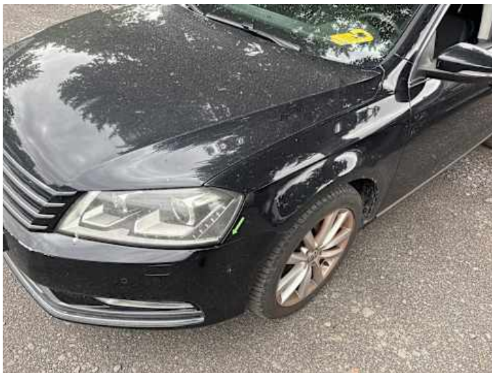
Stoßstange vorne (Spaltmaße ungenau)
