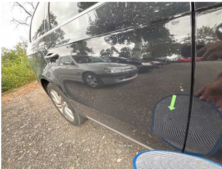
Türe hinten rechts (Delle)
