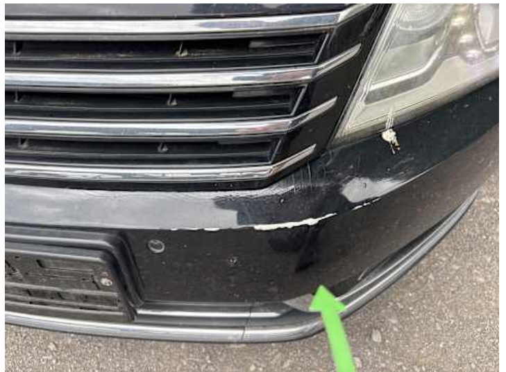
Stoßstange vorne (Lackschaden, Riss/Bruch)
