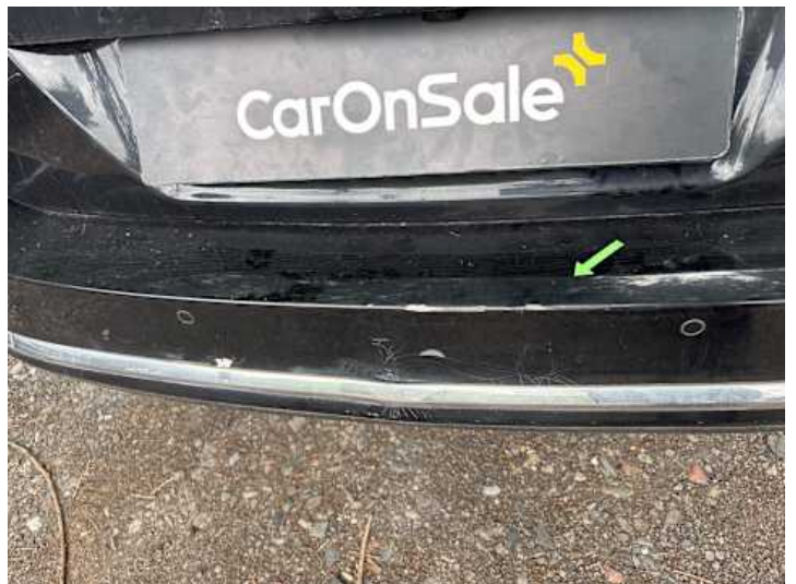
Stoßstange hinten (Verformung, Riss/Bruch, Lackschaden, Spaltmaße ungenau)
