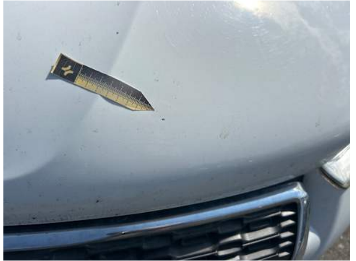
Motorhaube (Steinschlag, Lackschaden)
