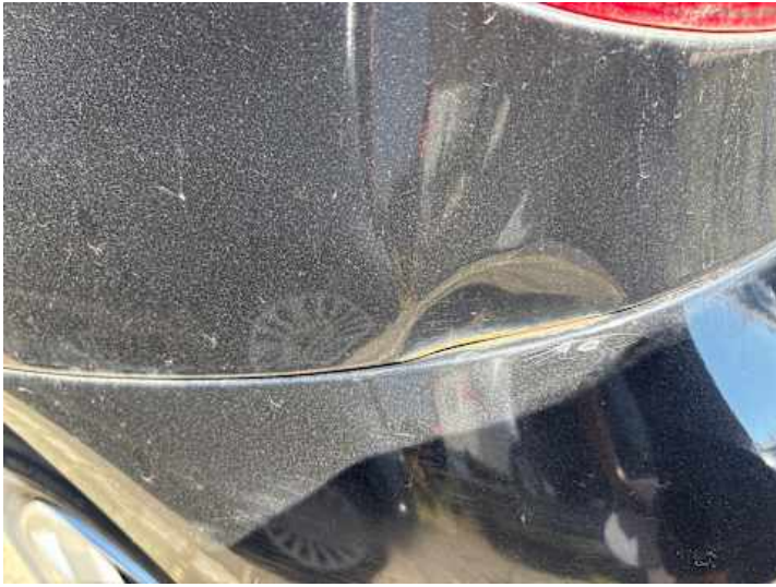
Seitenteil hinten links (Rost, Delle)
