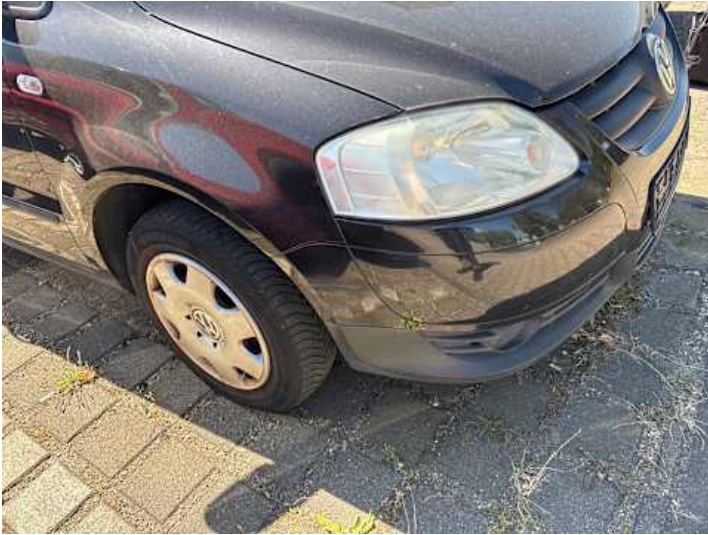
Stoßstange vorne (Kratzer, Spaltmaße ungenau)
