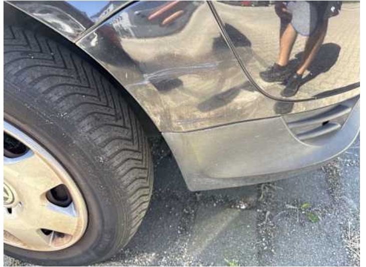
Stoßstange vorne (Kratzer, Spaltmaße ungenau)
