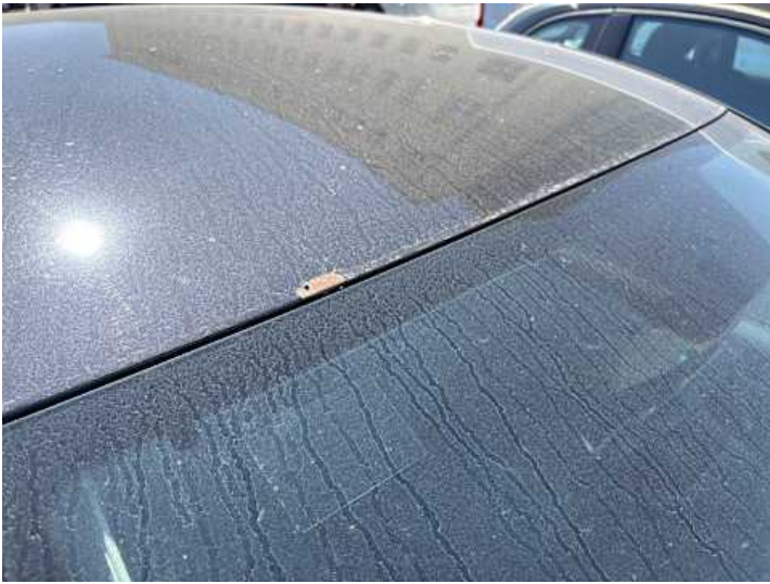
Dach (Rost, Lackschaden)
