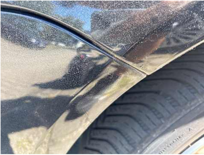
Kotflügel vorne links (Rost, Unsachgemäß instand gesetzt)
