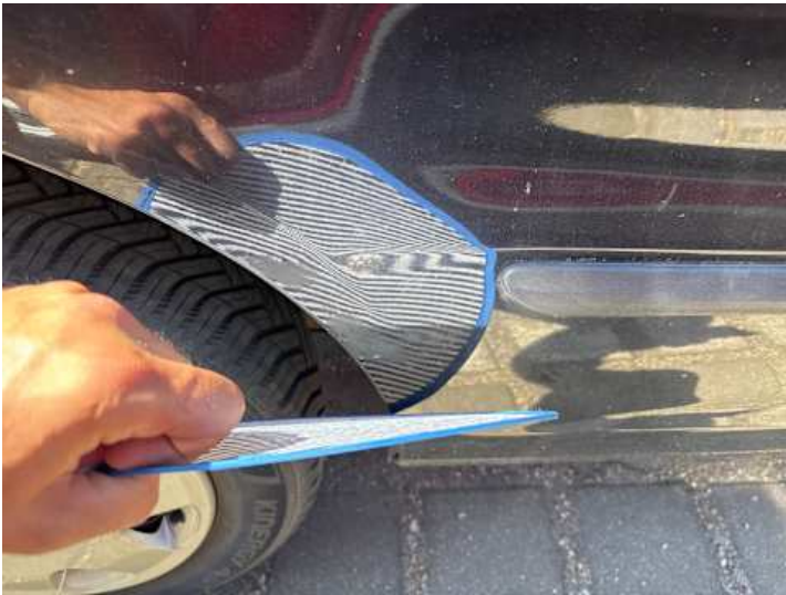
Seitenteil hinten rechts (Kratzer, Delle)
