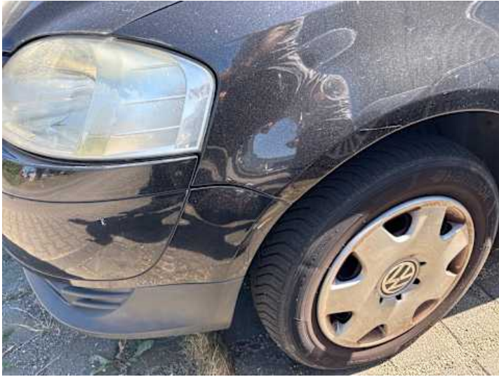
Kotflügel vorne links (Rost, Unsachgemäß instand gesetzt)
