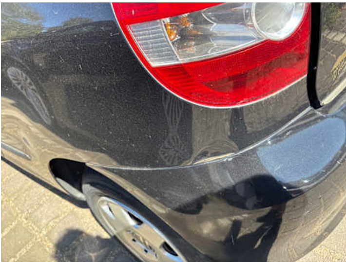
Seitenteil hinten links (Rost, Delle)
