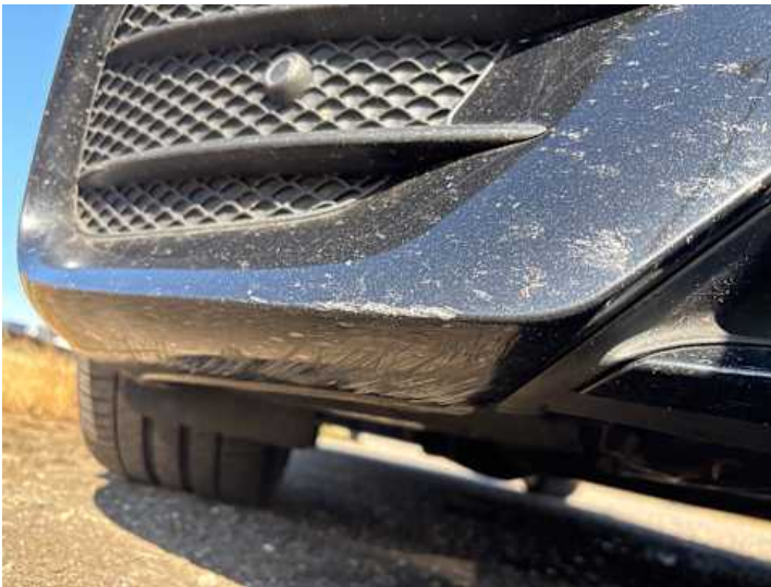
Stoßstange vorne (Kratzer, Lackschaden)
