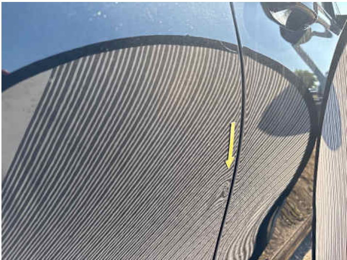
Türe hinten rechts (Delle)
