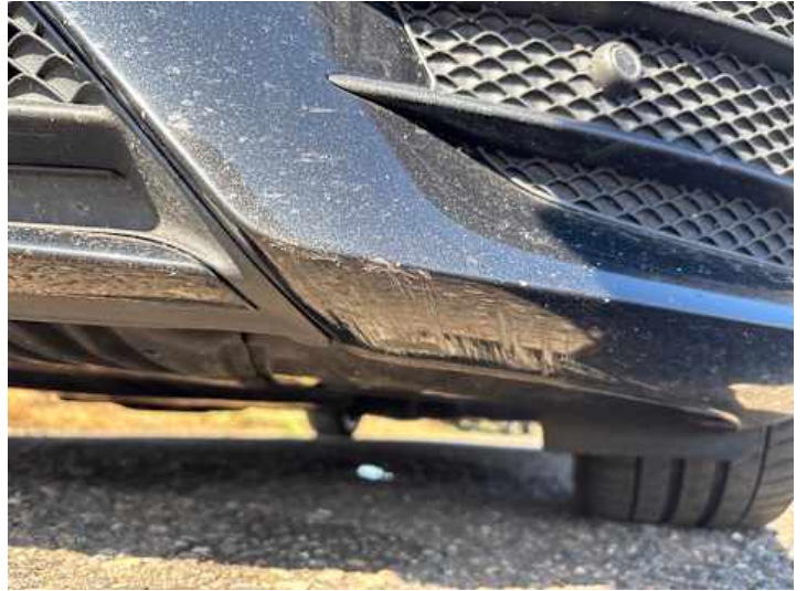
Stoßstange vorne (Kratzer, Lackschaden)
