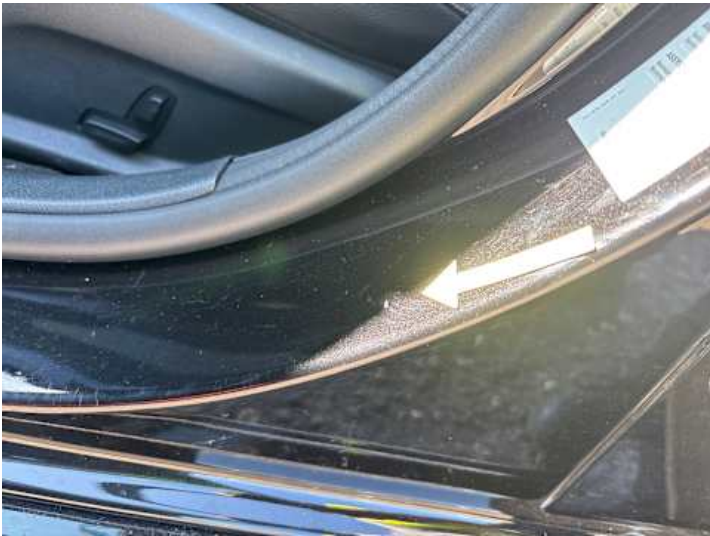
Fahrertür (Delle, Lackschaden)
