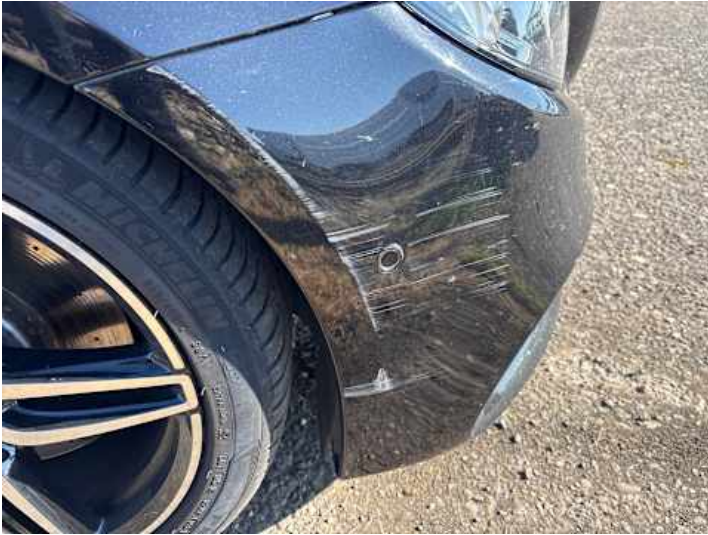
Stoßstange vorne (Kratzer, Lackschaden, Spaltmaße ungenau)
