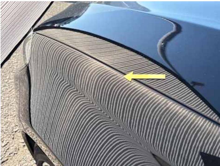
Kotflügel vorne links (Delle)
