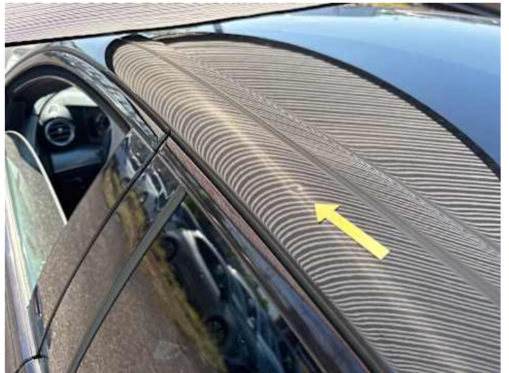
Seitenteil hinten links (Delle)
