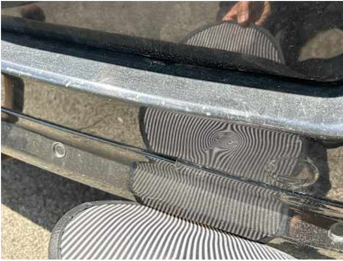
Stoßstange hinten (Kratzer, Verformung)
