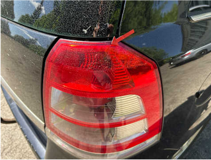
Rücklicht (rechts) (Riss/Bruch)
