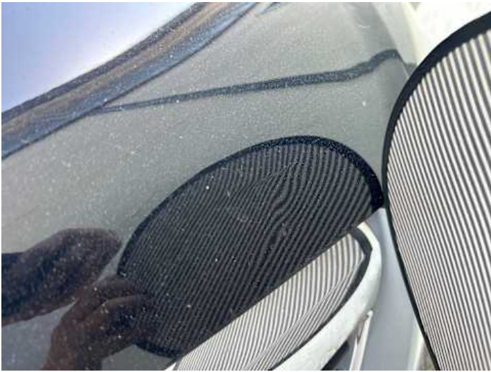
Motorhaube (Kratzer, Lackschaden, Verformung)
