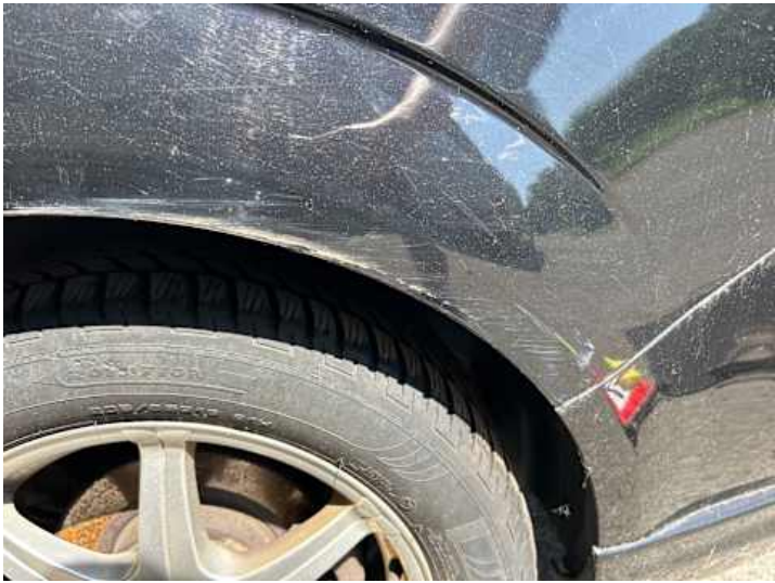
Seitenteil hinten links (Rost, Kratzer)
