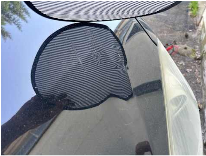
Motorhaube (Kratzer, Lackschaden, Verformung)
