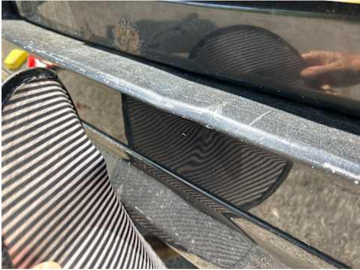
Stoßstange hinten (Kratzer, Verformung)
