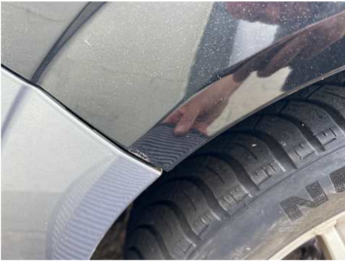
Schweller links (Kratzer, Rost)
