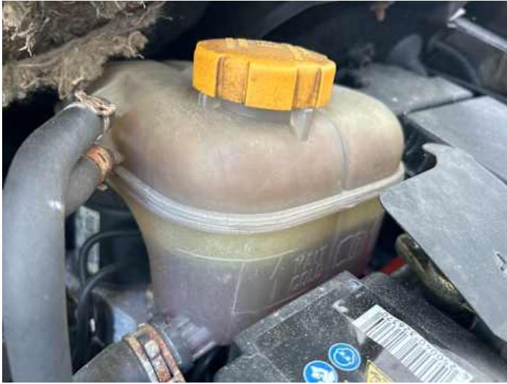
Motorhaube (Anderer Schaden): Verschlammt
