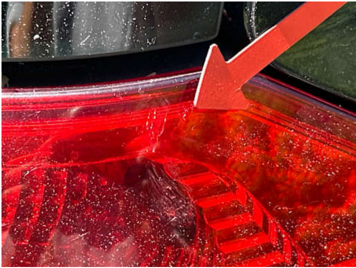
Rücklicht (rechts) (Riss/Bruch)
