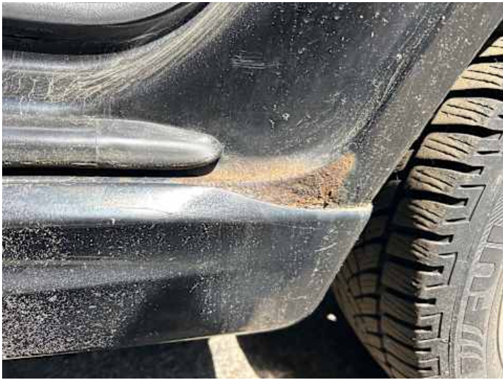
Schweller links (Rost)
