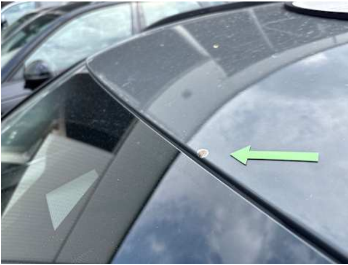
Dach (Rost, Steinschlag)
