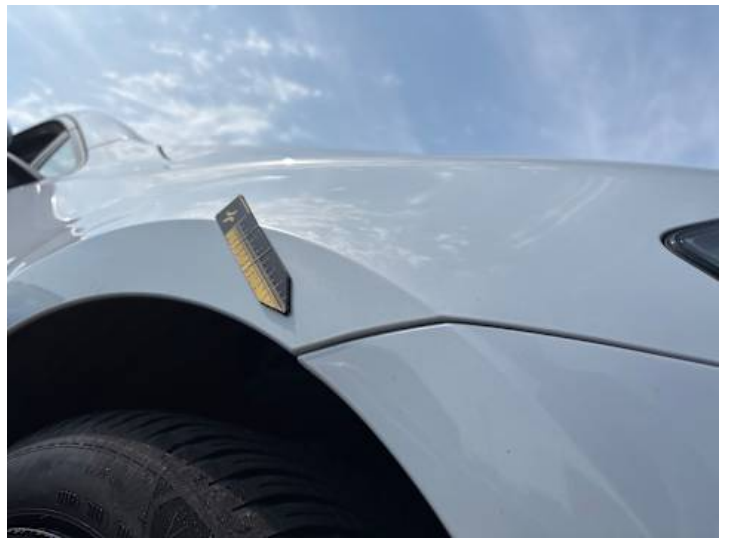
Kotflügel vorne links (Spaltmaße ungenau)
