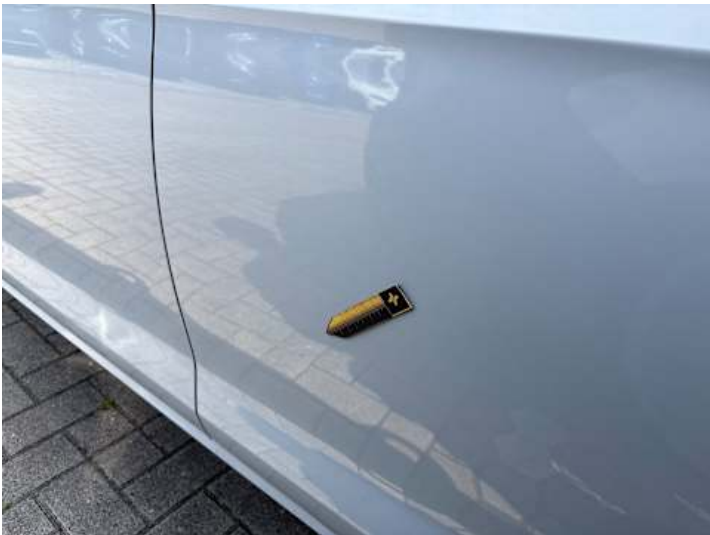
Türe hinten links (Delle)
