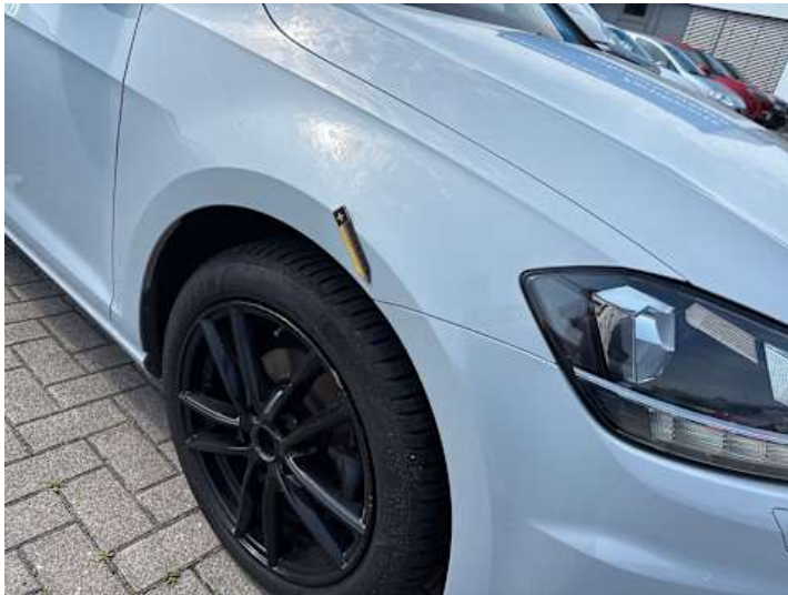
Kotflügel vorne links (Spaltmaße ungenau)
