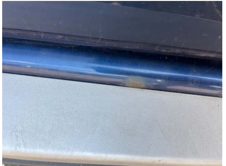
Schweller rechts (Rost)
