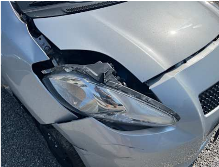
Scheinwerfer (rechts) (Riss/Bruch)
