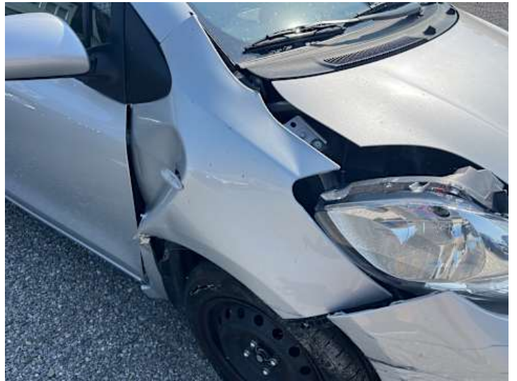
Kotflügel vorne rechts (Verformung, Lackschaden)
