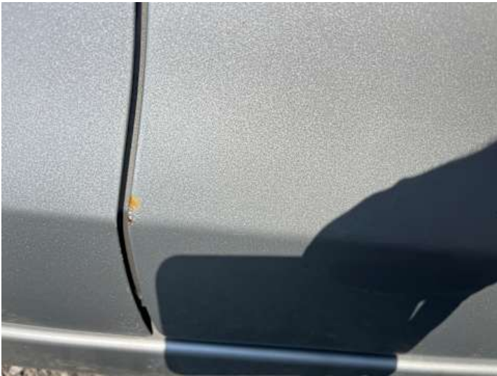
Türe hinten links (Rost, Lackschaden)
