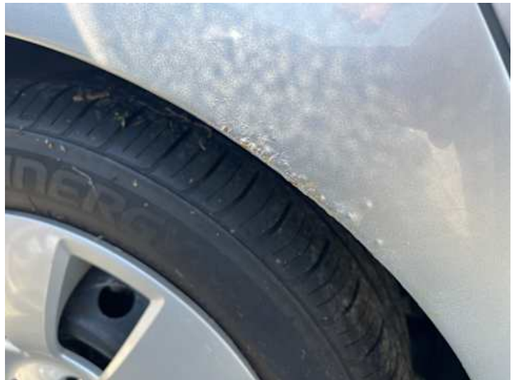
Seitenteil hinten rechts (Rost)
