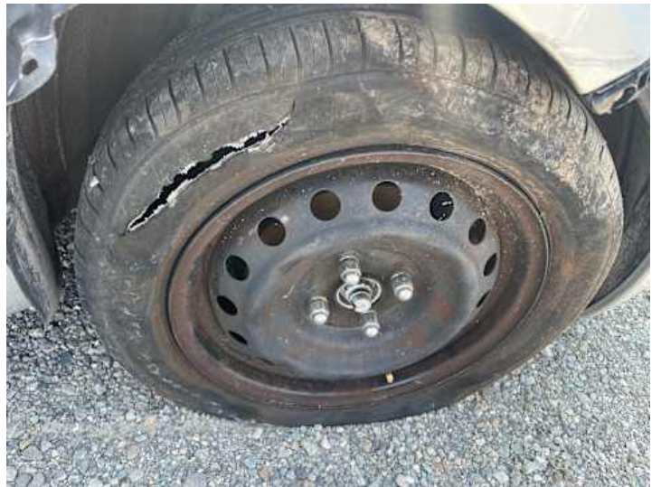
Rad (Ohne Luft, Riss/Bruch)
