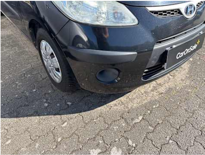
Stoßstange vorne (Kratzer, Verformung)
