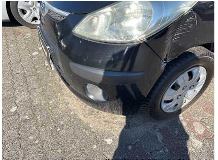
Stoßstange vorne (Kratzer, Verformung)
