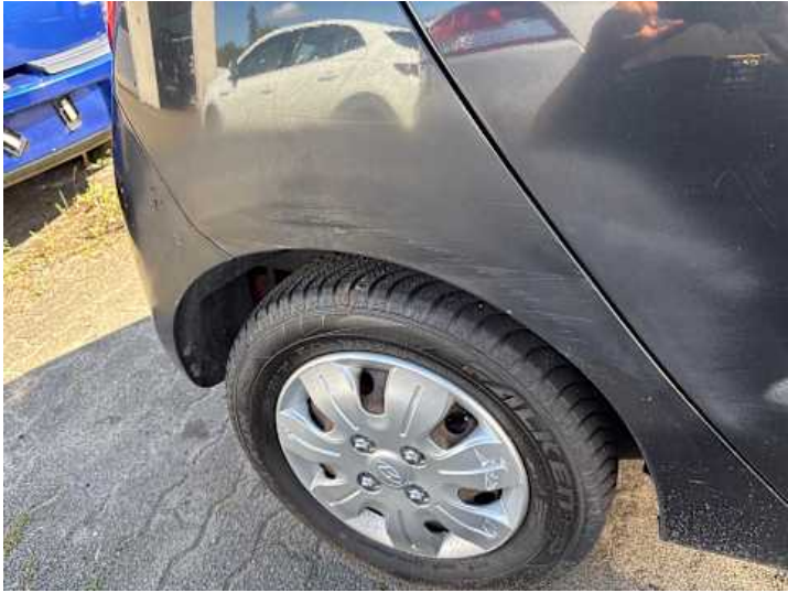
Seitenteil hinten rechts (Delle, Kratzer)
