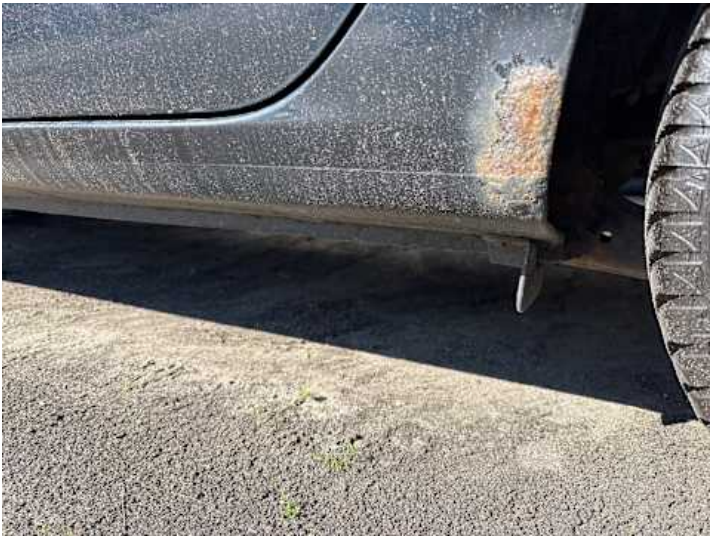
Schweller links (Rost)
