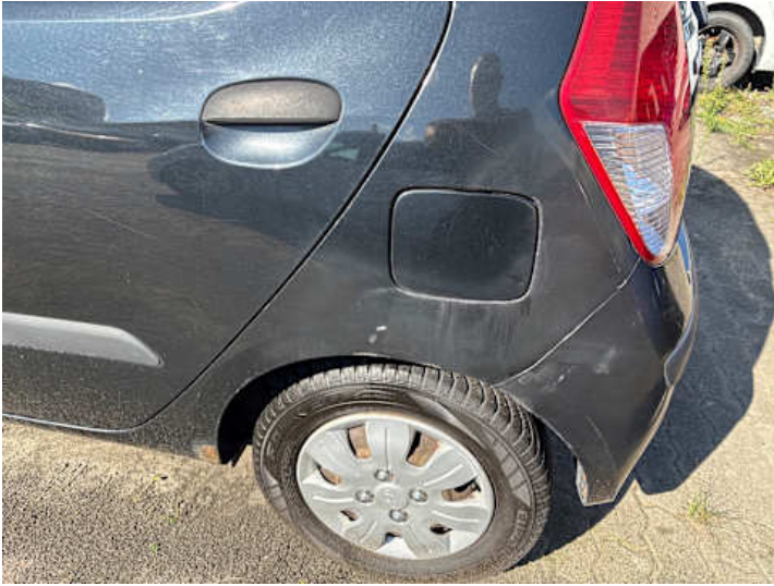
Seitenteil hinten links (Kratzer, Delle, Rost)
