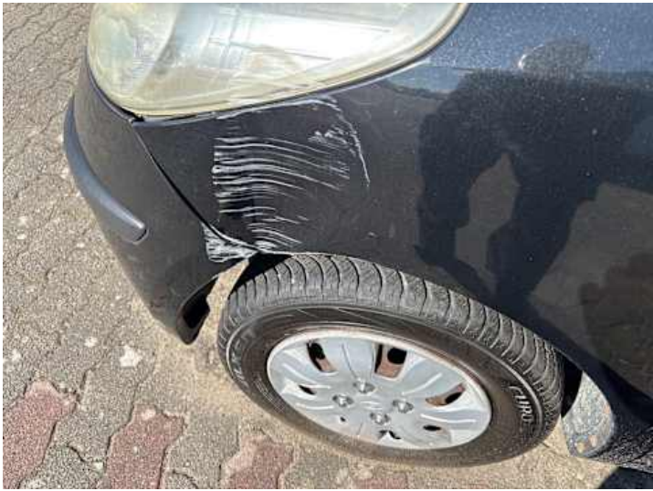
Kotflügel vorne links (Kratzer, Delle)
