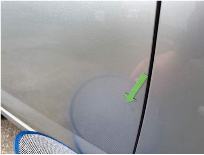
Türe hinten rechts (Kratzer, Delle)
