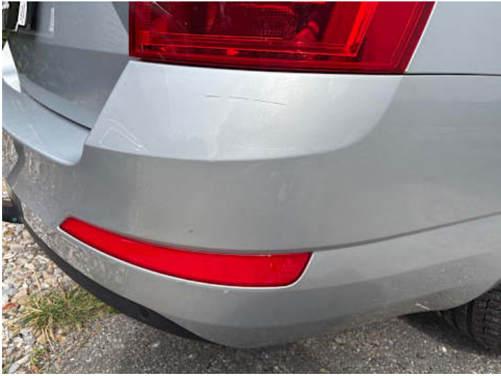
Stoßstange hinten (Kratzer, Delle)
