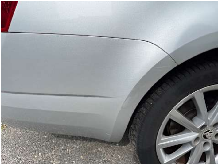
Stoßstange hinten (Kratzer, Delle)
