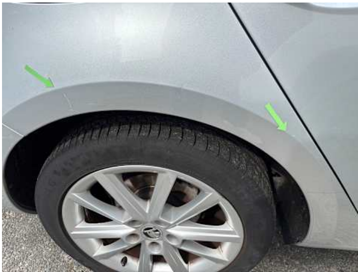
Seitenteil hinten rechts (Kratzer, Delle)
