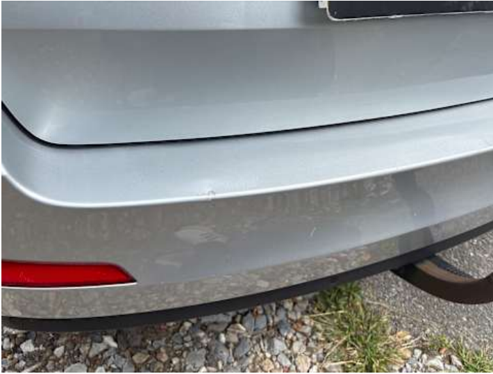
Stoßstange hinten (Kratzer, Delle)
