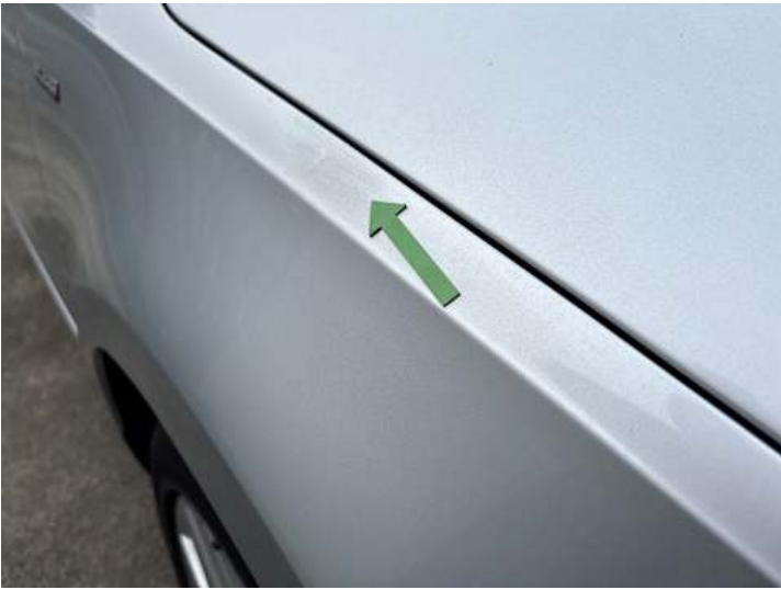
Kotflügel vorne rechts (Kratzer)
