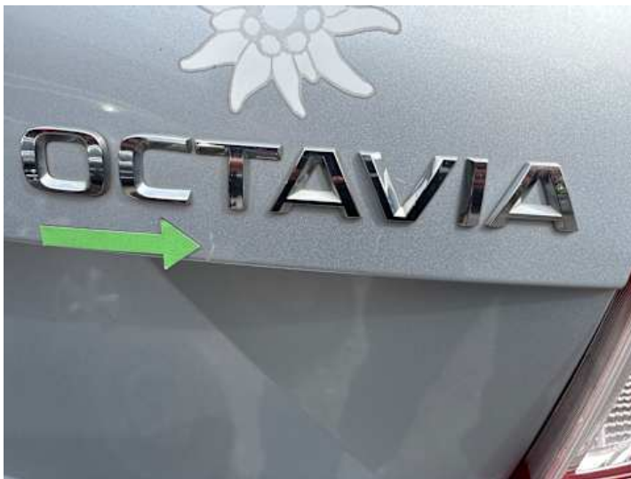
Heckklappe (Kratzer, Delle)
