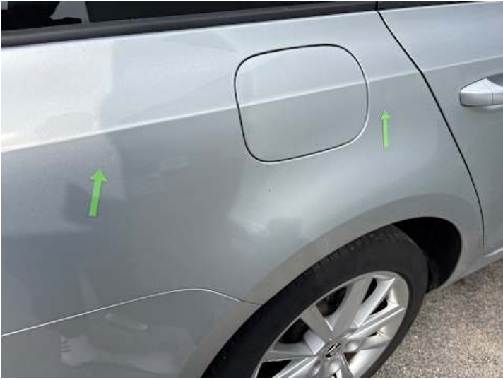
Seitenteil hinten rechts (Kratzer, Delle)
