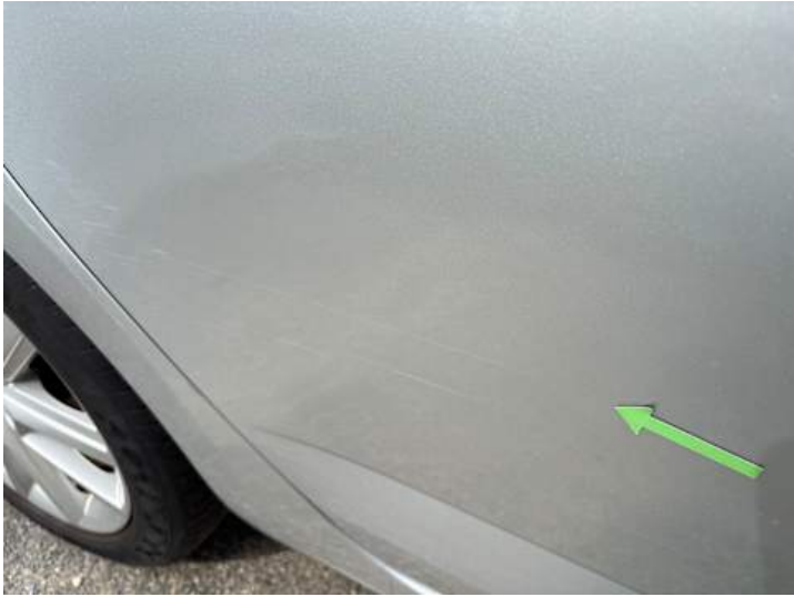
Türe hinten rechts (Kratzer, Delle)
