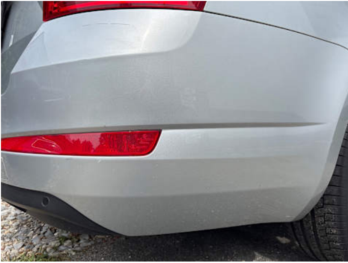
Stoßstange hinten (Kratzer, Delle)
