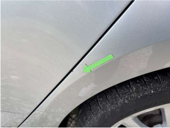
Seitenteil hinten links (Kratzer, Rost)
