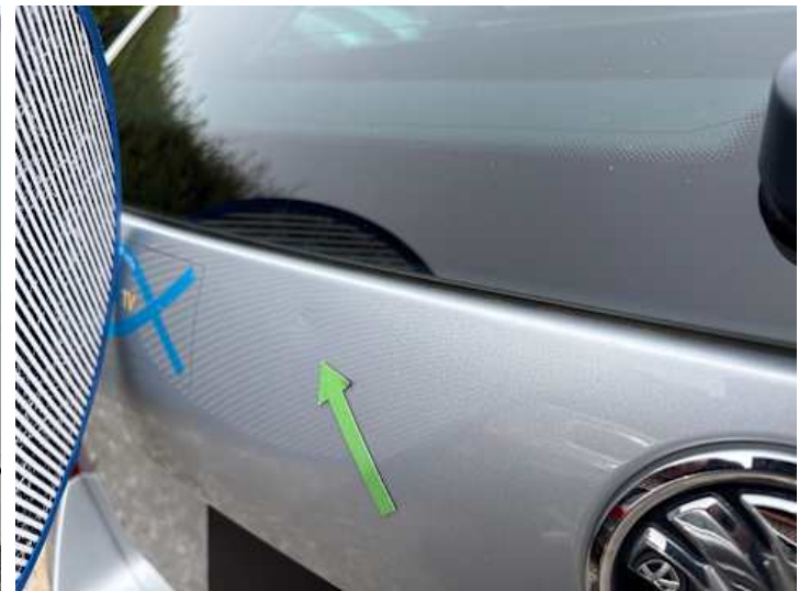
Heckklappe (Kratzer, Delle)
