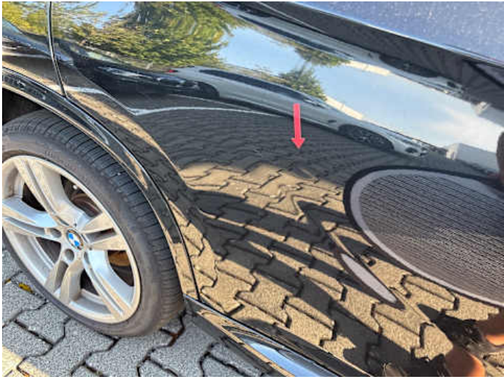
Türe hinten rechts (Delle)
