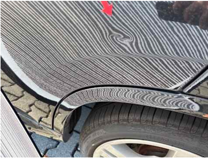
Türe hinten links (Delle)
