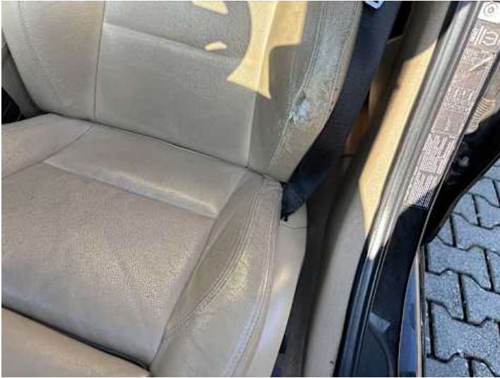
Innenraum (Verschleiß, Riss/Bruch)
