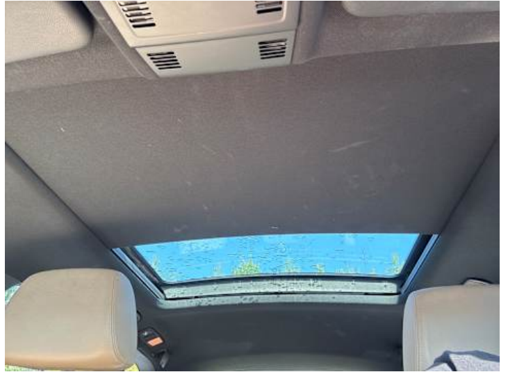
Innenraum (Diverse Schäden, Riss/Bruch, Anderer Schaden): Schiebedach/Verdunkelung defekt
