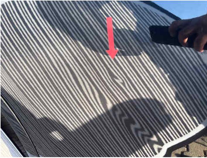
Türe hinten rechts (Delle)
