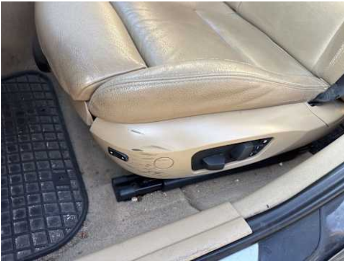
Innenraum (Verschleiß, Diverse Schäden, Verschmutzung)
