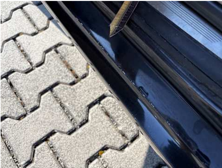
Schweller links (Lackschaden)
